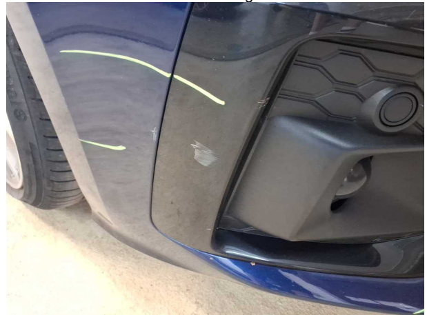
Beschädigung #11: Stossfänger vorn: Lufteinlassgitter - verkratzt / verschürft - erneuern
