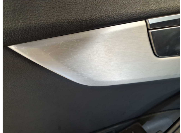
Beschädigung #3: Tür vorn links: Zierleiste oben - verkratzt / verschürft - Wertminderung
