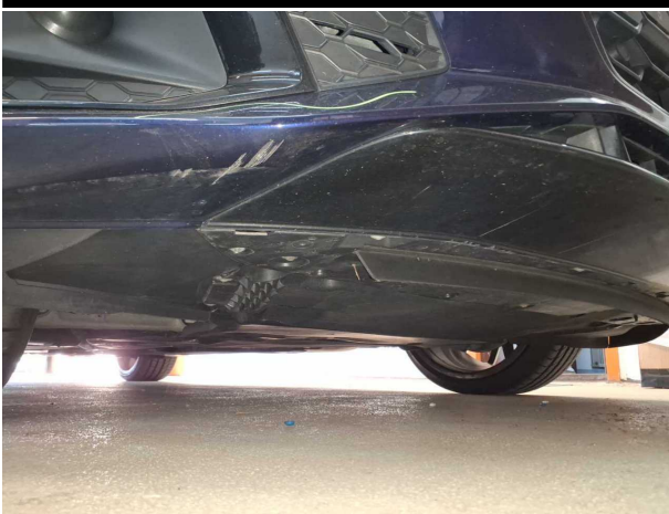
Beschädigung #8: Stossfänger vorn: Stossfänger vorn - verkratzt / verschürft - Wertminderung
