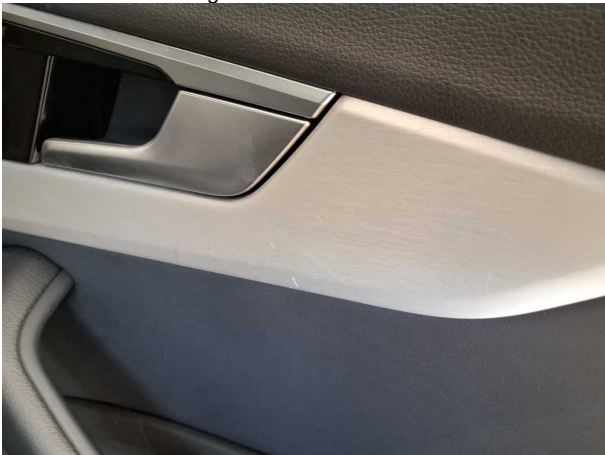
Beschädigung #4: Tür hinten rechts: Zierleiste oben - verkratzt / verschürft - Wertminderung
