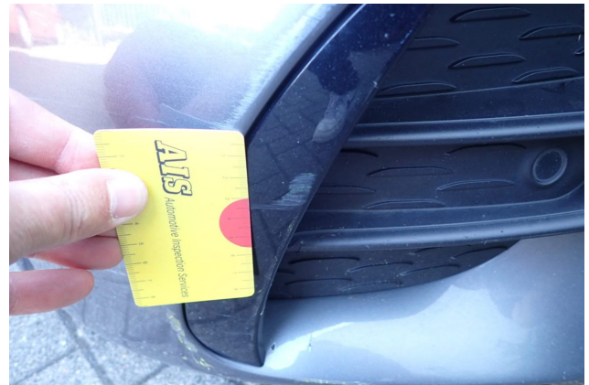
Beschädigung 2: Stossfänger vorn: Stossfänger vorn rechts (sierlijst) - verkratzt / verschürft - erneuern
