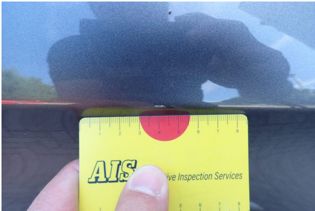
Gebrauchsspur 4: Kotflügel rechts: Kotflügel rechts - Kratzer - kein Abzug
