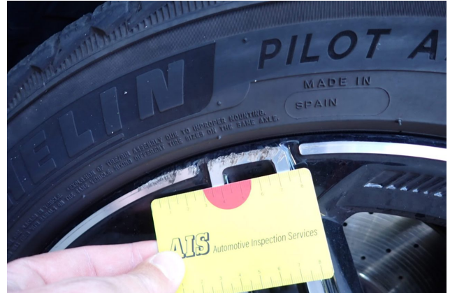
Beschädigung 4: Rad/Reifen: Leichtmetallfelge vorn links - verkratzt / verschürft - instandsetzen und lackieren
