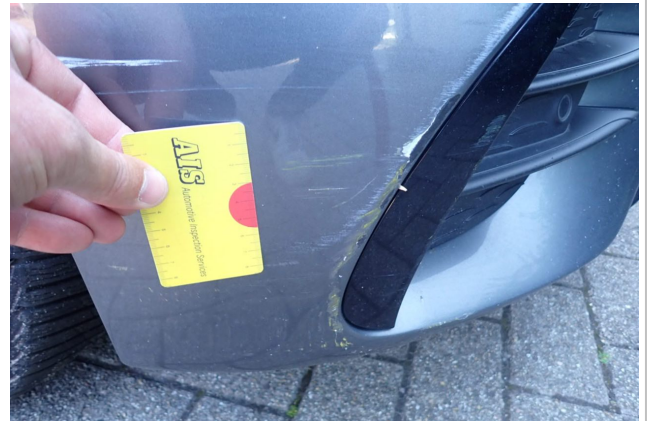
Beschädigung 6: Stossfänger vorn: Stossfänger vorn - verkratzt / verschürft - instandsetzen und lackieren
