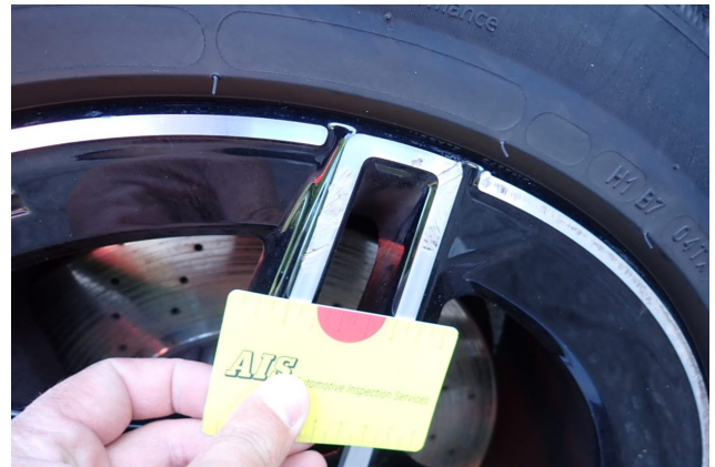
Beschädigung 5: Rad/Reifen: Leichtmetallfelge vorn rechts - verkratzt / verschürft - instandsetzen und lackieren
