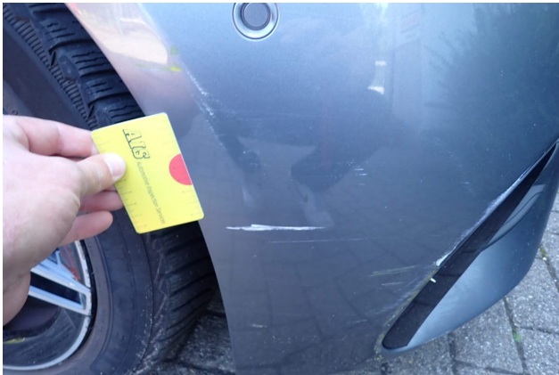
Beschädigung 6: Stossfänger vorn: Stossfänger vorn - verkratzt / verschürft - instandsetzen und lackieren
