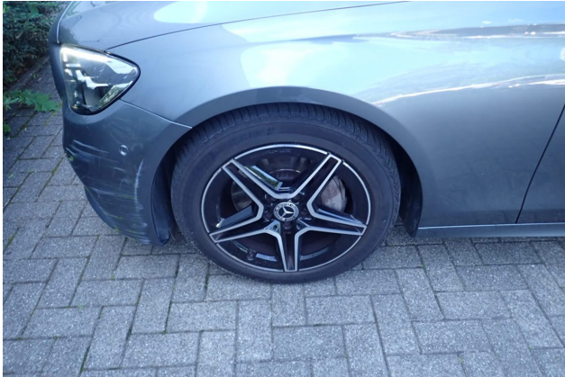
Beschädigung 4: Rad/Reifen: Leichtmetallfelge vorn links - verkratzt / verschürft - instandsetzen und lackieren
