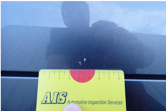
Gebrauchsspur 2: Motor: Motorabdeckung - Steinschlag - kein Abzug
