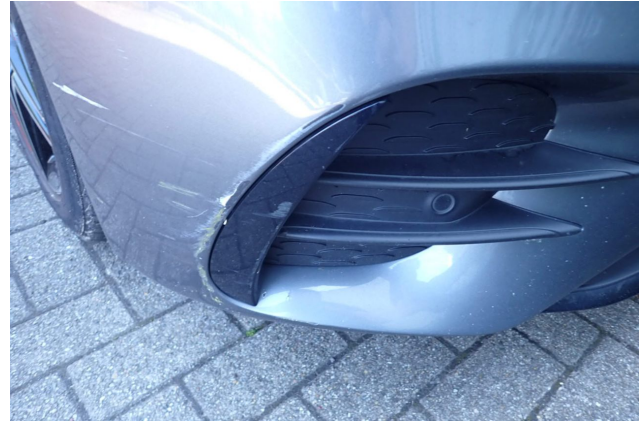
Beschädigung 1: Stossfänger vorn: Stossfänger vorn links (sierlijst) - fehlt - erneuern
