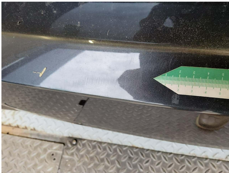
Bild 20 : Stoßfänger hinten zerkratzt
