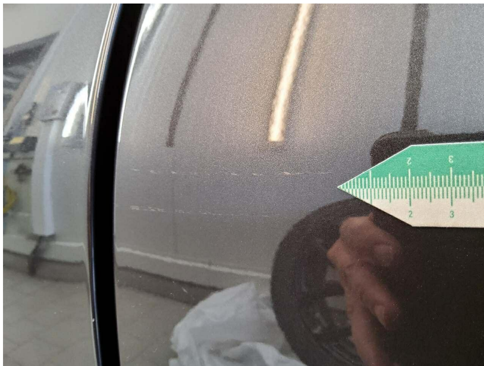
Bild 15 : Tür hinten links zerkratzt
