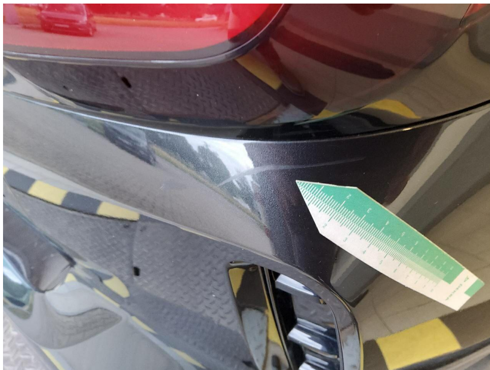
Bild 19 : Stoßfänger hinten zerkratzt
