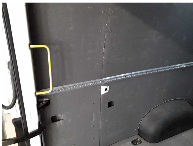
Damage 4: Interior: Interior (Laderaumverkleidungen) - Broken / torn - Loss in value
