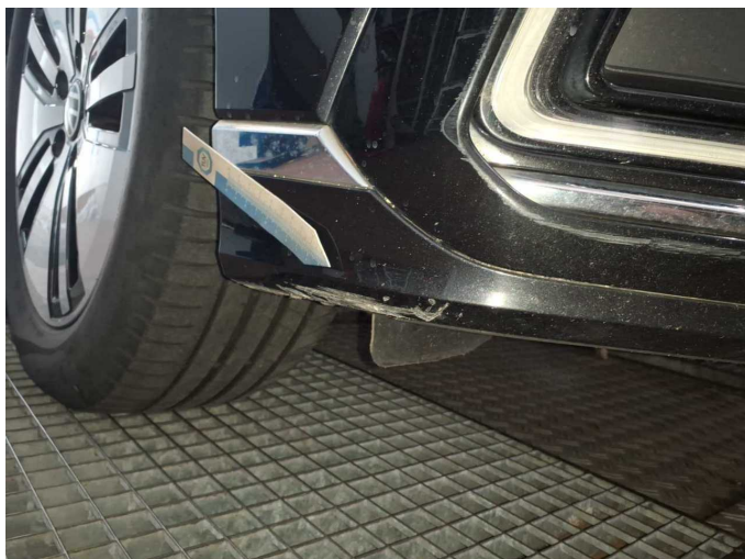
Damage 7: Front bumper: Front bumper (Mit Blende L und Spoiler) - Scratch(es) - Paint
