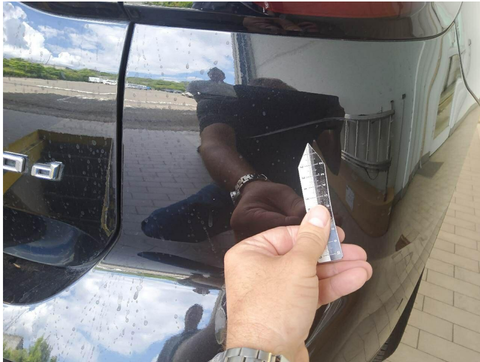
Bild 17 : Stoßfänger hinten verschrammt/verformt
