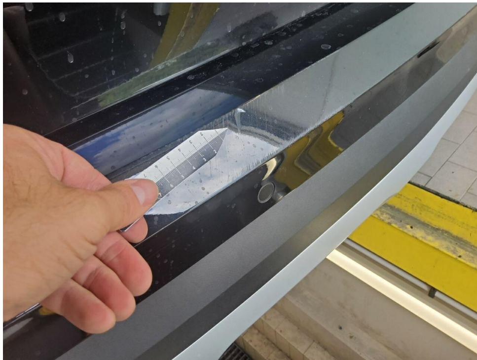
Bild 18 : Stoßfänger hinten verschrammt/verformt
