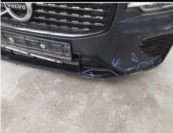
Beschädigung #11: Stossfänger vorn: Lufteinlassgitter (Mitte) - verformt - erneuern
