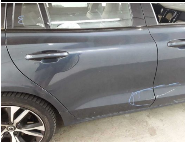
Beschädigung #14: Tür hinten rechts: Tür - verkratzt / verschürft - instandsetzen und lackieren
