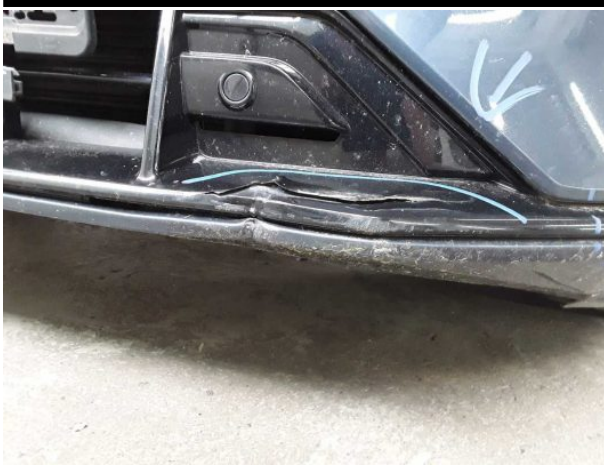
Beschädigung #18: Stossfänger vorn: Stossfänger vorn - verformt - erneuern
