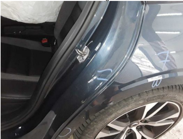
Beschädigung #9: Seitenwand links: Einstieg - verkratzt / verschürft - Smart Repair
