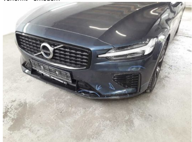
Beschädigung #18: Stossfänger vorn: Stossfänger vorn - verformt - erneuern
