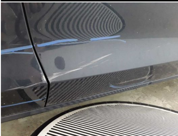
Beschädigung #19: Tür vorn rechts: Tür - verformt - erneuern
