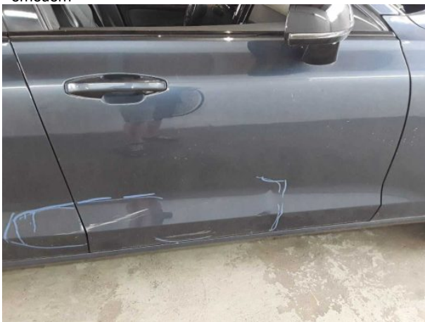
Beschädigung #19: Tür vorn rechts: Tür - verformt - erneuern
