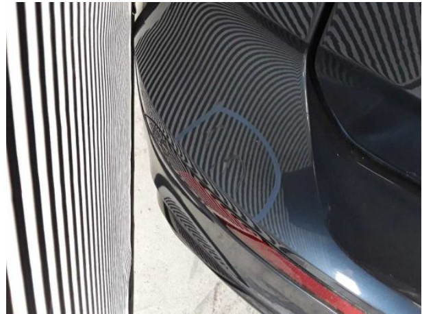
Beschädigung #17: Stossfänger hinten: Stossfänger hinten - verformt - erneuern
