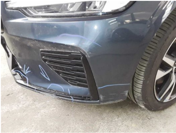
Beschädigung #18: Stossfänger vorn: Stossfänger vorn - verformt - erneuern
