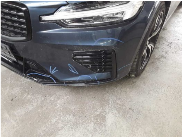
Beschädigung #3: Stossfänger vorn: Lufteinlassgitter (Vorne links) - verkratzt / verschürft - erneuern
