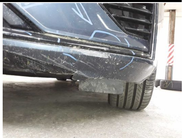
Beschädigung #18: Stossfänger vorn: Stossfänger vorn - verformt - erneuern
