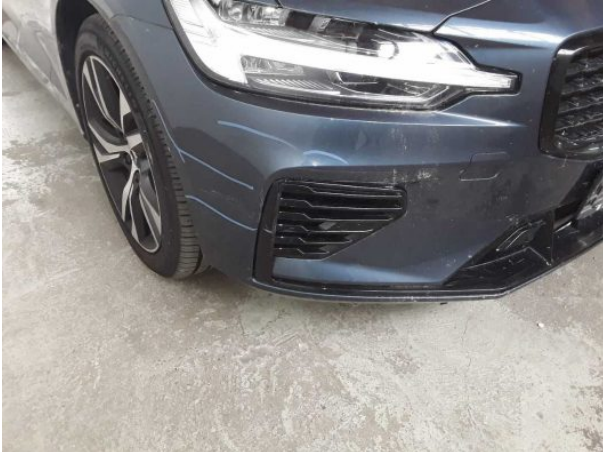
Beschädigung #2: Stossfänger vorn: Lufteinlassgitter (vorne rechts) - verkratzt / verschürft - erneuern
