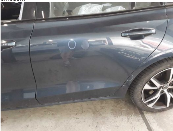
Beschädigung #13: Tür hinten links: Tür - Delle / Lackschaden - instandsetzen und lackieren
