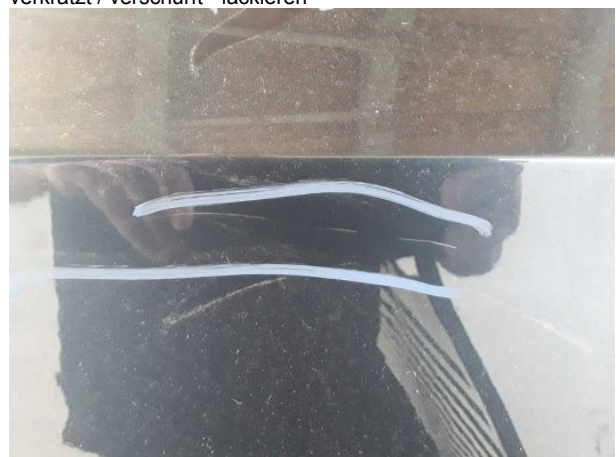
Beschädigung #15: Seitenwand rechts: Seitenwand - verkratzt / verschürft - lackieren
