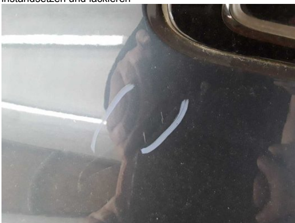
Beschädigung #15: Seitenwand rechts: Seitenwand - verkratzt / verschürft - lackieren
