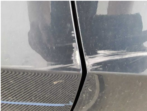
Beschädigung #14: Tür hinten rechts: Tür - verkratzt / verschürft - instandsetzen und lackieren
