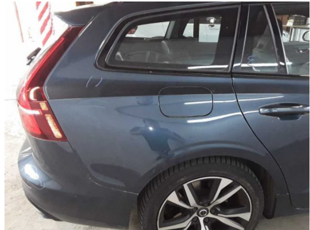
Beschädigung #15: Seitenwand rechts: Seitenwand - verkratzt / verschürft - lackieren
