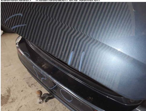
Beschädigung #16: Heckklappe/-tür: Heckklappe - Delle / Lackschaden - instandsetzen und lackieren
