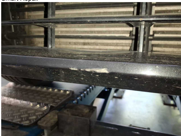
Beschädigung #2: Stossfänger vorn: Spoiler - Kratzer - Wertminderung
