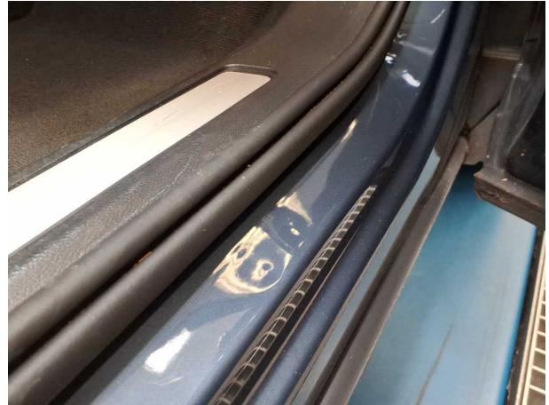
Beschädigung #1: Schweller rechts: Einstieg - Delle / Lackschaden - Smart Repair
