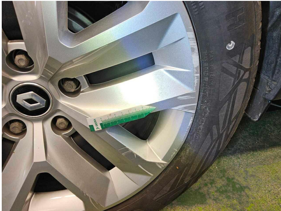
Bild 21 : Radkappe hinten rechts, zerkratzt
