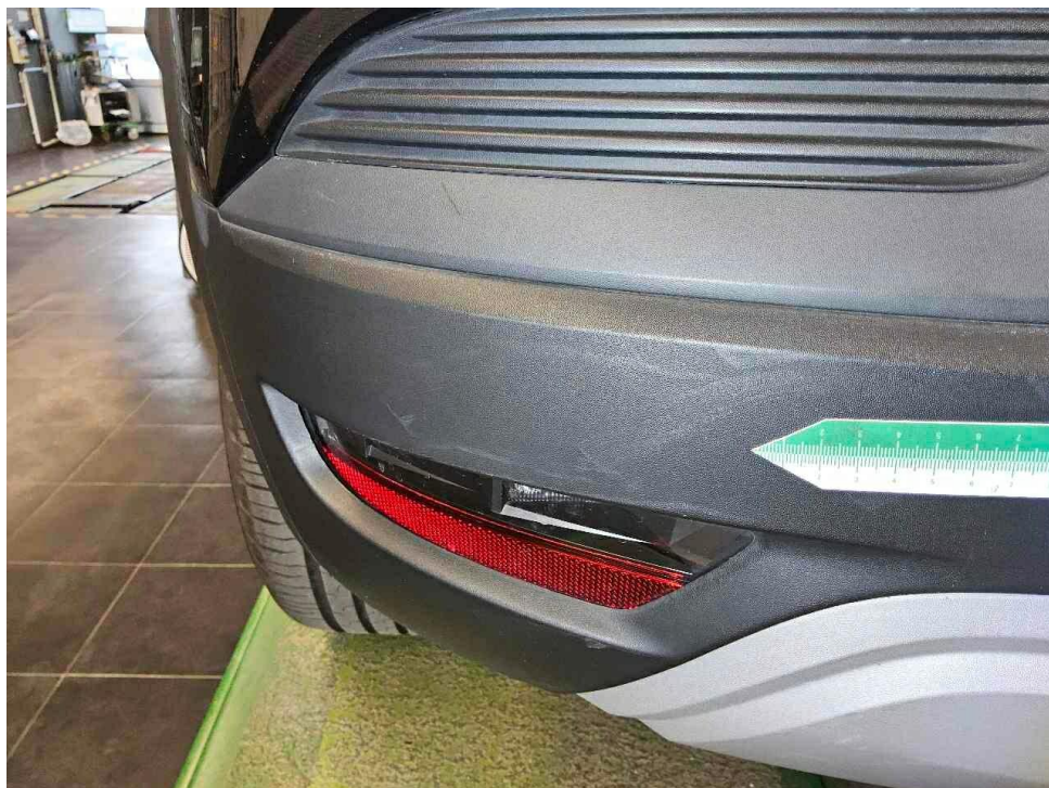
Bild 16 : Stoßfänger hinten und Heckschürze, zerkratzt
