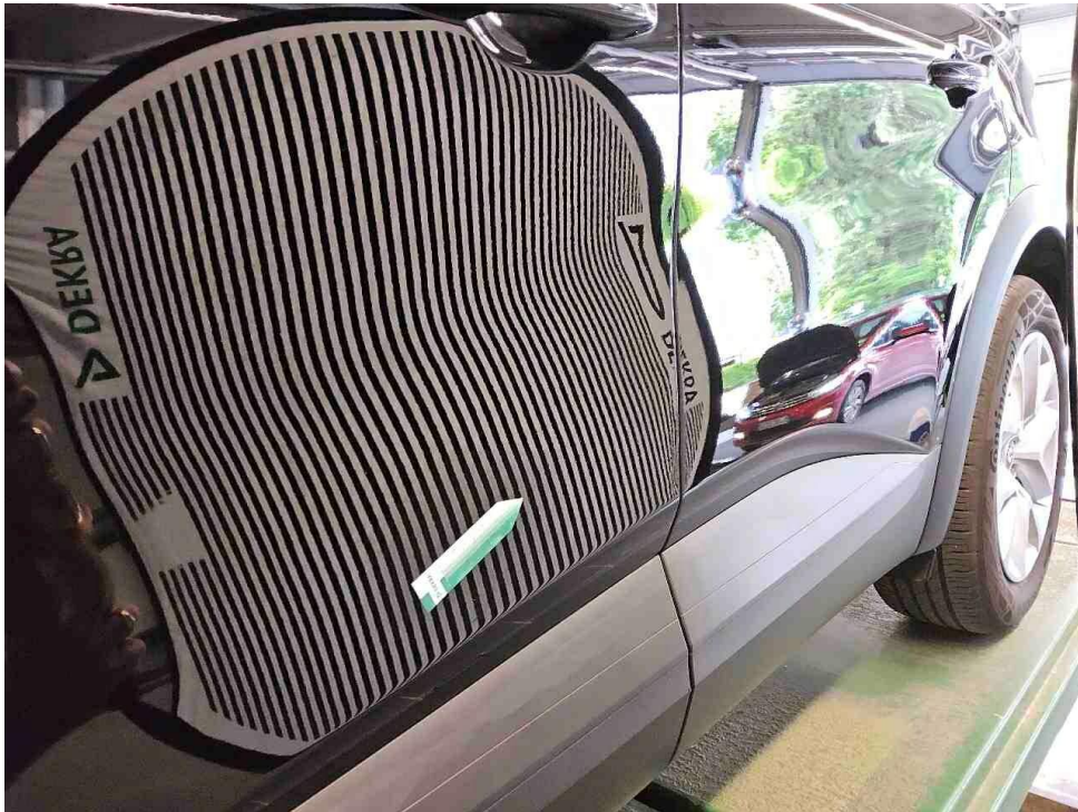
Bild 25 : Tür vorne links, eingedellt, Gebrauchsspur
