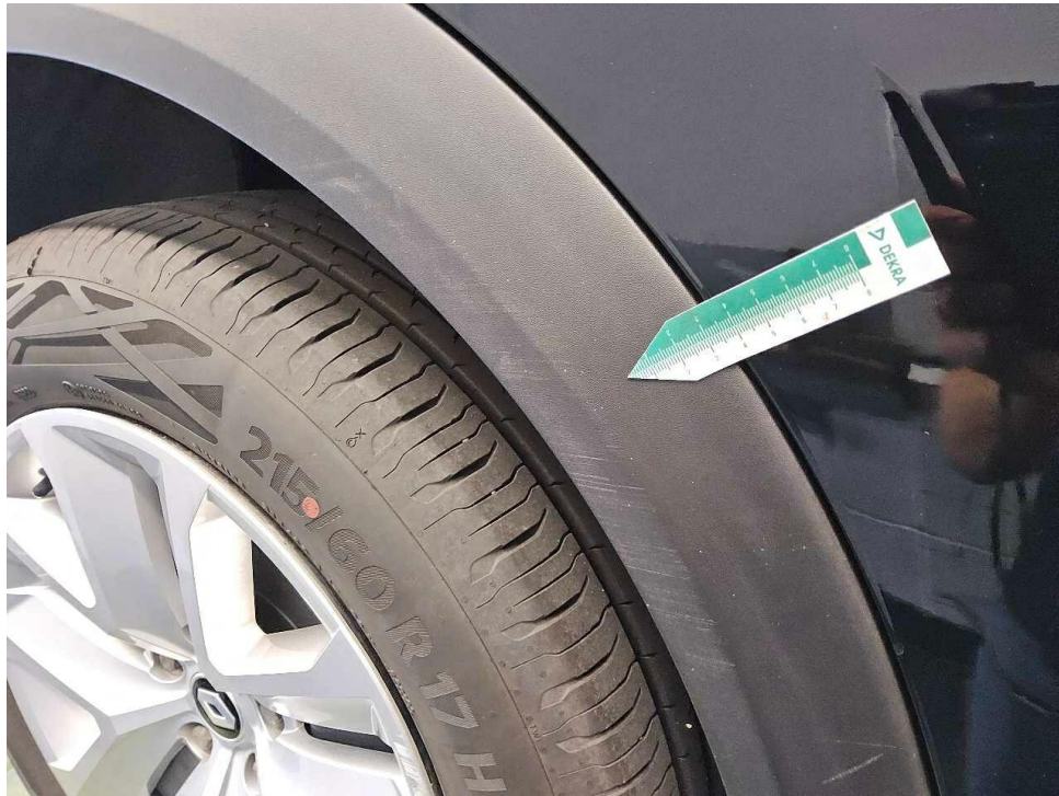
Bild 13 : Radlaufblende hinten rechts, zerkratzt
