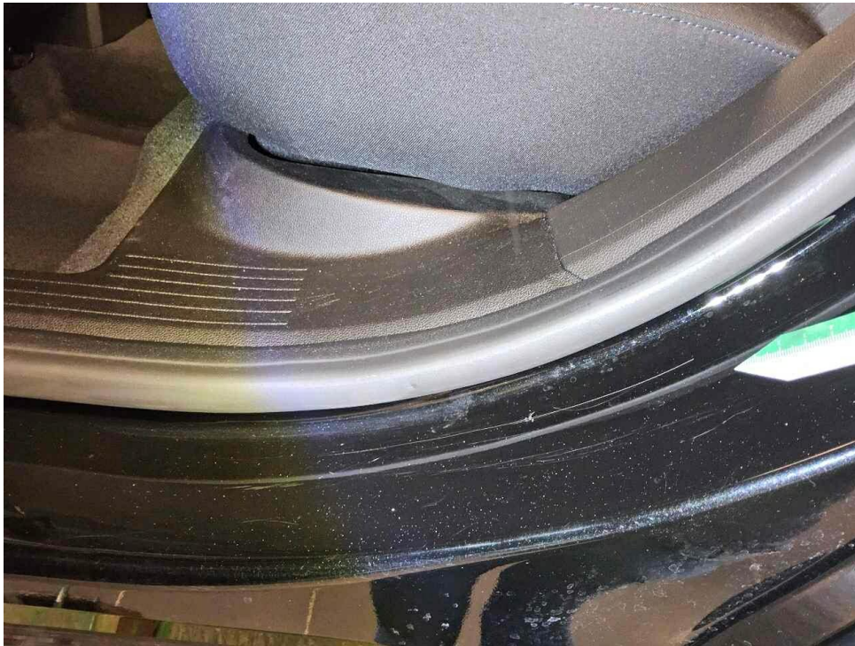
Bild 23 : Tür hinten links Einstieg Lackierung, zerkratzt, smart repair
