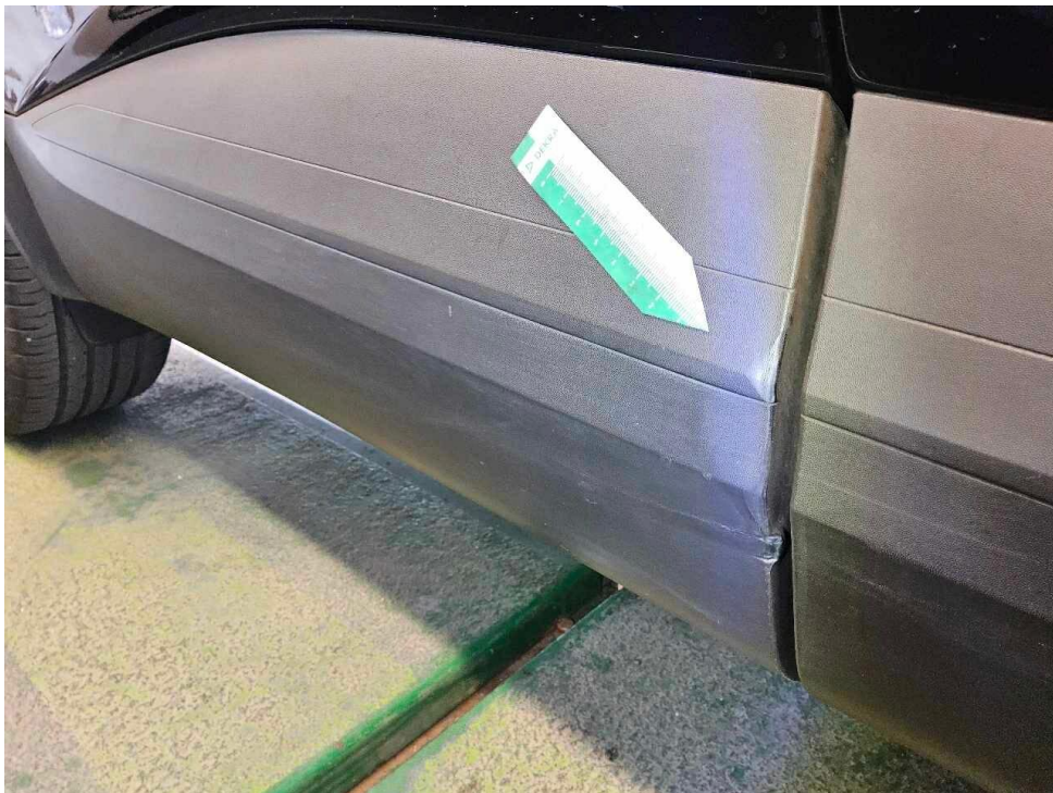
Bild 18 : Türblende hinten rechts, zerkratzt
