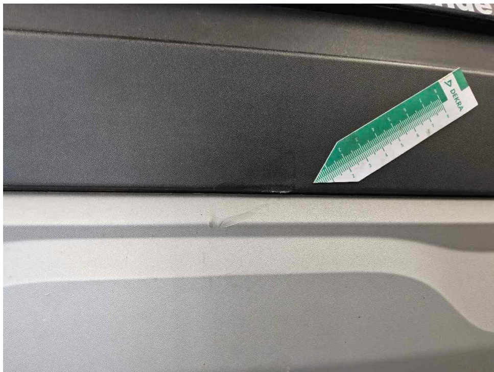
Bild 14 : Stoßfänger hinten und Heckschürze, zerkratzt
