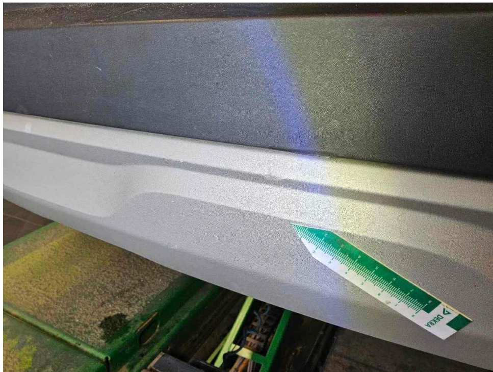
Bild 15 : Stoßfänger hinten und Heckschürze, zerkratzt
