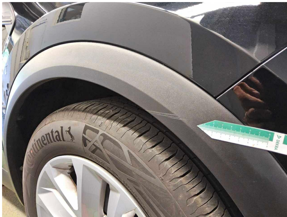
Bild 12 : Radlaufblende vorne rechts, zerkratzt
