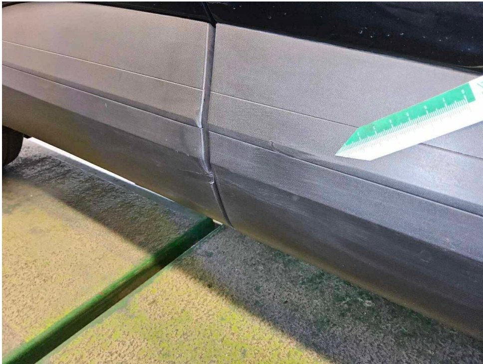
Bild 17 : Türblende vorne rechts, zerkratzt
