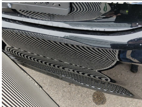
Stoßfänger / Hinten / Gebrochen
