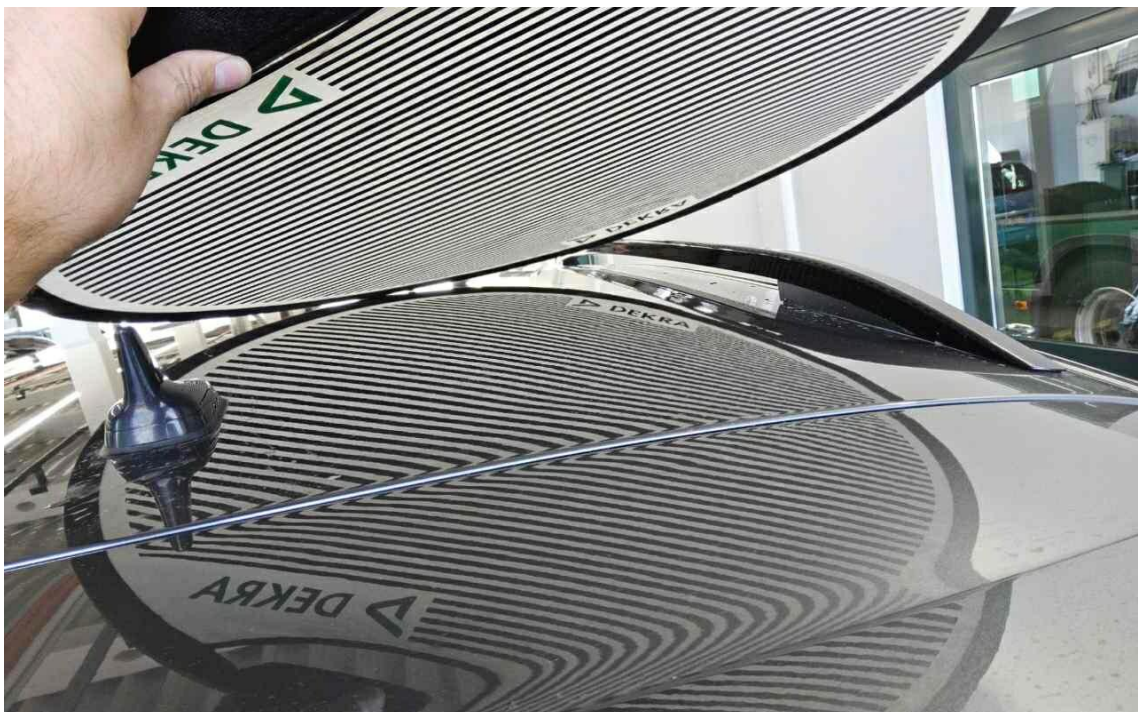
Bild 18 : Hagelähnlicher Schaden, Dach, Dachholme, Heckklappe
