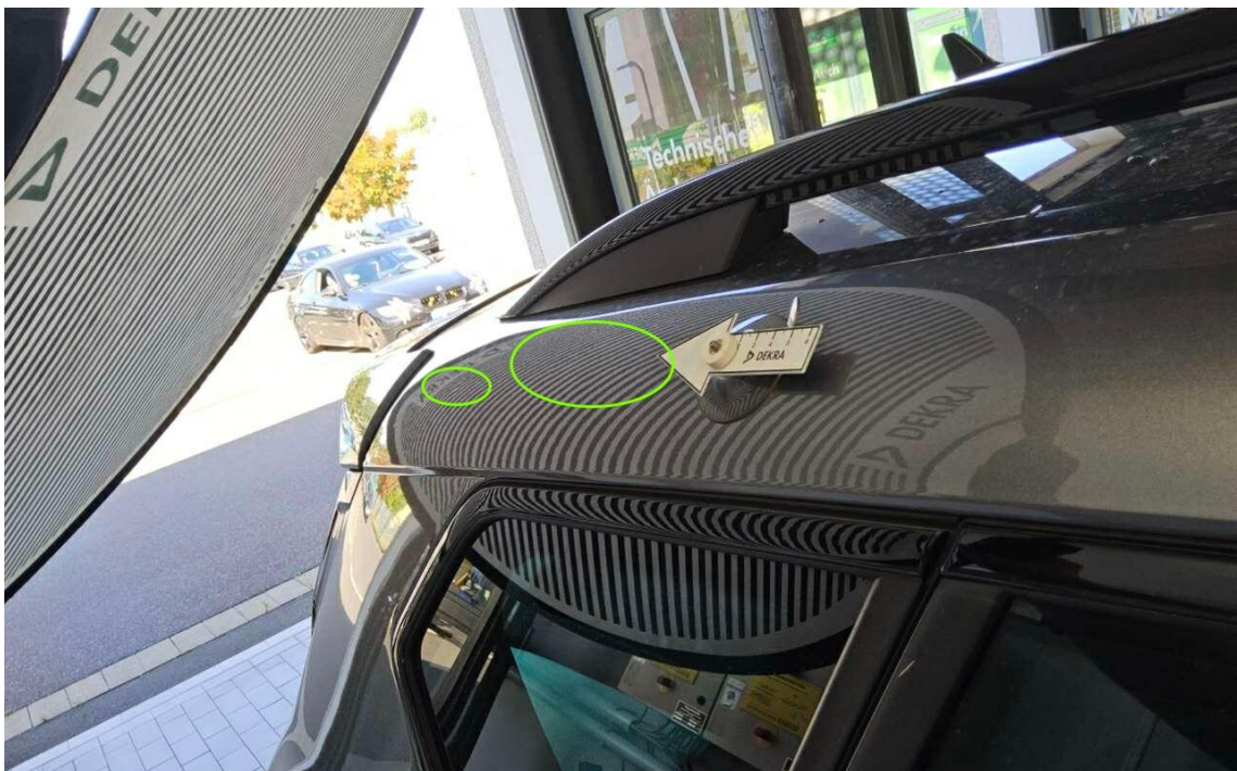
Bild 22 : Hagelähnlicherschaden, Dach, Dachholme, Heckklappe
