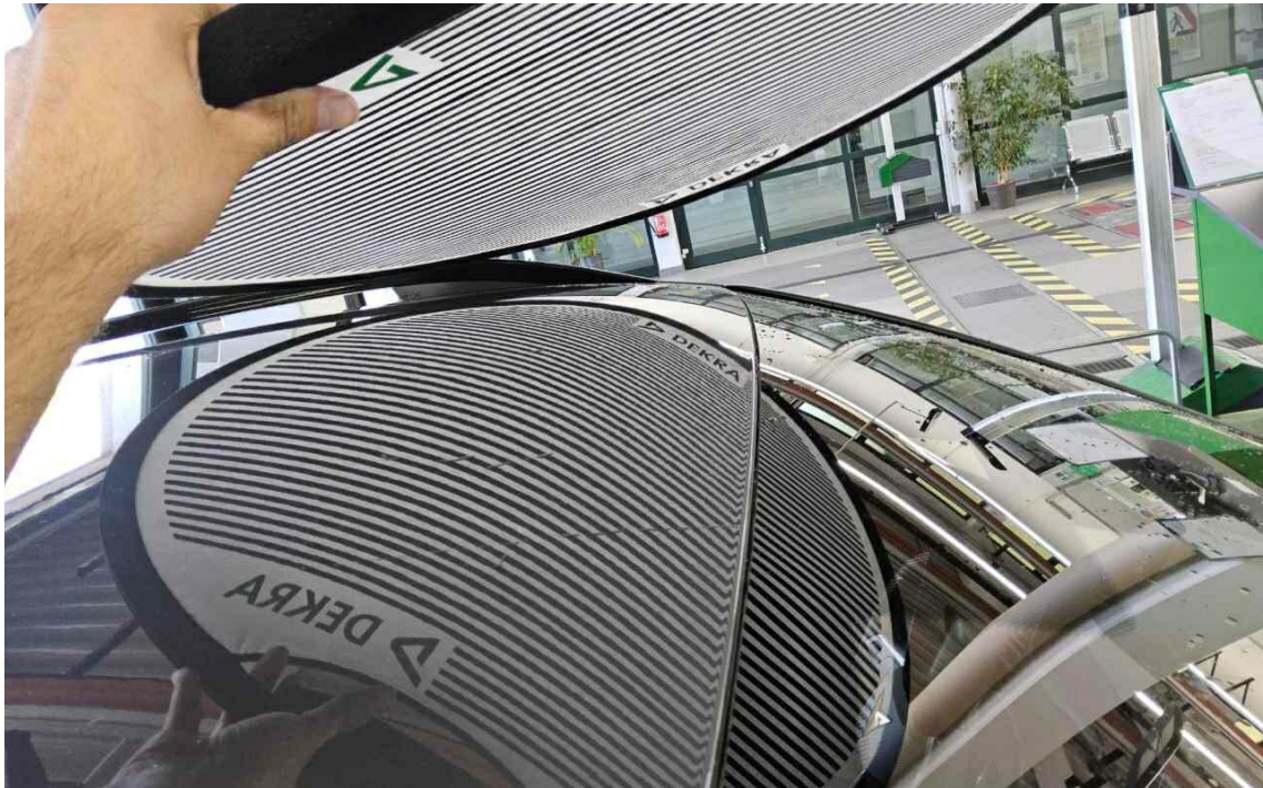
Bild 27 : Hagelähnlicher Schaden, Dach, Dachholme, Heckklappe
