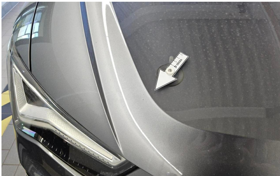
Bild 13 : Motorhaube Lackierung, Steinschlag, Gebrauchsspur
