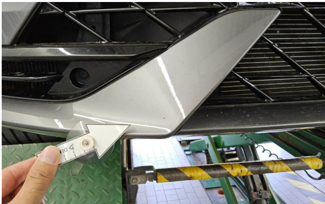
Bild 15 : Stoßfänger vorne Lackierung, Steinschlag, Gebrauchsspur
