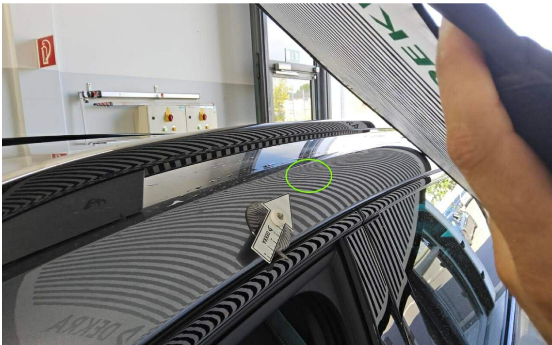
Bild 24 : Hagelähnlicher Schaden, Dach, Dachholme, Heckklappe
