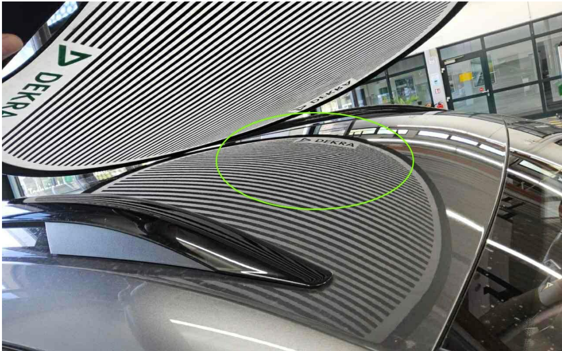
Bild 17 : Hagelähnlicher Schaden, Dach, Dachholme, Heckklappe
