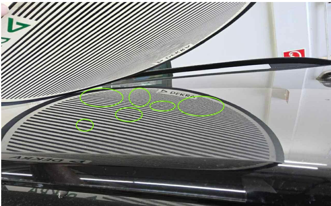
Bild 20 : Hagelähnlicherschaden, Dach, Dachholme, Heckklappe
