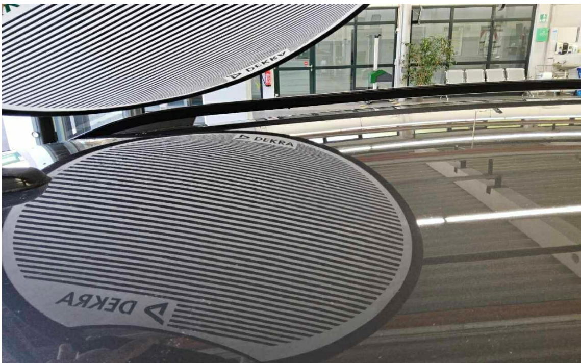
Bild 28 : Hagelähnlicher Schaden, Dach, Dachholme, Heckklappe
