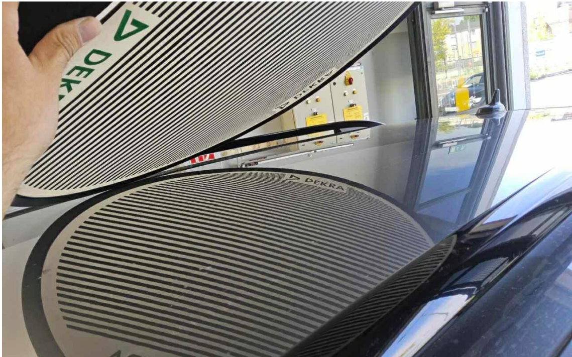
Bild 21 : Hagelähnlicherschaden, Dach, Dachholme, Heckklappe
