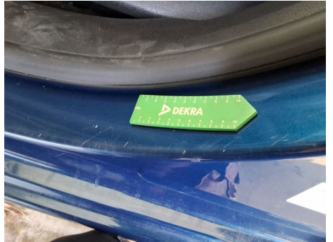
Door sill / Front Left / Dent
