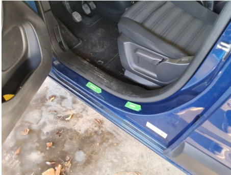
Door sill / Front Left / Dent
