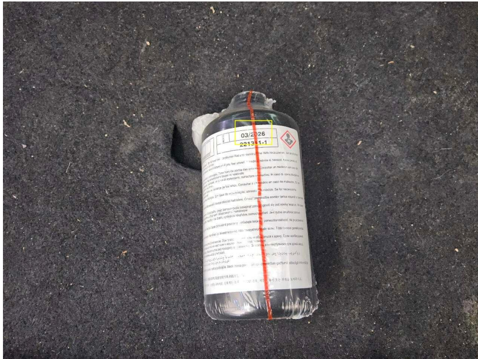
Bild 31 : Pannenset Reifendichtmittel, abgelaufen
