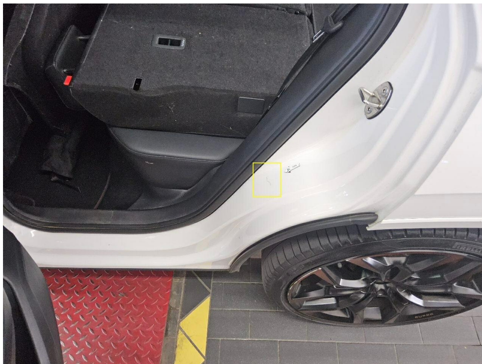
Bild 13 : Tür hinten links Einstieg, zerkratzt
