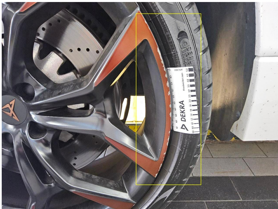
Bild 16 : Felge (Sommer) vorne links, zerkratzt
