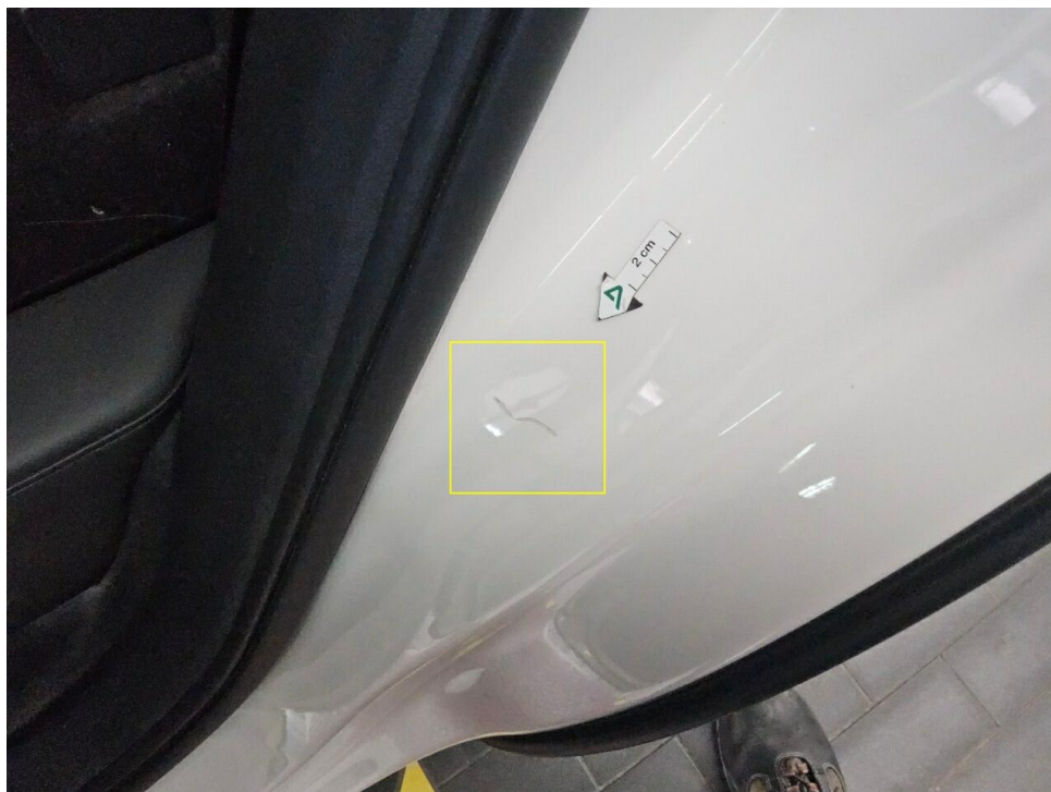
Bild 14 : Tür hinten links Einstieg, zerkratzt
