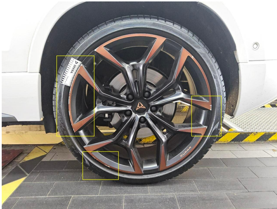
Bild 17 : Felge (Sommer) hinten links, zerkratzt
