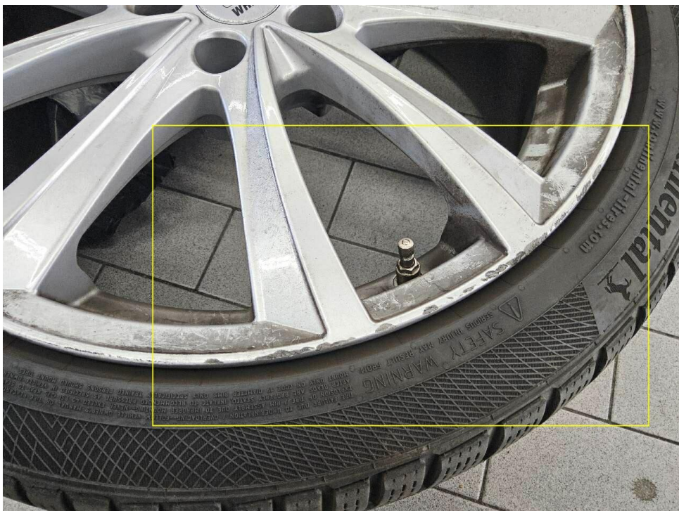
Bild 24 : Felge (Winter) vorne rechts, zerkratzt
