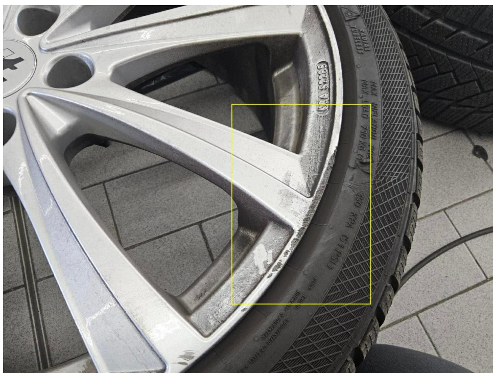
Bild 26 : Felge (Winter) hinten rechts, zerkratzt
