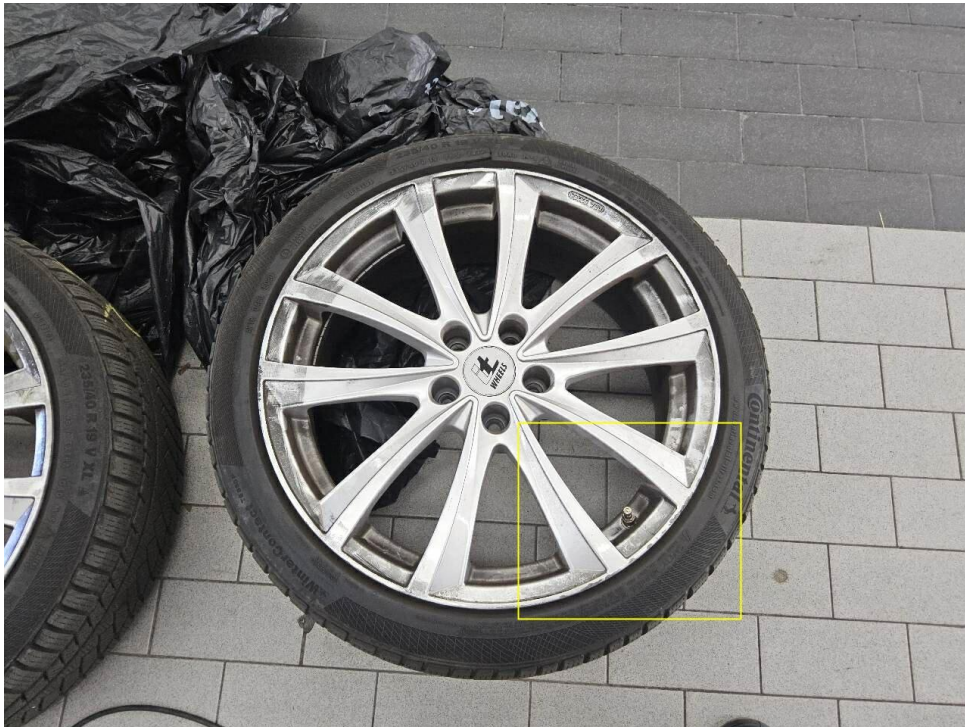
Bild 23 : Felge (Winter) vorne rechts, zerkratzt
