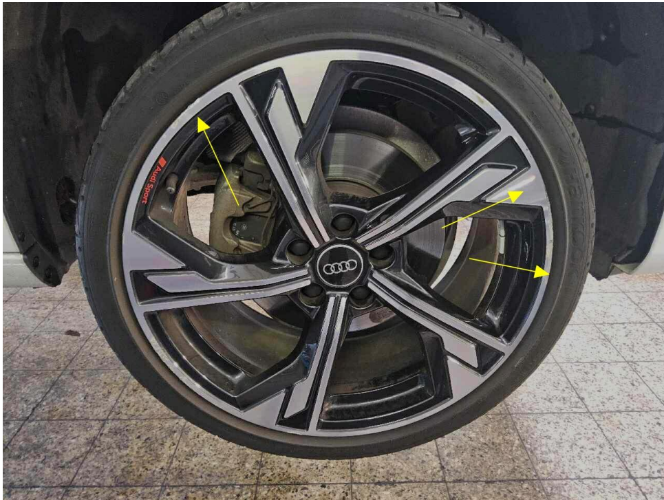
Bild 9 : Felge vorne rechts verschrammt
