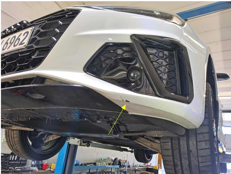
Bild 10 : Stoßfänger vorne verschrammt
