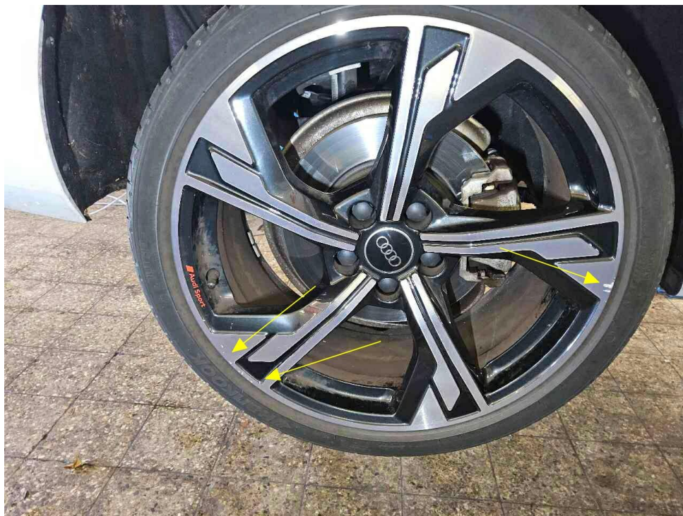
Bild 8 : Felge hinten rechts verschrammt
