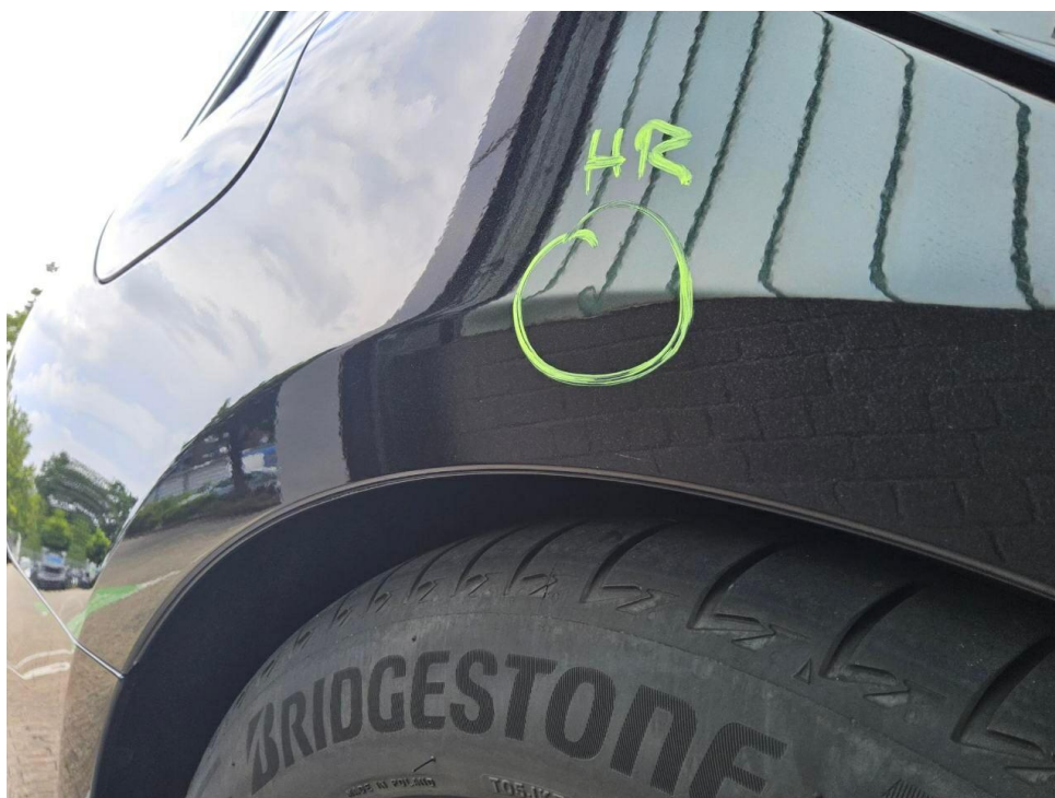
Bild 16 : Seitenteil hinten rechts, eingedellt, smart repair
