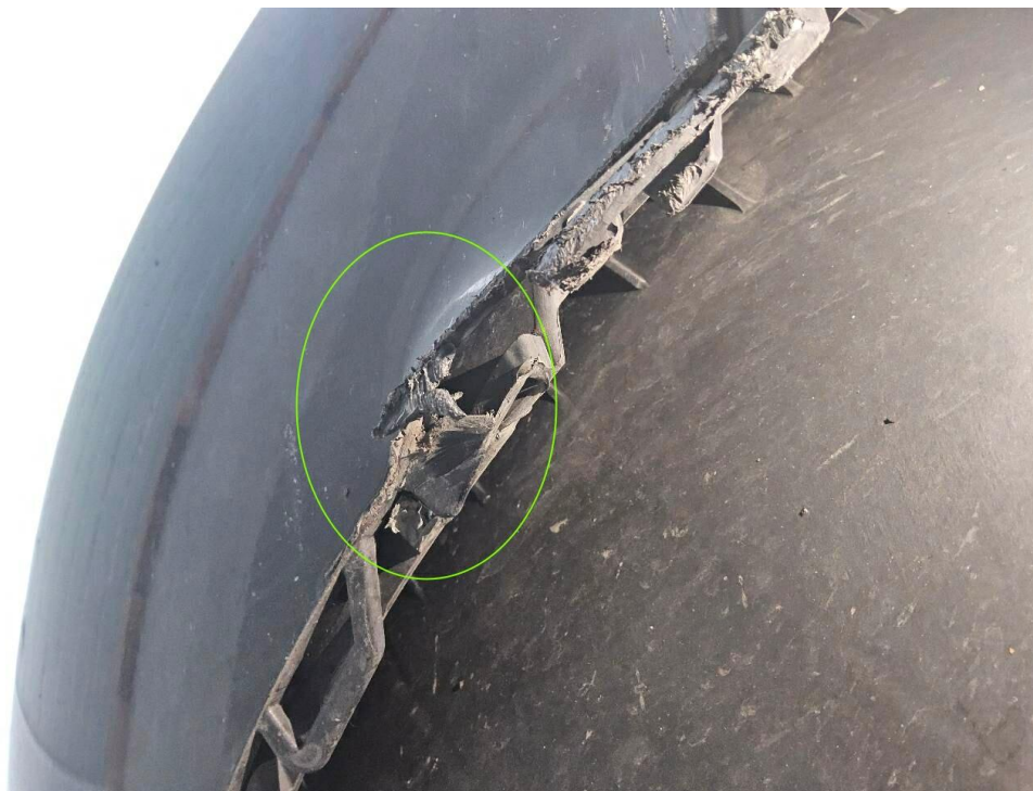
Bild 19 : Frontspoiler, gerissen, instandsetzen und lackieren mit Lackaufbau
