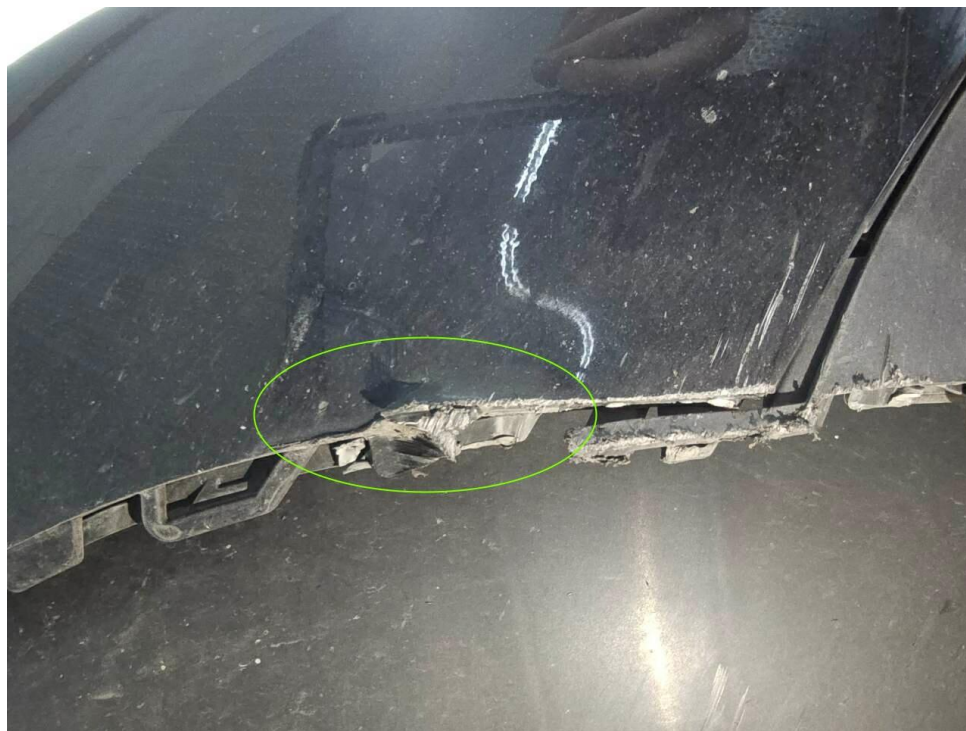
Bild 18 : Frontspoiler, gerissen, instandsetzen und lackieren mit Lackaufbau
