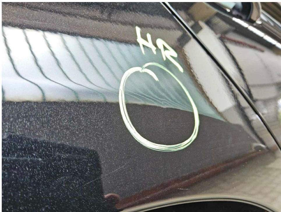
Bild 15 : Seitenteil hinten rechts, eingedellt, smart repair
