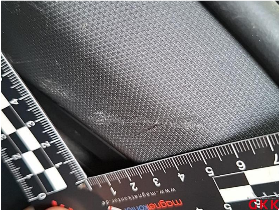
Bild 61. D- Säule rechts, Innenverkleidung, beschädigt, ersetzen
