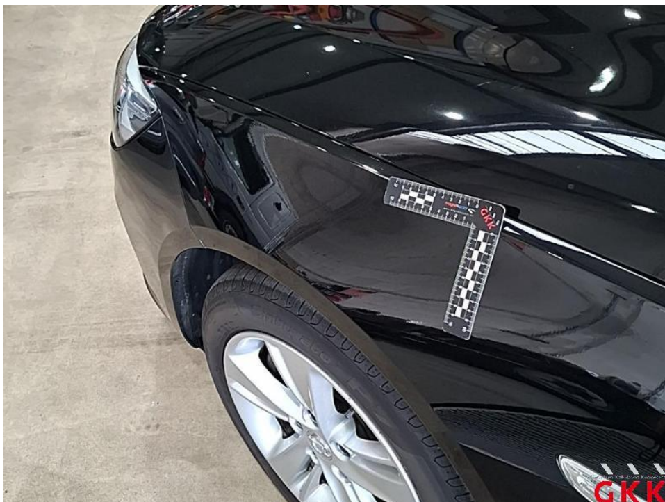
Bild 26. Kotflügel vorne links, bis 3 Dellen / Bauteil, Smartrepair
