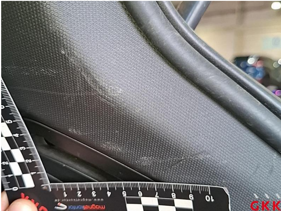
Bild 60. D- Säule rechts, Innenverkleidung, beschädigt, ersetzen
