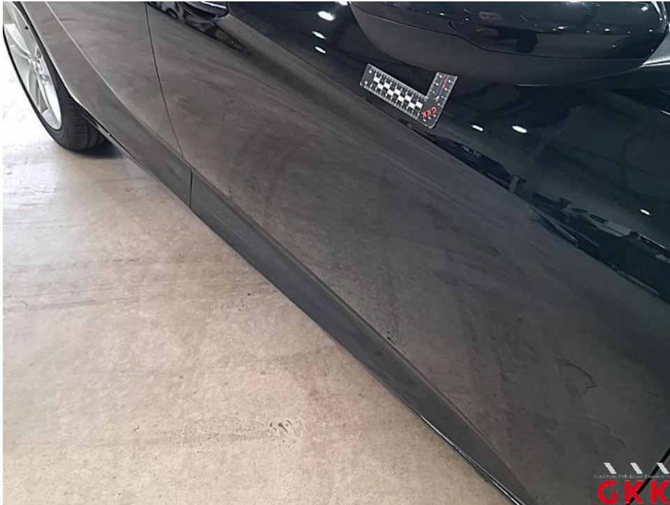
Bild 77. Tür vorne rechts, Reparaturmangel, instand setzen - lackieren
