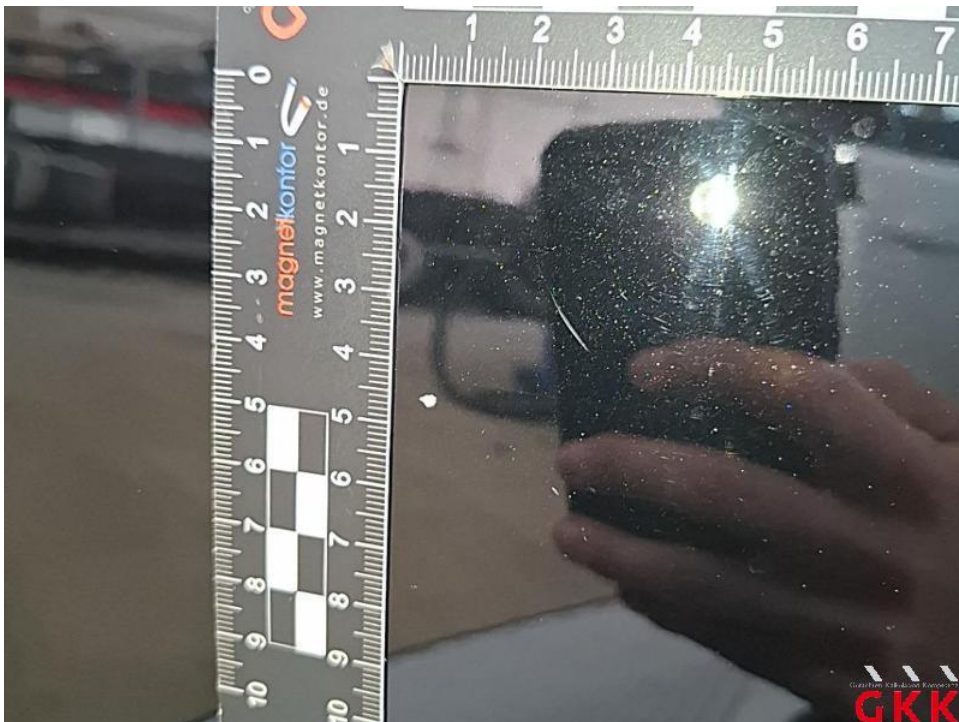
Bild 40. Tür hinten links, beschädigt, instand setzen - lackieren
