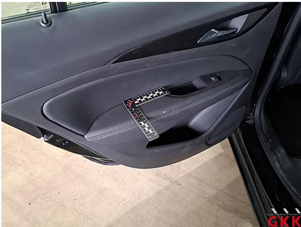
Bild 44. Tür hinten links, Innenverkleidung -Standard-, beschädigt, ersetzen
