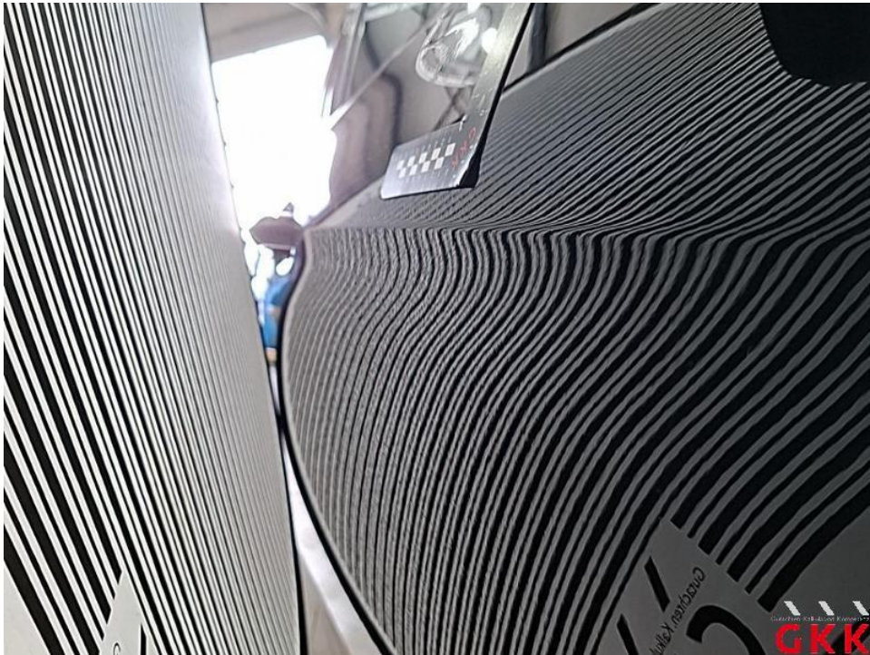
Bild 78. Tür vorne rechts, Reparaturmangel, instand setzen - lackieren
