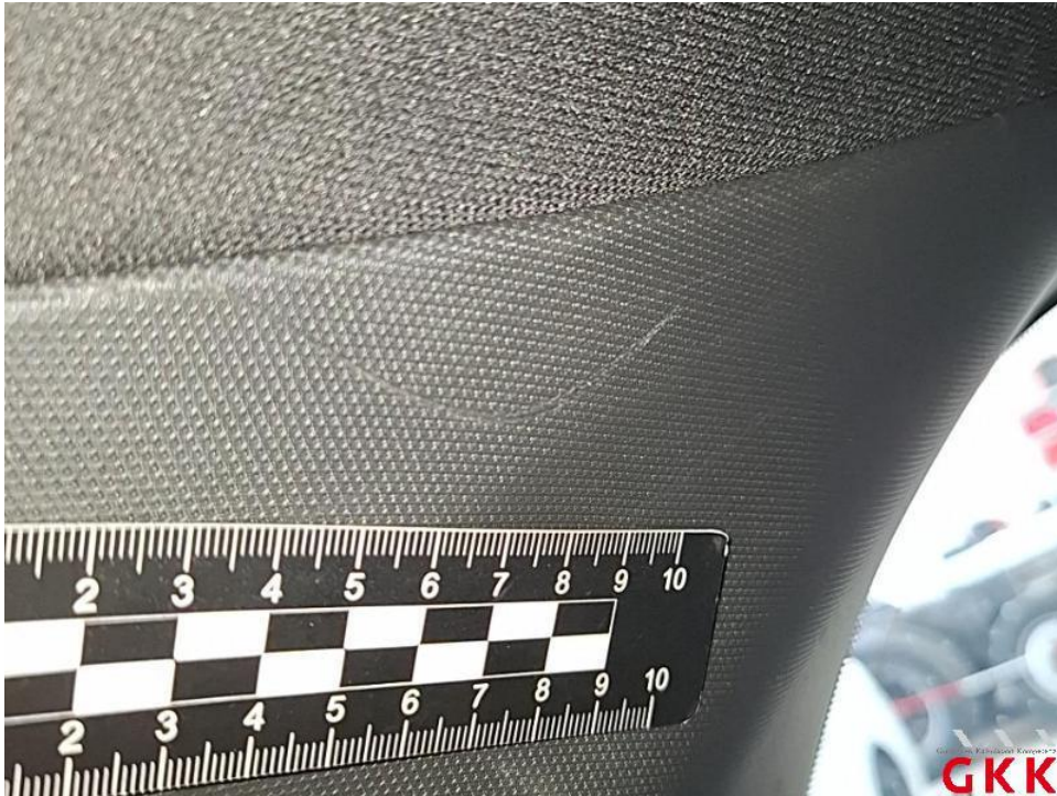
Bild 63. D- Säule links, Innenverkleidung, beschädigt, ersetzen
