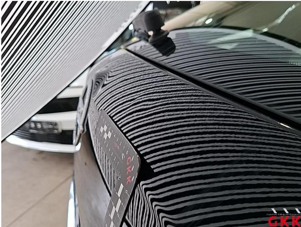
Bild 52. Heckklappe, Reparaturmangel, instand setzen - lackieren
