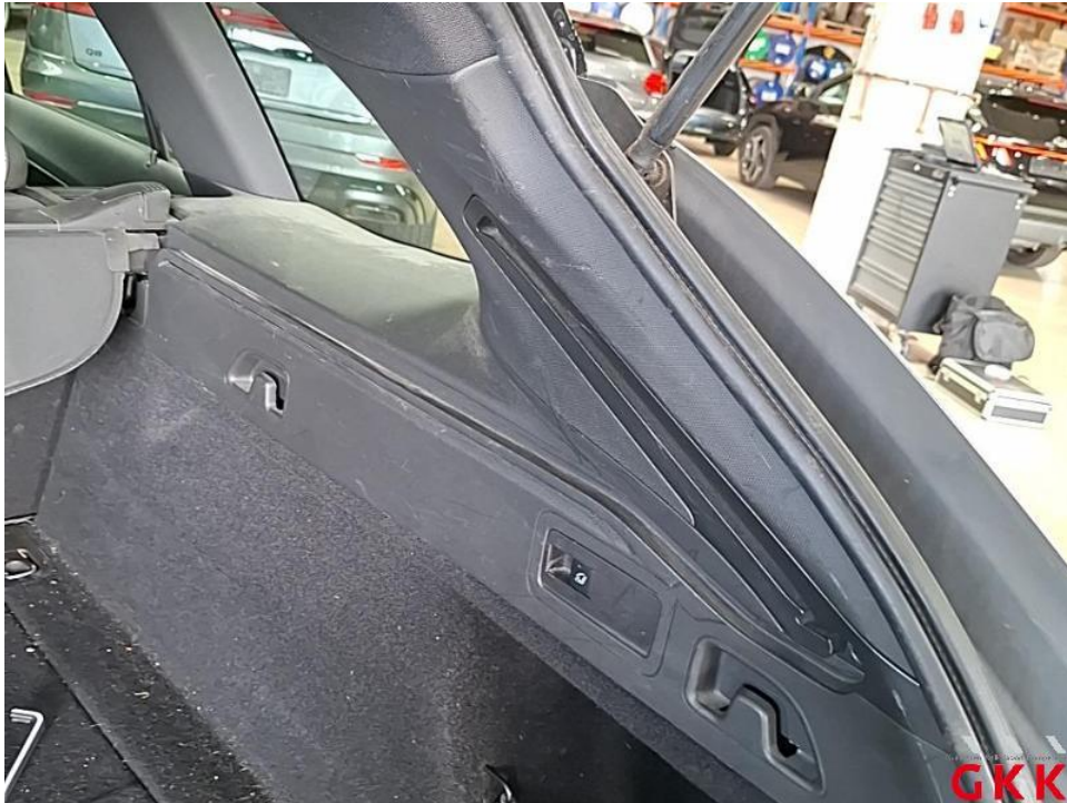
Bild 59. D- Säule rechts, Innenverkleidung, beschädigt, ersetzen
