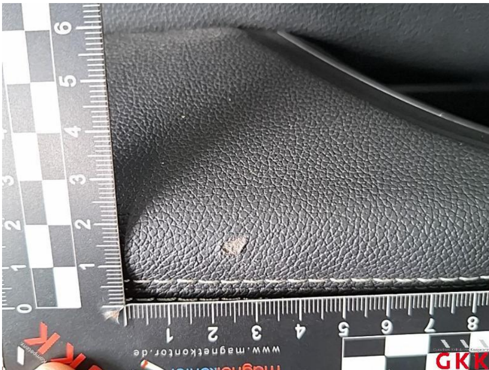
Bild 46. Tür hinten links, Innenverkleidung -Standard-, beschädigt, ersetzen
