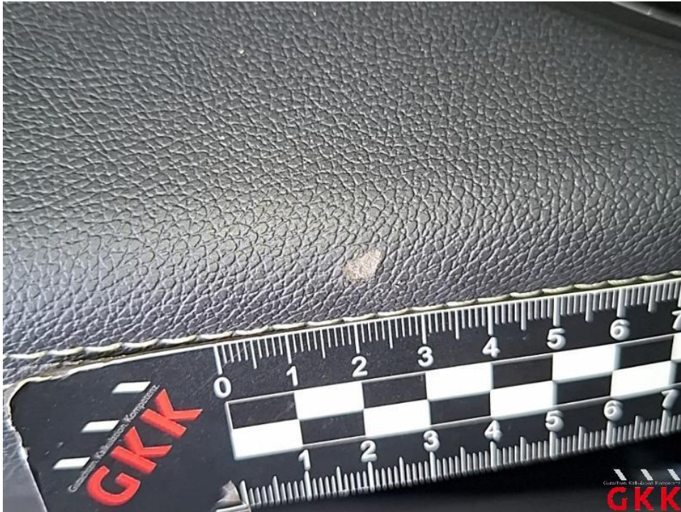
Bild 45. Tür hinten links, Innenverkleidung -Standard-, beschädigt, ersetzen
