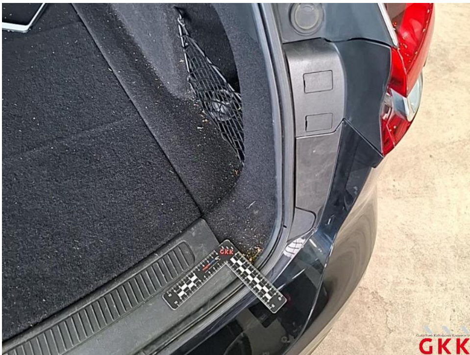
Bild 54. Heckklappe, Dichtung, beschädigt, ersetzen
