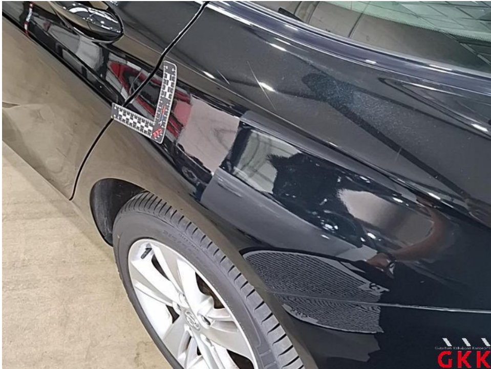
Bild 47. Seitenwand links, Reparaturmangel, instand setzen - lackieren
