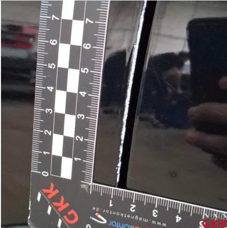
Bild 31. Tür vorne links, beschädigt, instand setzen - lackieren
