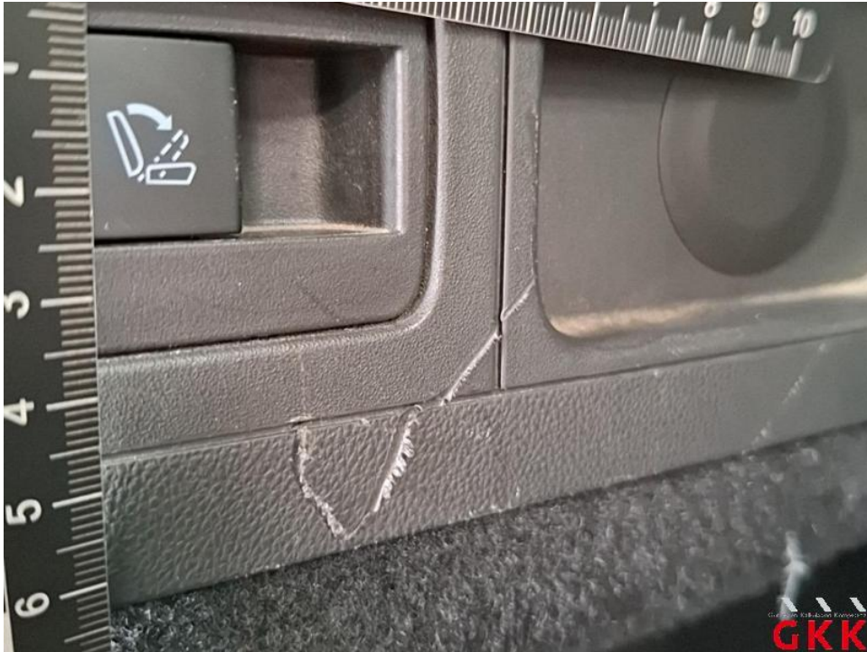
Bild 67. Seitenwand links, Innenverkleidung, beschädigt, ersetzen
