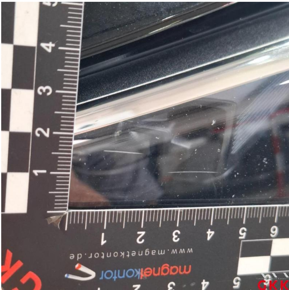
Bild 24. Scheinwerfer links LED, Steinschlag und Kratzer, ersetzen
