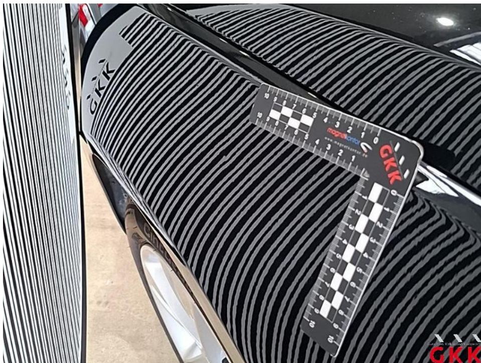
Bild 27. Kotflügel vorne links, bis 3 Dellen / Bauteil, Smartrepair
