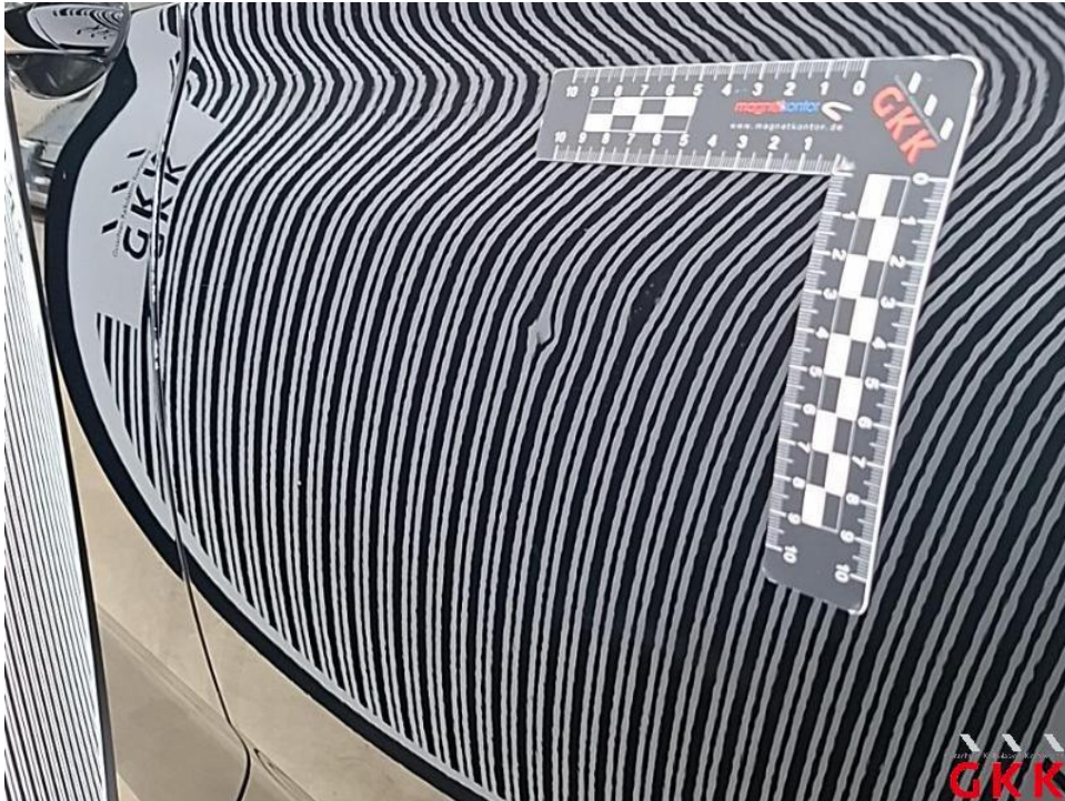
Bild 39. Tür hinten links, beschädigt, instand setzen - lackieren
