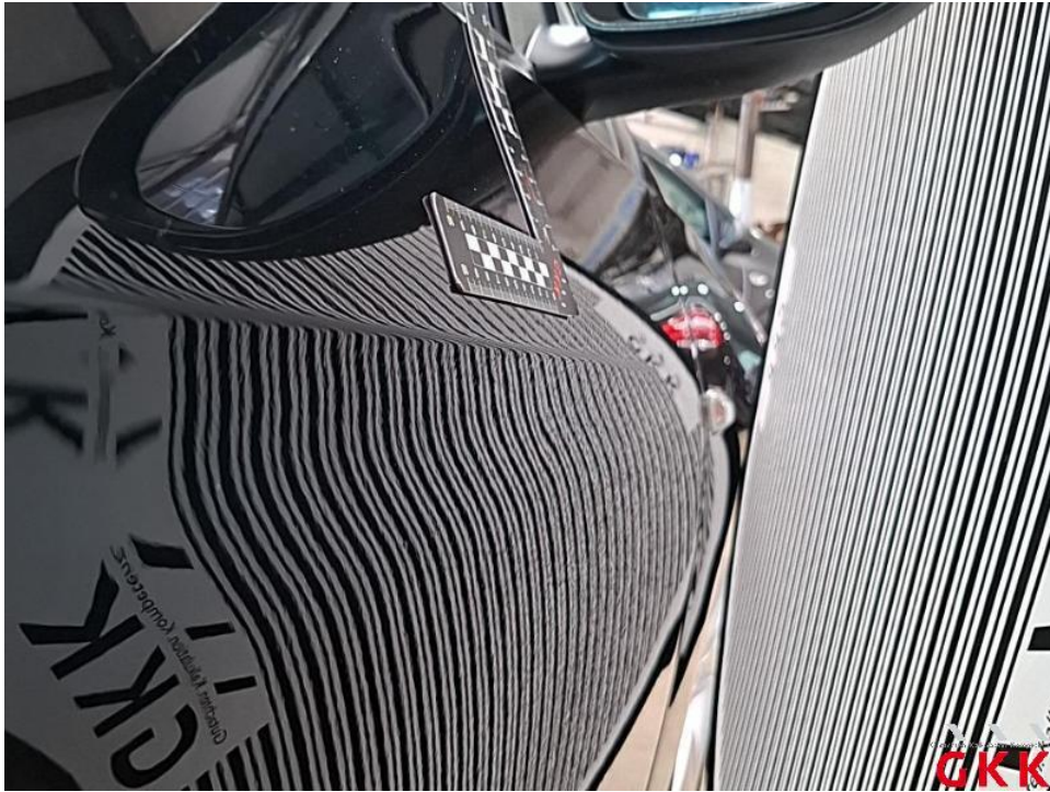
Bild 79. Tür vorne rechts, Reparaturmangel, instand setzen - lackieren
