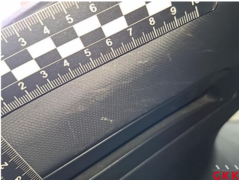
Bild 64. D- Säule links, Innenverkleidung, beschädigt, ersetzen
