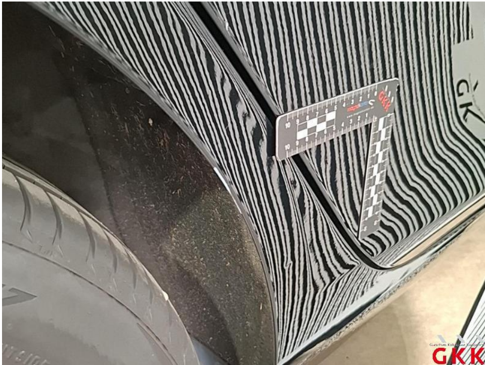
Bild 72. Seitenwand rechts, beschädigt, instand setzen - lackieren
