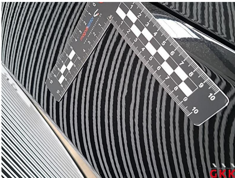
Bild 28. Kotflügel vorne links, bis 3 Dellen / Bauteil, Smartrepair
