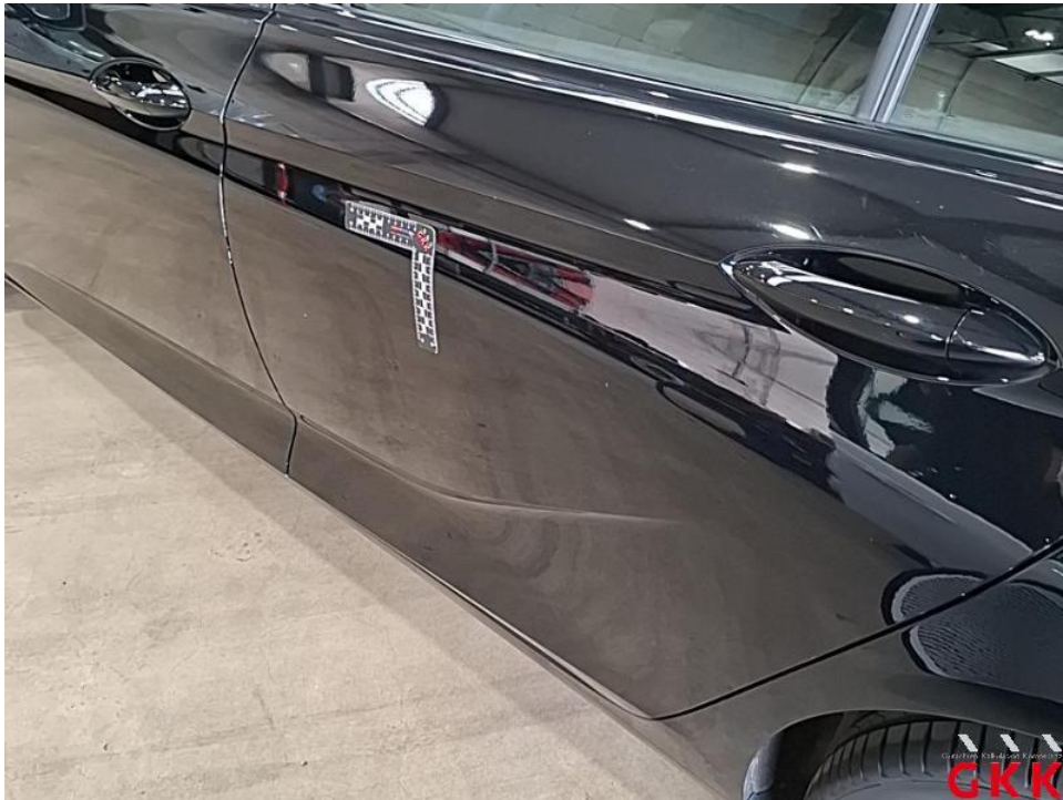
Bild 38. Tür hinten links, beschädigt, instand setzen - lackieren
