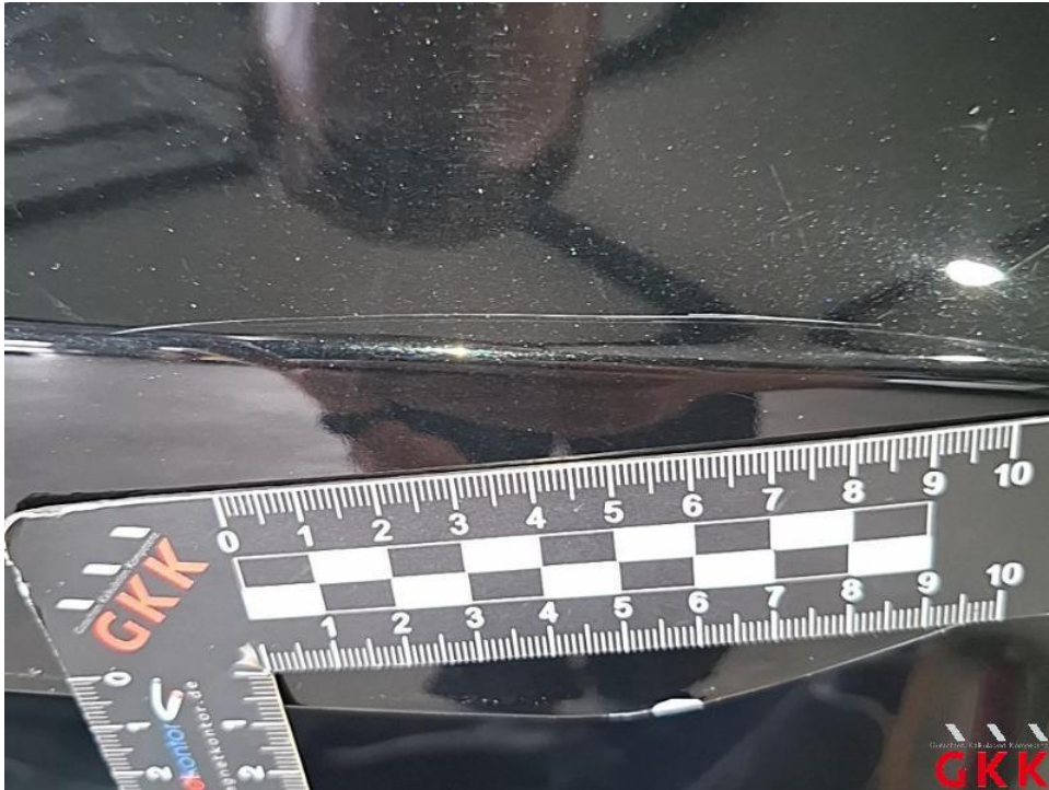
Bild 53. Heckklappe, Reparaturmangel, instand setzen - lackieren
