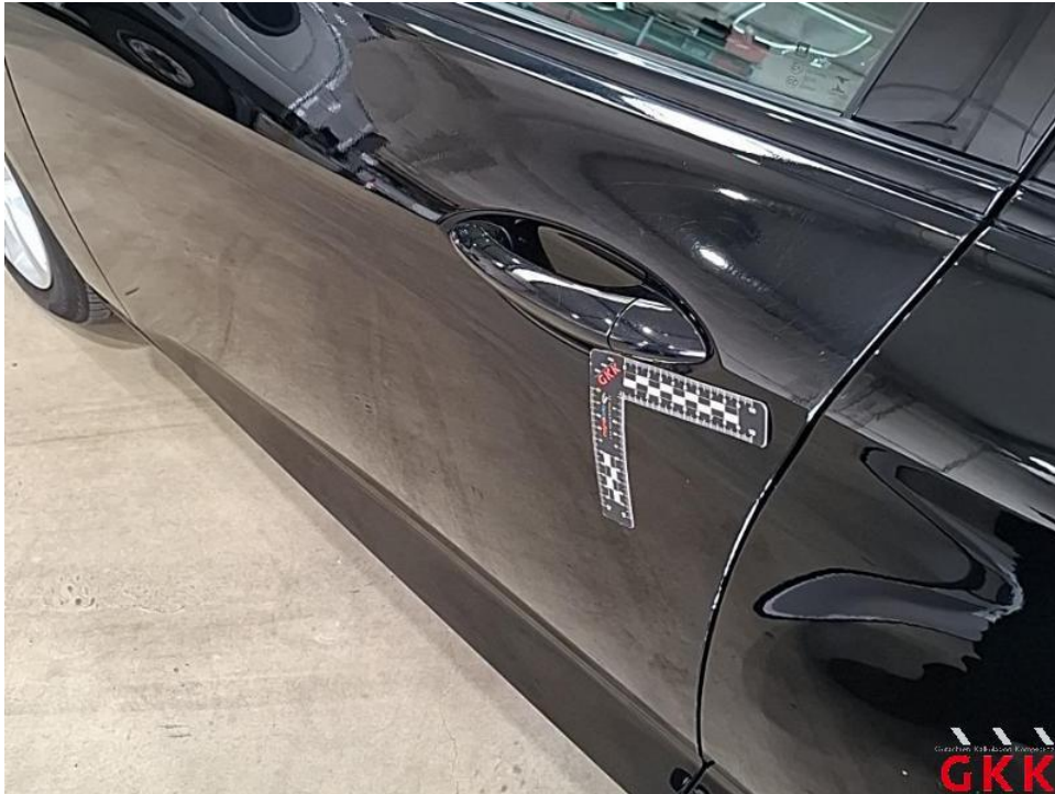
Bild 29. Tür vorne links, beschädigt, instand setzen - lackieren
