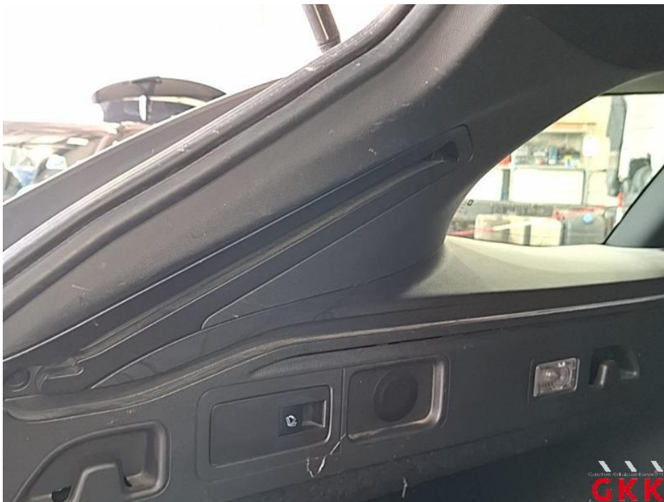
Bild 62. D- Säule links, Innenverkleidung, beschädigt, ersetzen
