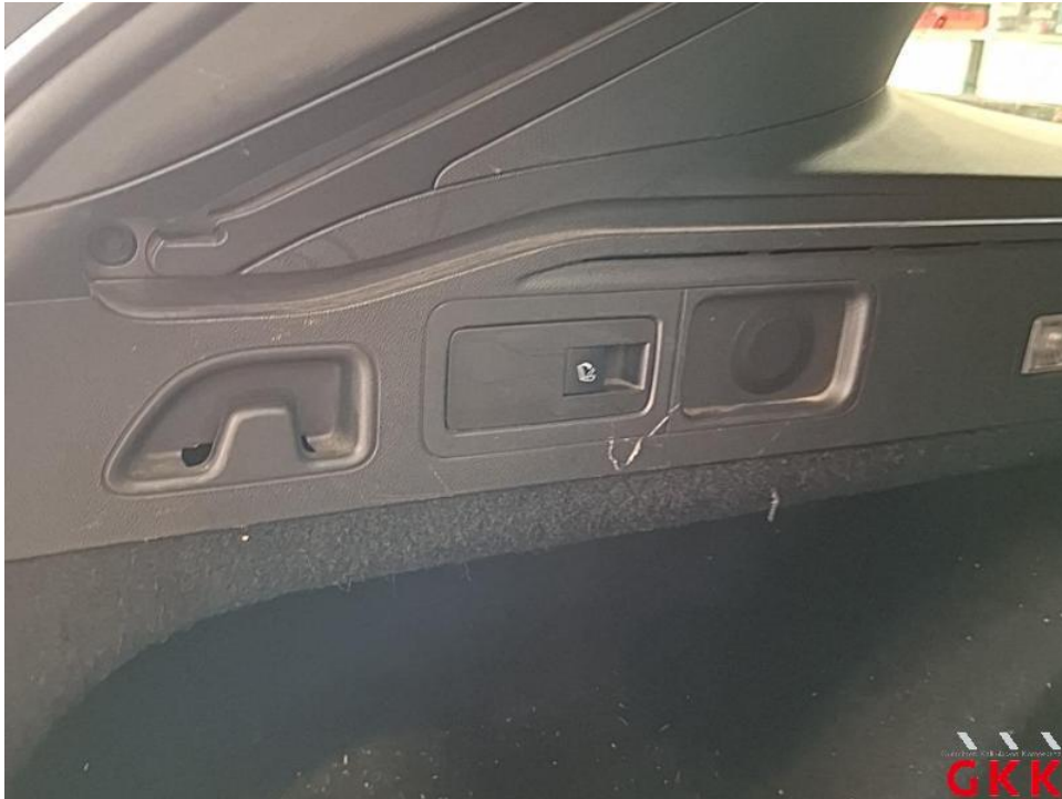
Bild 65. Seitenwand links, Innenverkleidung, beschädigt, ersetzen
