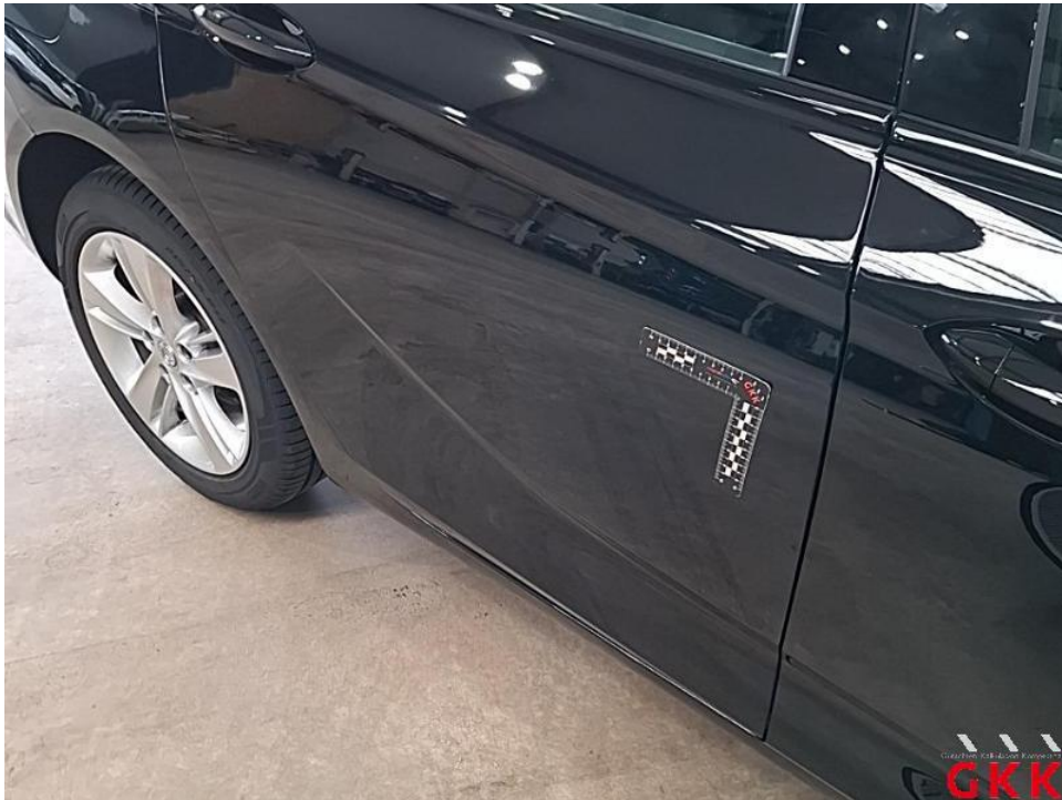
Bild 74. Tür hinten rechts, Reparaturmangel, instand setzen - lackieren
