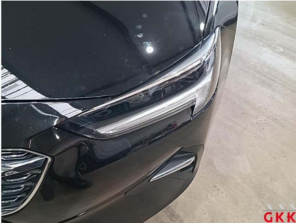
Bild 23. Scheinwerfer links LED, Steinschlag und Kratzer, ersetzen
