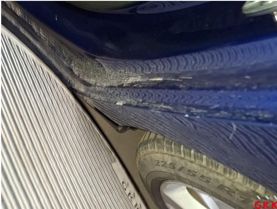
Bild 42 Fahrzeug, hinten links, Unfallschaden, Unfallschaden beheben
