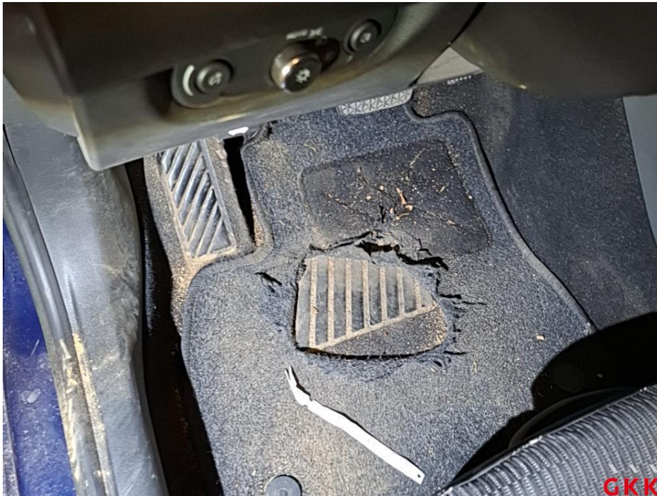
Bild 36 Fußmatte(n), vorne rechts, beschädigt, ersetzen
