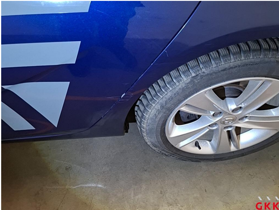
Bild 40 Fahrzeug, hinten links, Unfallschaden, Unfallschaden beheben
