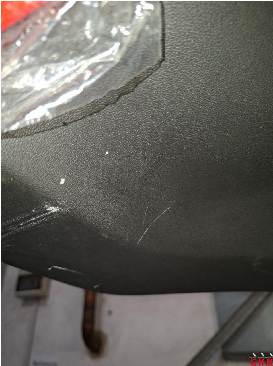
Bild 31 Heckklappe, Innenverkleidung, beschädigt, ersetzen
