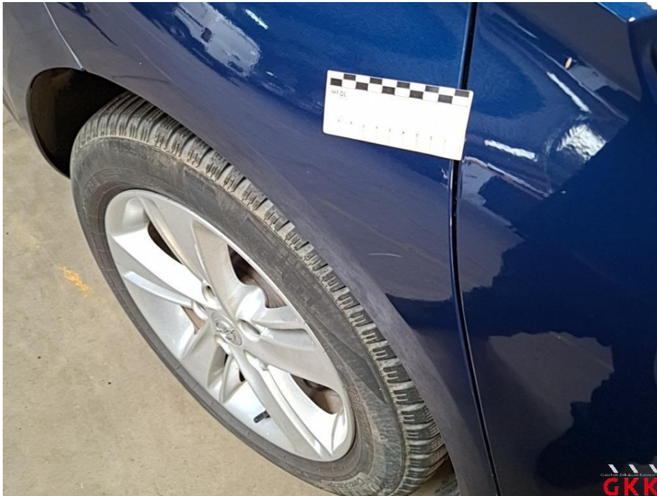
Bild 32 Seitenwand rechts, beschädigt, instand setzen - lackieren
