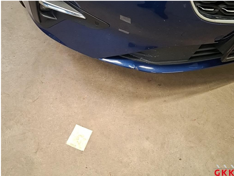
Bild 20 Stoßfänger vorne, Verkleidung -lackiert-, beschädigt, ersetzen
