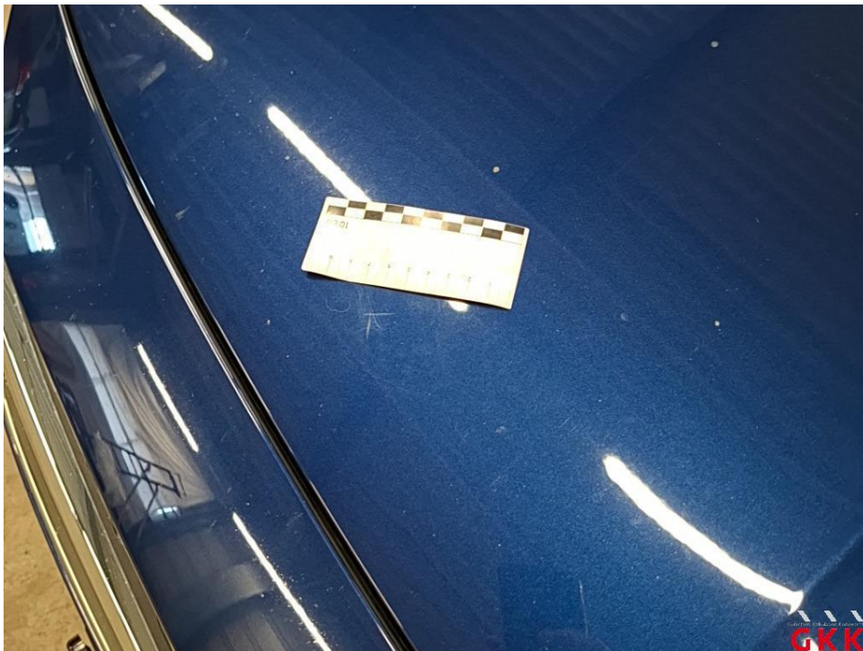
Bild 23 Motorhaube, verkratzt, lackieren
