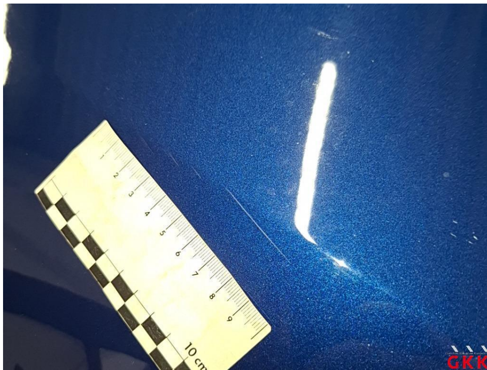
Bild 25 Motorhaube, verkratzt, lackieren
