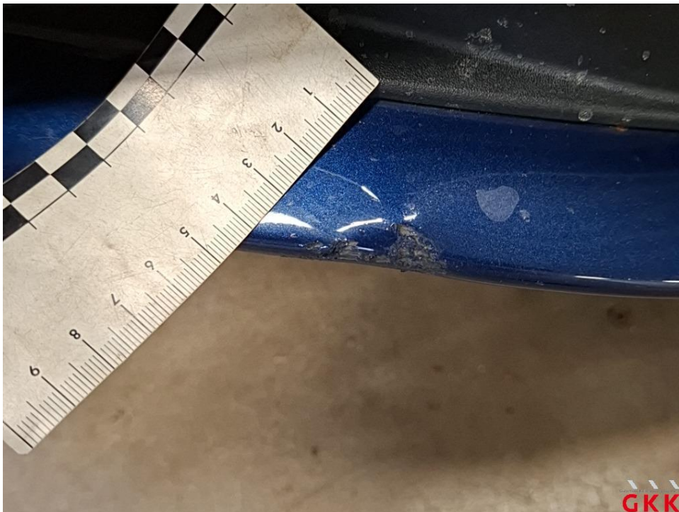
Bild 21 Stoßfänger vorne, Verkleidung -lackiert-, beschädigt, ersetzen
