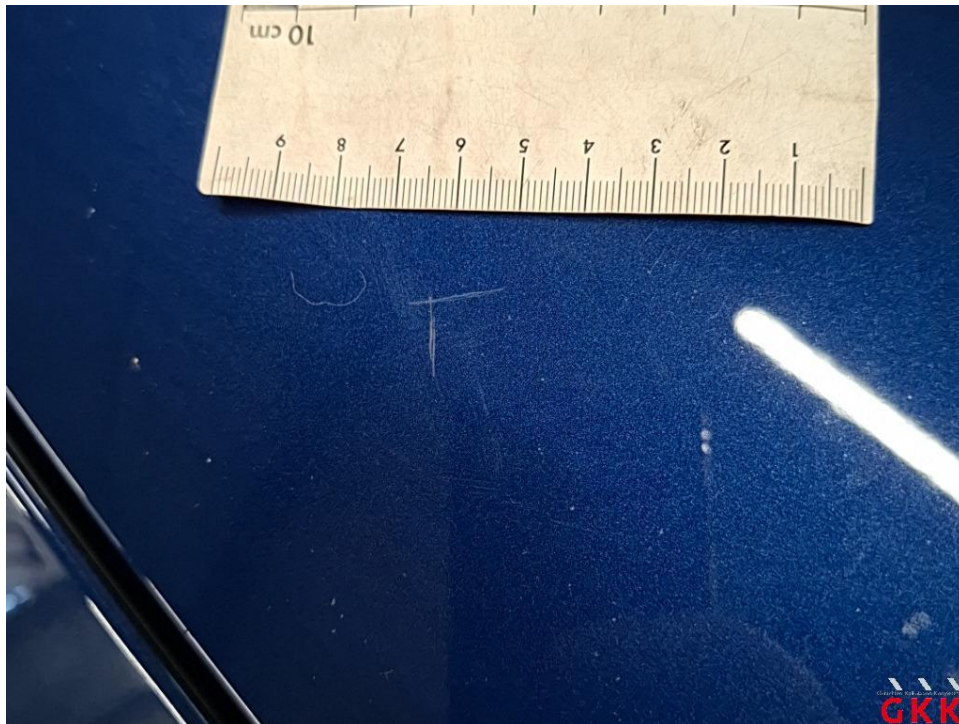
Bild 24 Motorhaube, verkratzt, lackieren
