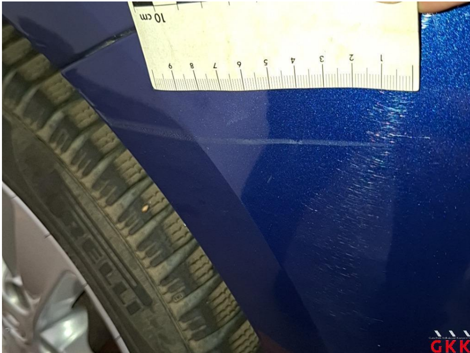
Bild 28 Stoßfänger hinten, Verkleidung -lackiert-, verkratzt, lackieren
