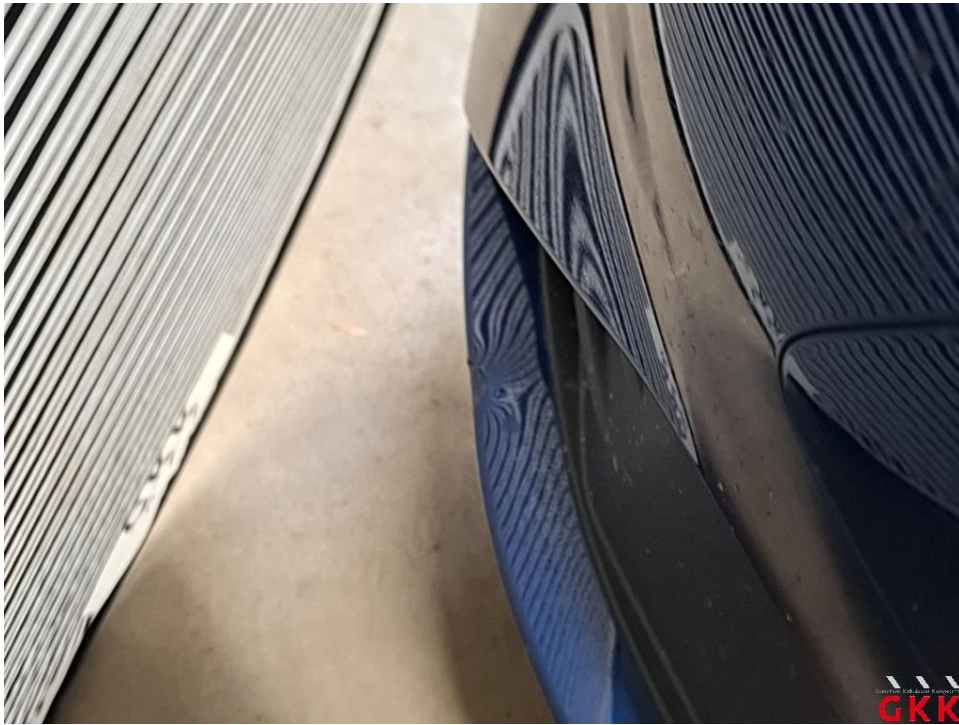
Bild 22 Stoßfänger vorne, Verkleidung -lackiert-, beschädigt, ersetzen
