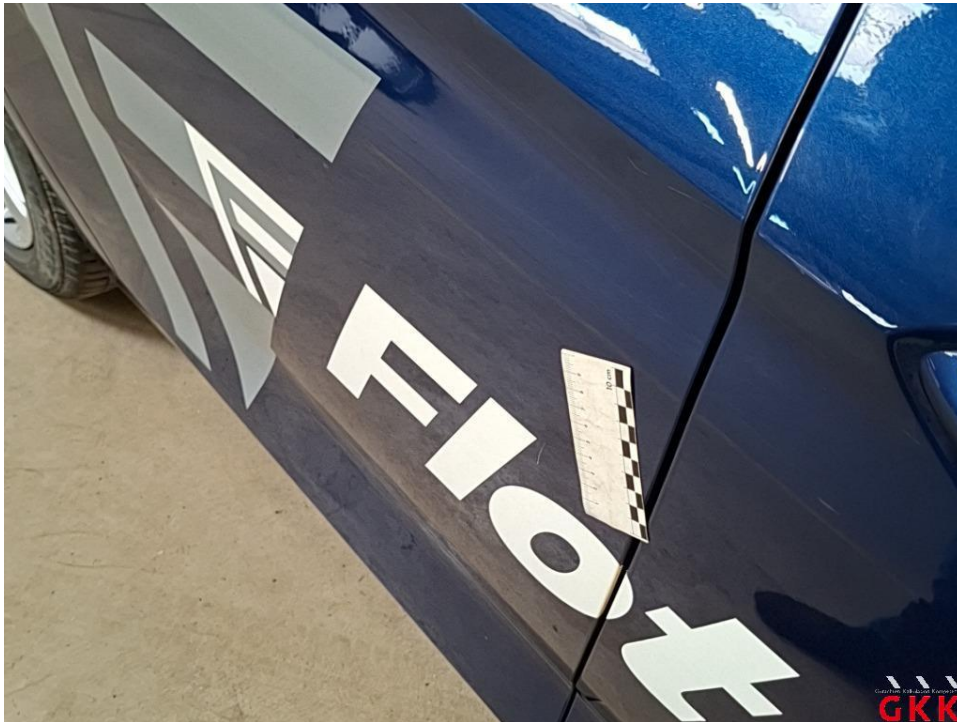
Bild 34 Tür hinten rechts, verkratzt, lackieren
