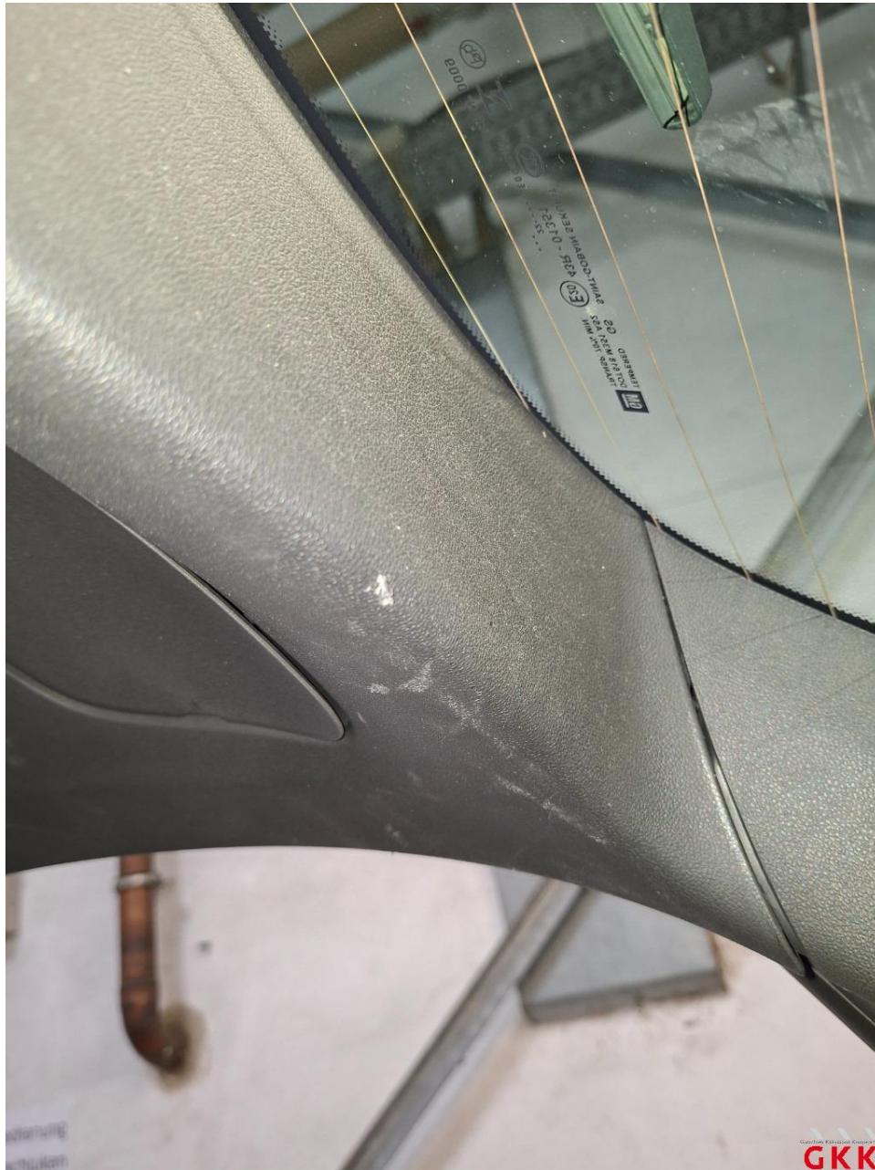
Bild 30 Heckklappe, Innenverkleidung, beschädigt, ersetzen
