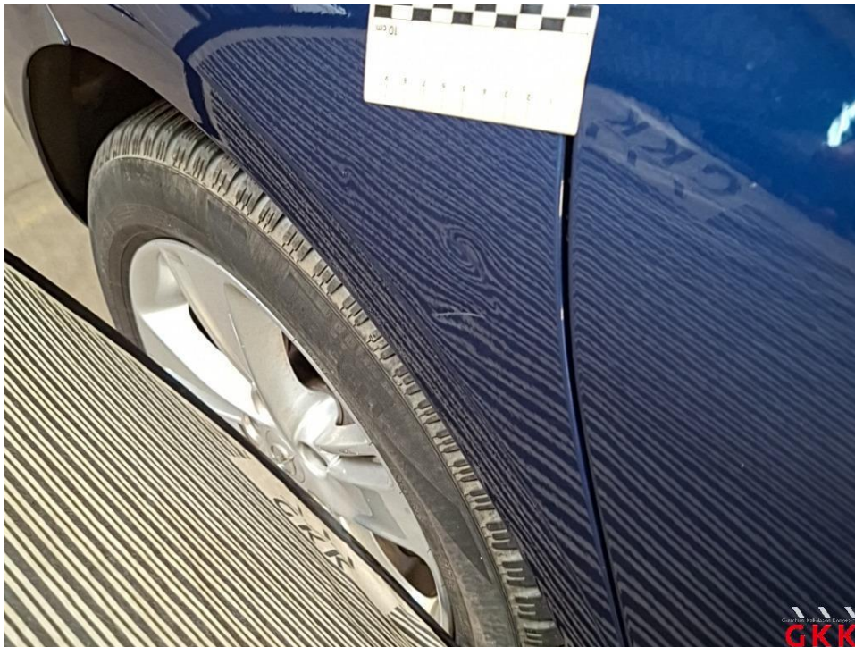
Bild 33 Seitenwand rechts, beschädigt, instand setzen - lackieren
