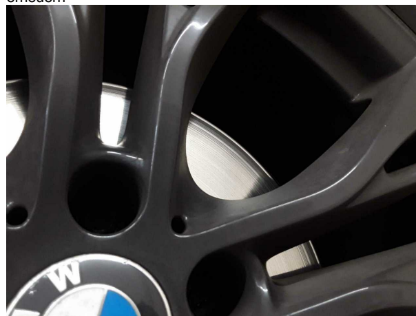
Beschädigung #4: Bremsanlage: Bremsscheiben vorn (Mehrkosten möglich) - verschlissen - erneuern
