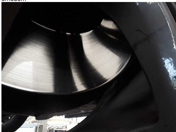
Beschädigung #4: Bremsanlage: Bremsscheiben vorn (Mehrkosten möglich) - verschlissen - erneuern
