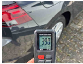
Lackstärke Seitenwand hinten rechts
