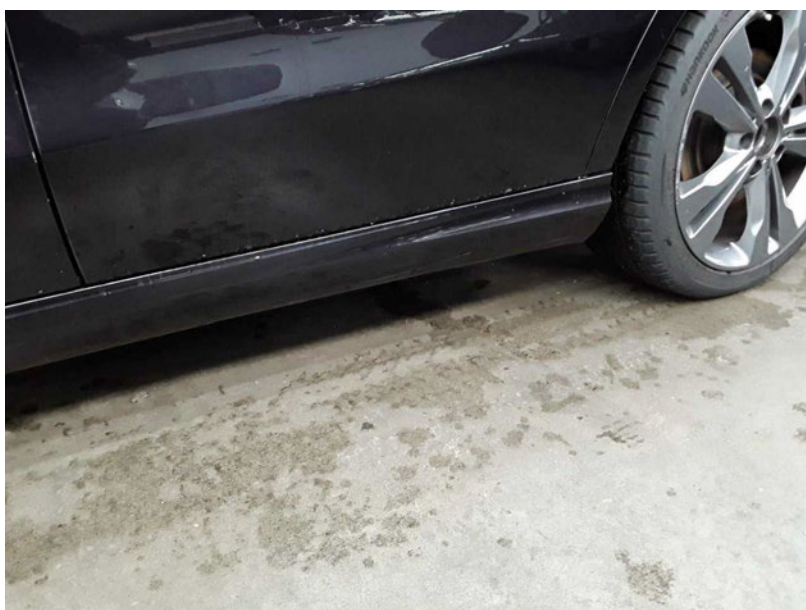
Beschädigung #10: Schweller links: Verkleidung - Kratzer - lackieren
