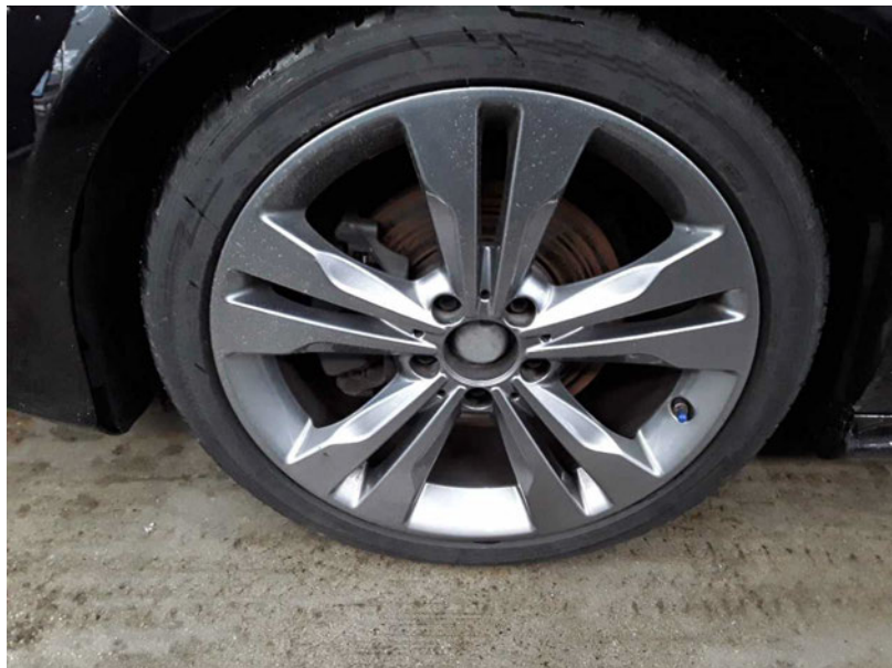
Beschädigung #3: Rad/Reifen: Raddeckel (4x) - fehlt - erneuern
