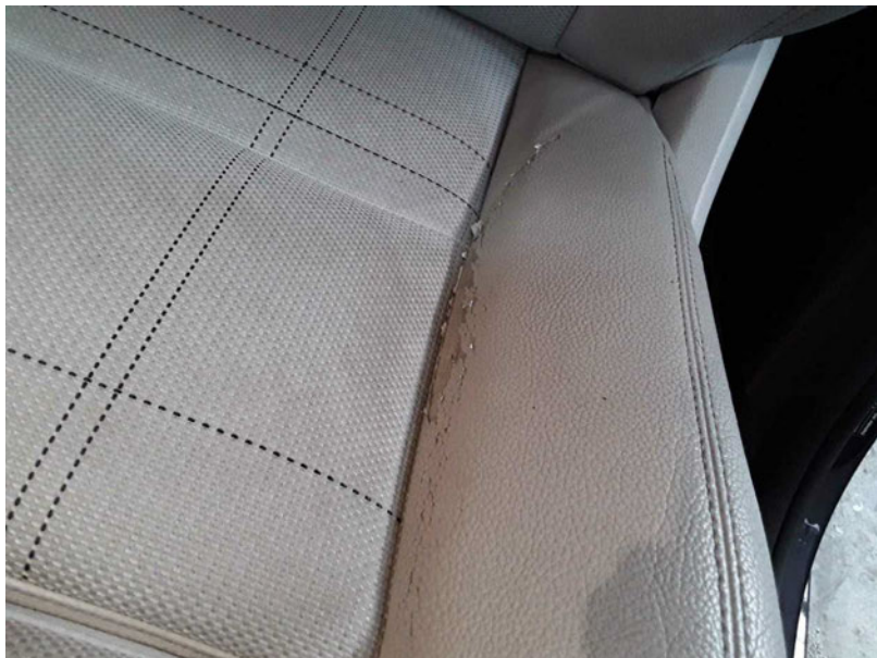
Beschädigung #9: Sitz vorn: Sitzbezug links - gebrochen / gerissen - erneuern
