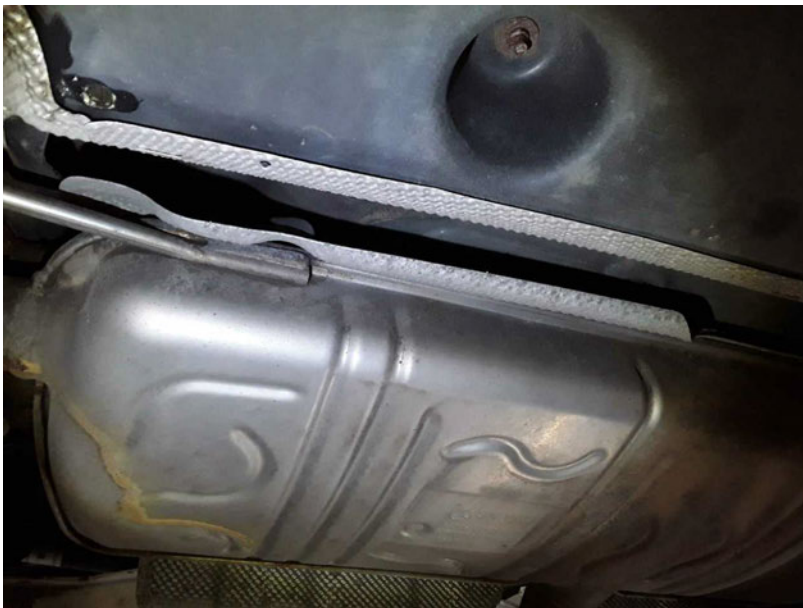
Beschädigung #6: Abgasanlage: Hitzblech (Endschalldämpfer) - gebrochen / gerissen - erneuern
