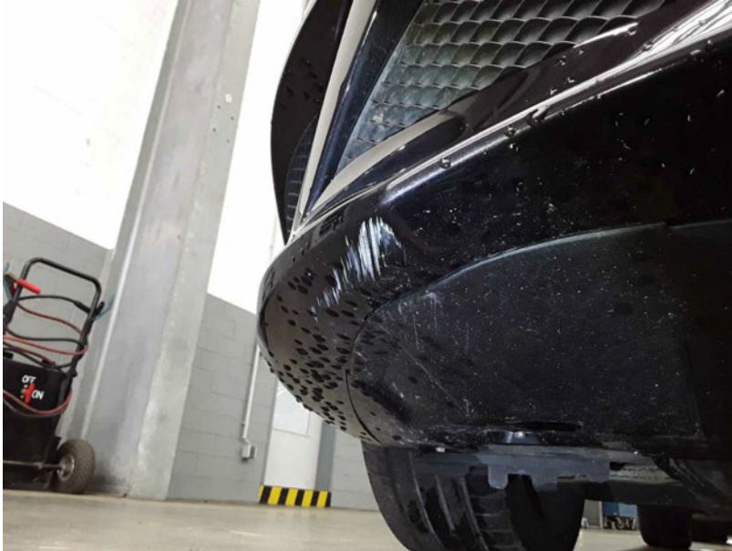
Beschädigung #5: Stossfänger vorn: Stossfänger mit Parktronic - Kratzer - Smart Repair
