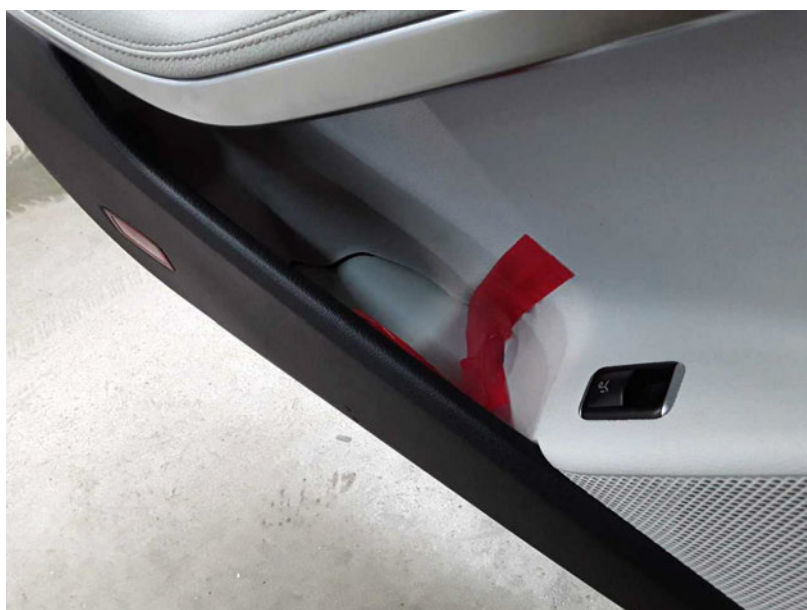
Beschädigung #16: Verkleidungen/Abdeckungen: Türverkleidung vorn links (Einlage) - fehlt - erneuern
