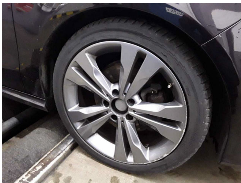
Beschädigung #11: Rad/Reifen: Leichtmetallfelge vorn rechts - verkratzt / verschürft - erneuern
