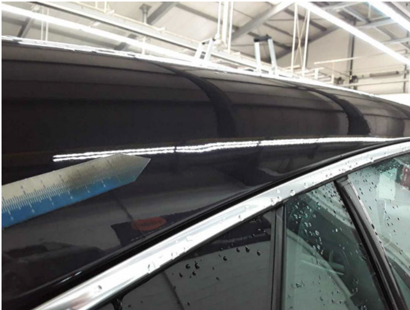
Beschädigung #4: Fahrzeugdach: Dachholm rechts - Delle(n) - Smart Repair
