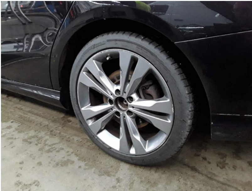
Beschädigung #13: Rad/Reifen: Leichtmetallfelge hinten links - verkratzt / verschürft - erneuern
