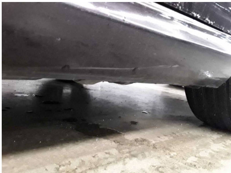
Beschädigung #10: Schweller links: Verkleidung - Kratzer - lackieren
