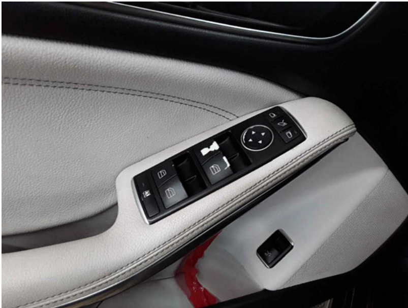
Beschädigung #8: Tür vorn links: Schaltereinheit - Abrieb - erneuern
