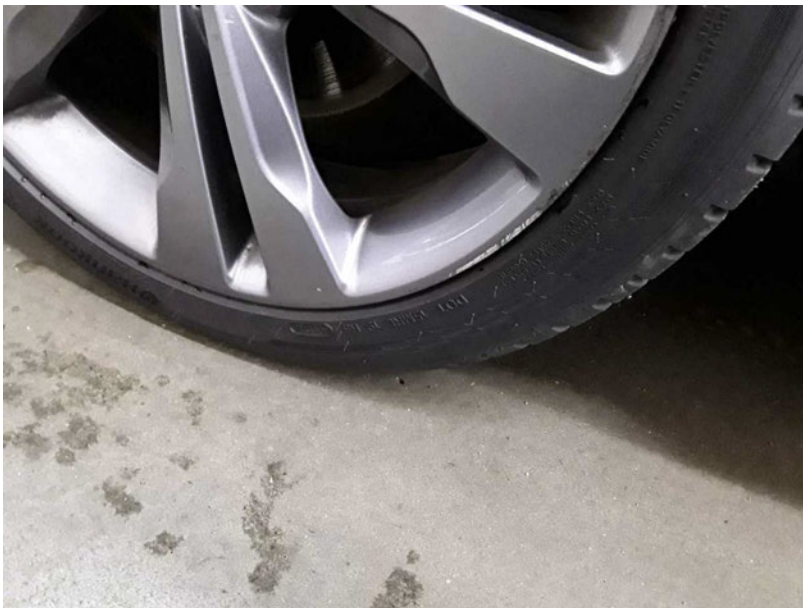
Beschädigung #12: Rad/Reifen: Leichtmetallfelge hinten rechts - verkratzt / verschürft - erneuern
