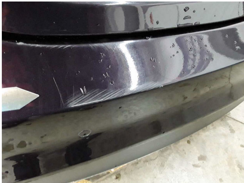
Beschädigung #15: Stossfänger hinten: Stossfänger mit Parktronic - Kratzer - lackieren
