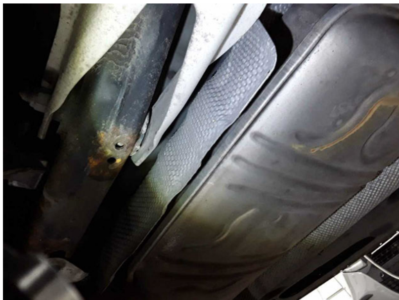
Beschädigung #6: Abgasanlage: Hitzblech (Endschalldämpfer) - gebrochen / gerissen - erneuern
