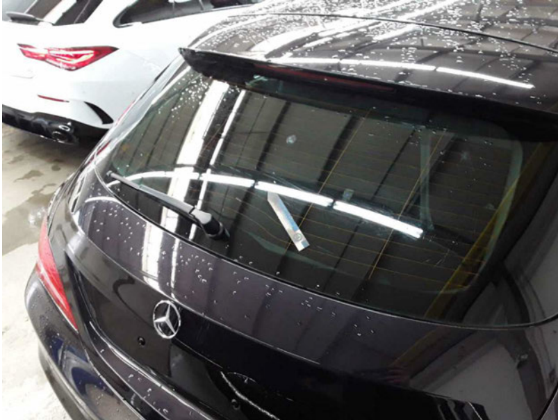
Beschädigung #17: Verglasung: Heckscheibe getönt - Kratzer - erneuern
