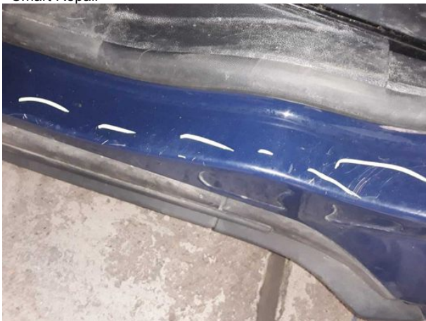
Beschädigung #6: Seitenwand links: Einstieg - verkratzt / verschürft - Smart Repair
