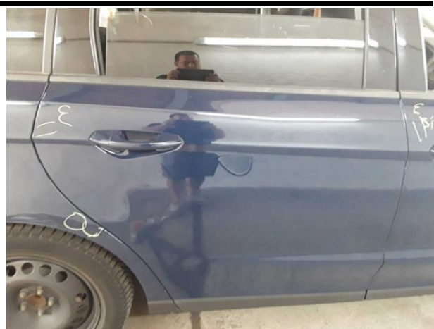
Beschädigung #12: Tür hinten rechts: Tür - verkratzt / verschürft - lackieren
