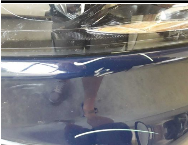
Beschädigung #11: Stossfänger vorn: Stossfänger vorn - verkratzt / verschürft - lackieren
