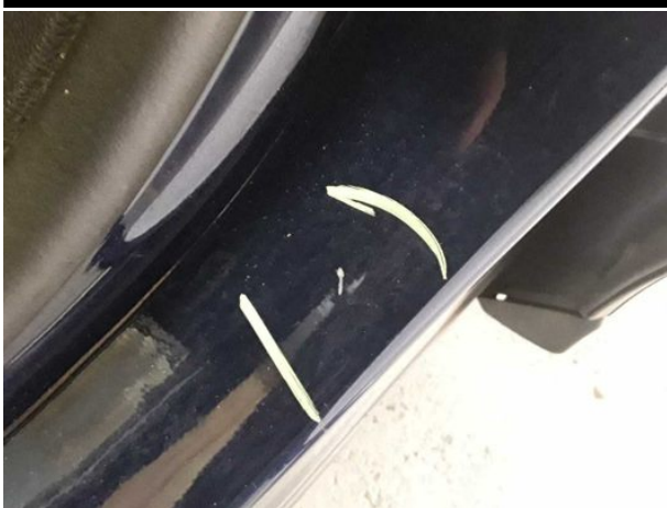
Beschädigung #5: Schweller links: Einstieg - verkratzt / verschürft - Smart Repair
