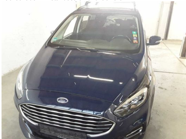
Beschädigung #17: Motorhaube: Motorhaube - verkratzt / verschürft - lackieren
