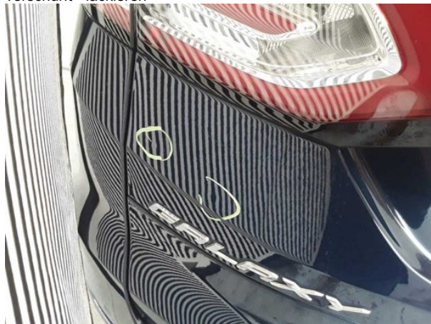
Beschädigung #18: Heckklappe/-tür: Heckklappe - Delle / Lackschaden - instandsetzen und lackieren
