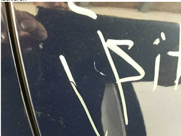
Beschädigung #13: Tür vorn rechts: Tür - verkratzt / verschürft - lackieren
