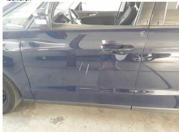
Beschädigung #14: Tür vorn links: Tür - verkratzt / verschürft - lackieren
