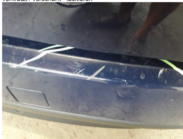
Beschädigung #10: Stossfänger hinten: Stossfänger hinten - verkratzt / verschürft - lackieren
