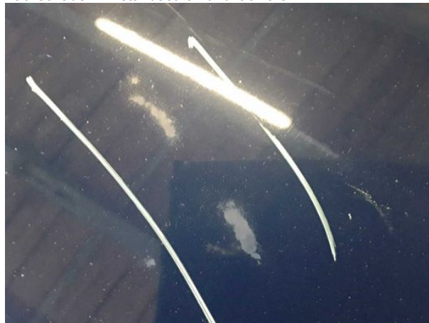
Beschädigung #17: Motorhaube: Motorhaube - verkratzt / verschürft - lackieren
