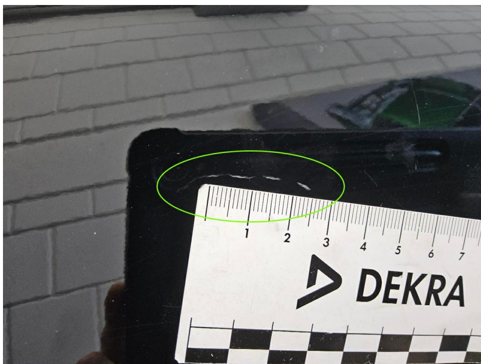
Bild 21 : Tür hinten rechts verschrammt
