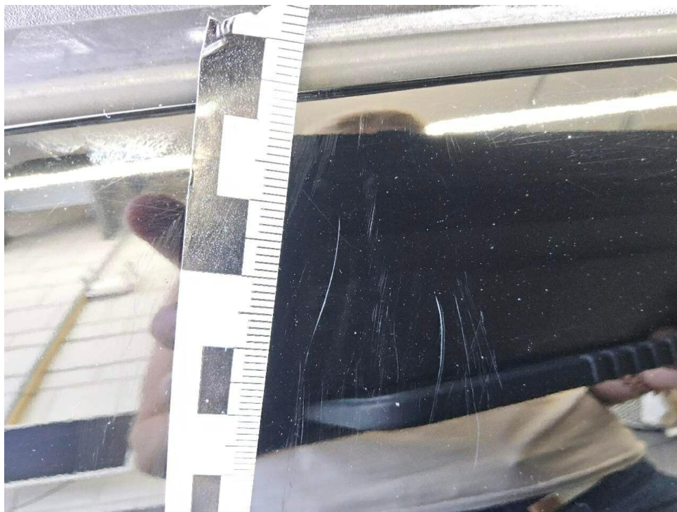
Bild 20 : Kotflügel vorn links verschrammt
