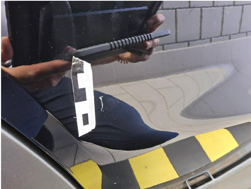
Bild 16 : Tür hinten rechts verschrammt
