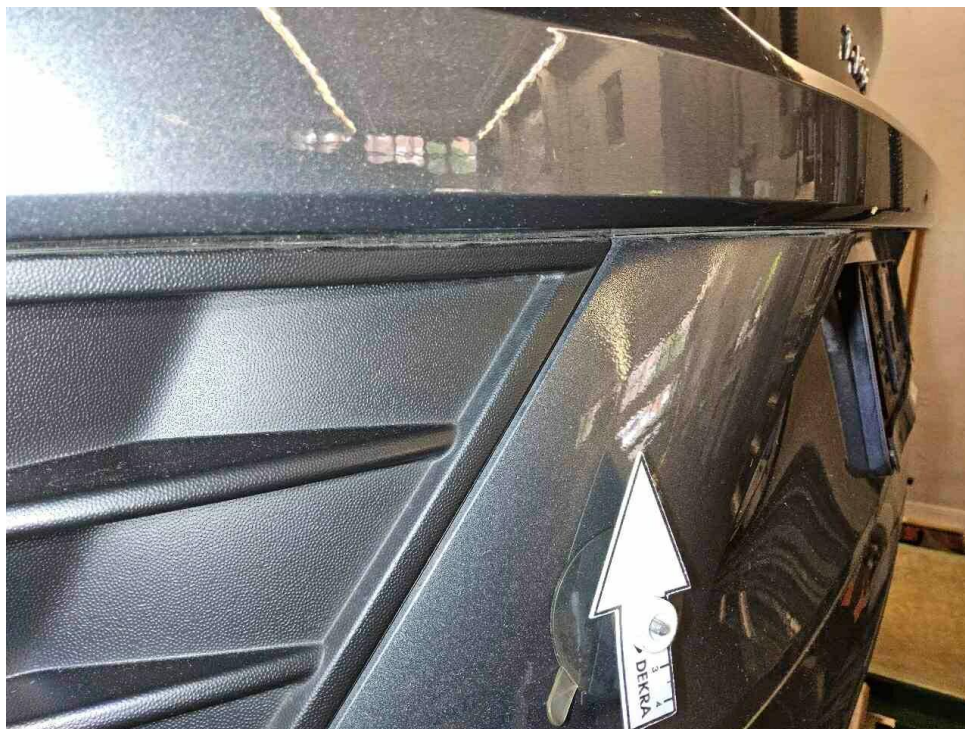
Bild 15 : Stoßfänger hinten, nicht fachgerecht lackiert (teilweise zu wenig Klarlack aufgetragen)
