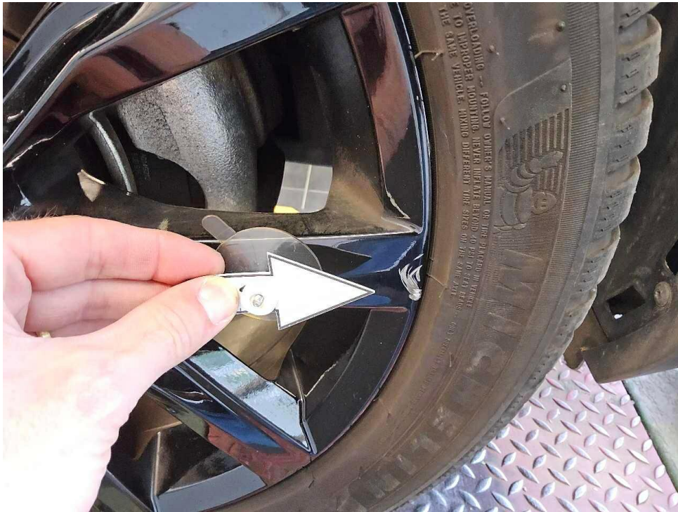
Bild 19 : Felge vorne rechts Lackierung, zerkratzt, smart repair
