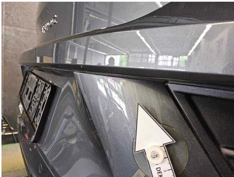
Bild 16 : Stoßfänger hinten, nicht fachgerecht lackiert (teilweise zu wenig Klarlack aufgetragen)
