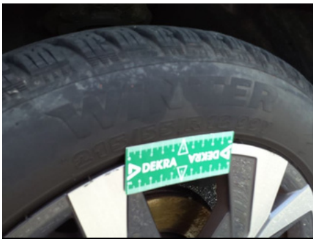
Pneu / Avant Gauche / Non Conforme
