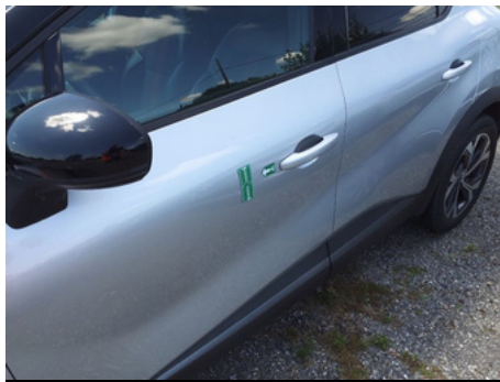
Porte / Avant Gauche / Enfoncement
