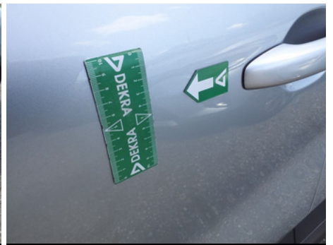
Porte / Avant Gauche / Enfoncement
