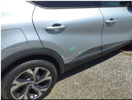
Porte / Arrière Droit / Enfoncement
