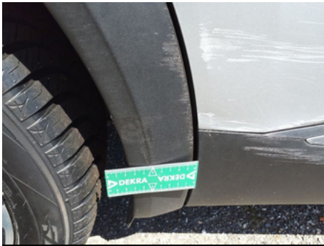
Extension d'aile / Arrière Droit / Rayure
