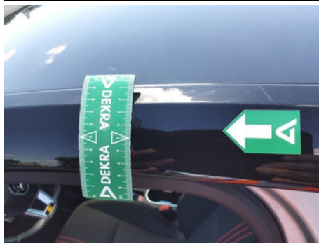
Montant de pavillon / Gauche / Enfoncement
