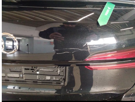
Heckklappe / Kofferraumtür / - / Kratzer
