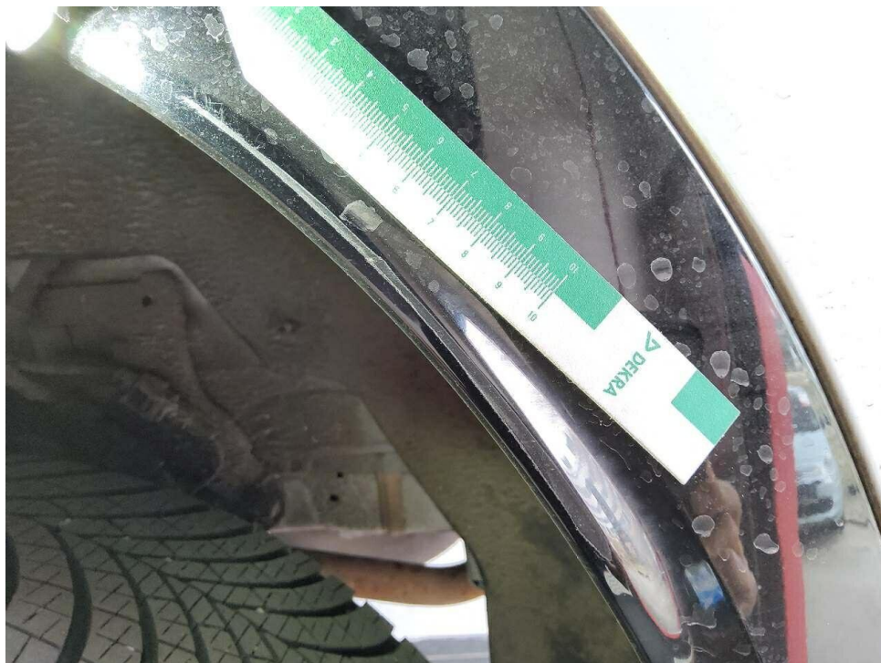
Bild 14 : Radlaufverkleidung hinten links verschrammt
