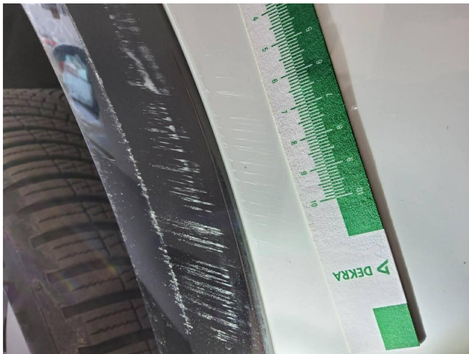
Bild 11 : Radlaufverkleidung vorn rechts verschrammt
