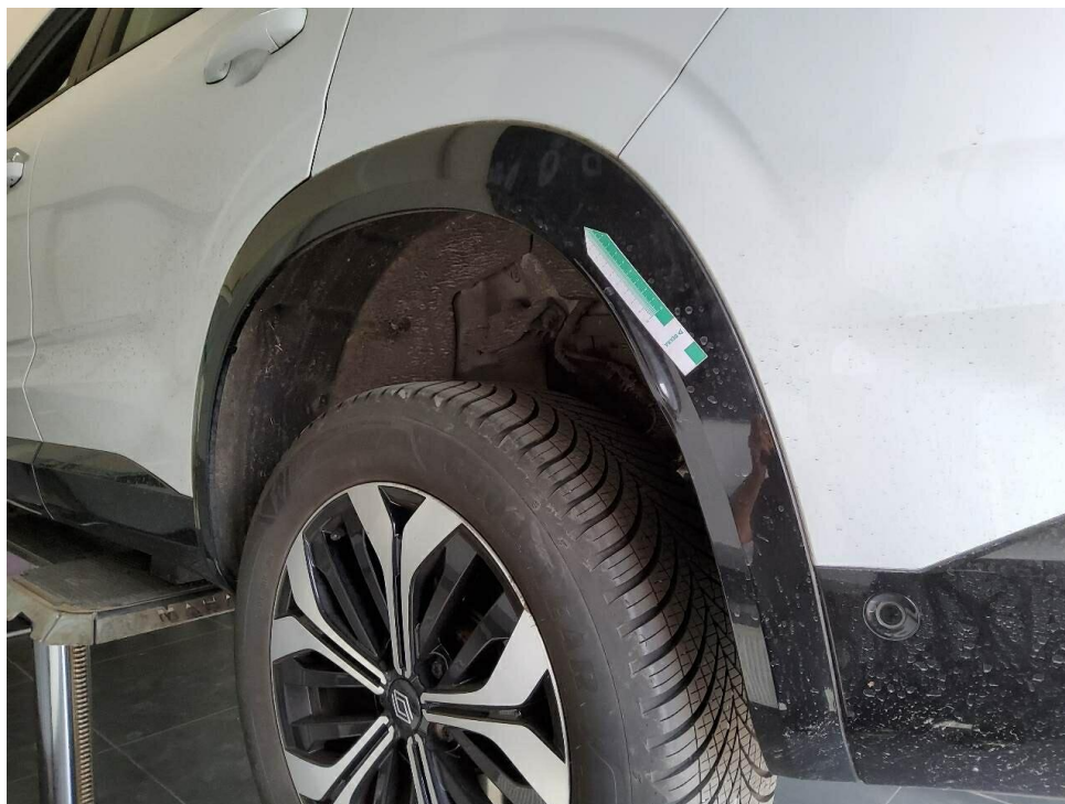
Bild 13 : Radlaufverkleidung hinten links verschrammt
