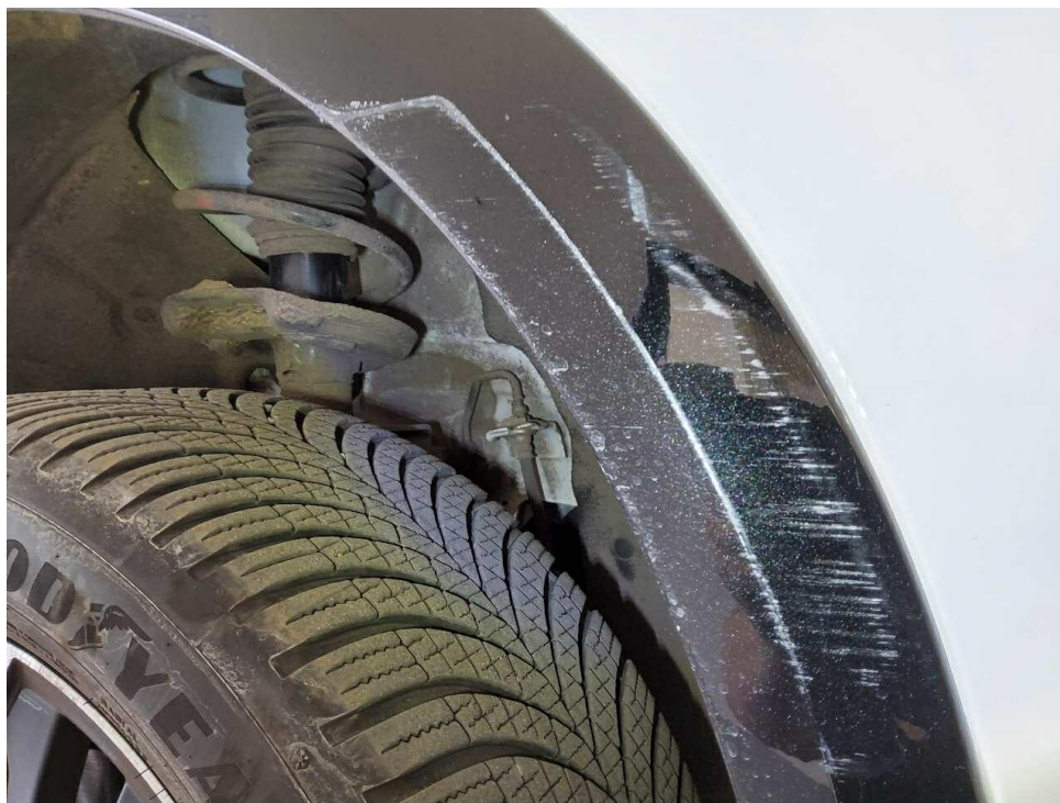
Bild 12 : Radlaufverkleidung vorn rechts verschrammt
