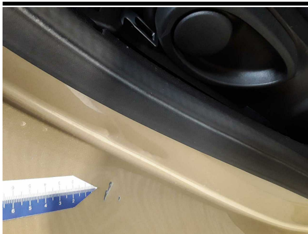
Beschädigung #3: Karosserie: B-Säule rechts unten - Delle / Lackschaden - Smart Repair
