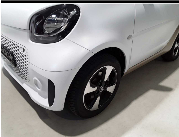
Beschädigung #8: Rad/Reifen: Leichtmetallfelge vorn links (Materialabrieb) - verkratzt / verschürft - erneuern
