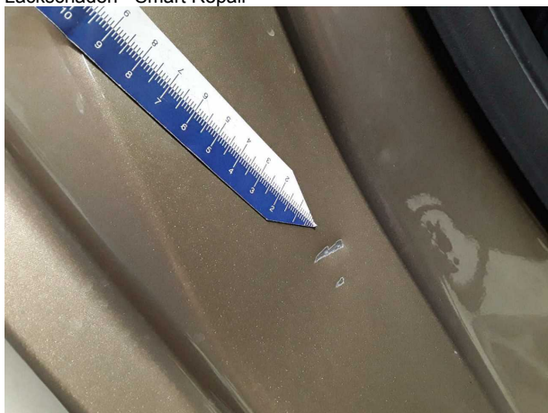
Beschädigung #3: Karosserie: B-Säule rechts unten - Delle / Lackschaden - Smart Repair
