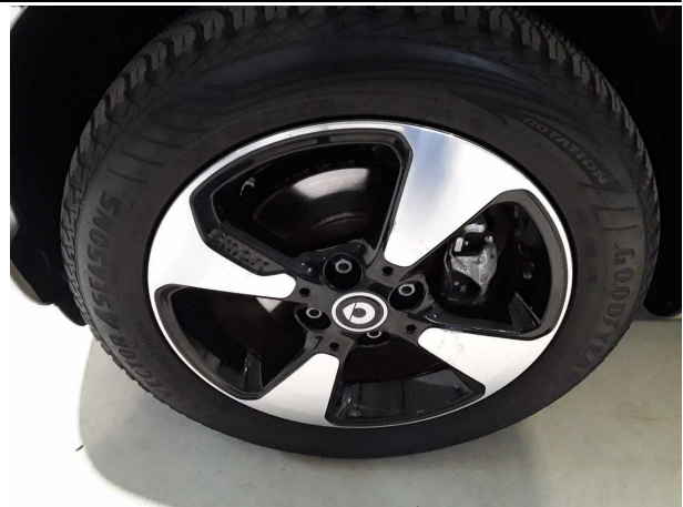
Beschädigung #8: Rad/Reifen: Leichtmetallfelge vorn links (Materialabrieb) - verkratzt / verschürft - erneuern
