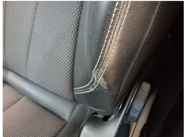
Beschädigung #7: Sitz vorn: Lehnenbezug links - beschädigt - erneuern
