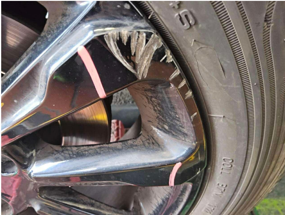
Bild 71 : Felge vorne links, verschrämmt, lackieren mit Lackaufbau
