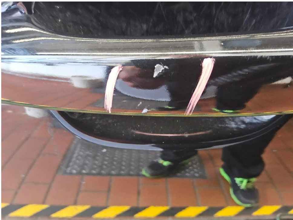
Bild 64 : Tür vorne links Türgriff, zerkratzt, lackieren mit Lackaufbau
