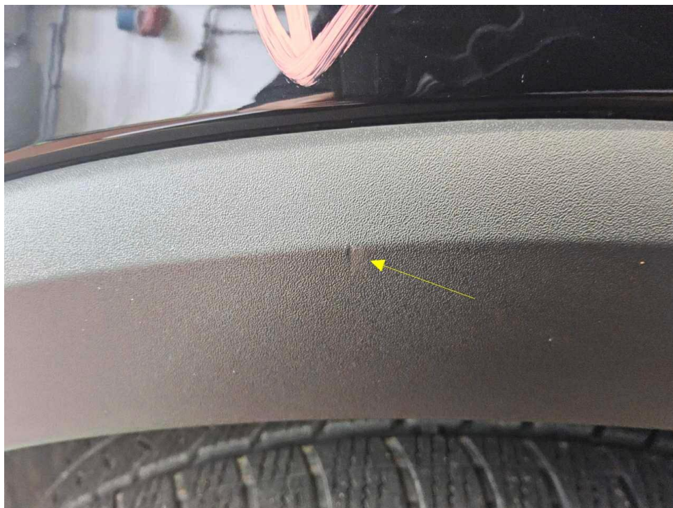
Bild 73 : Kotflügel vorne links Zierleiste, zerkratzt, Gebrauchsspur
