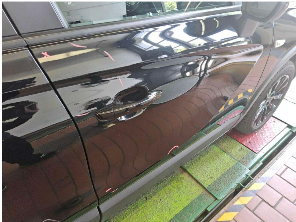
Bild 24 : Tür vorne rechts Lackierung, zerkratzt, lackieren mit Lackaufbau
