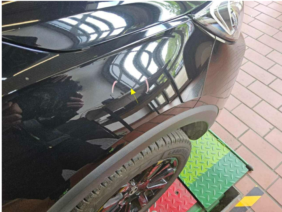
Bild 21 : Kotflügel vorne rechts Lackierung, zerkratzt, polieren
