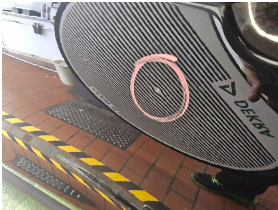
Bild 60 : Tür hinten links, eingedellt, instandsetzen und lackieren mit Lackaufbau
