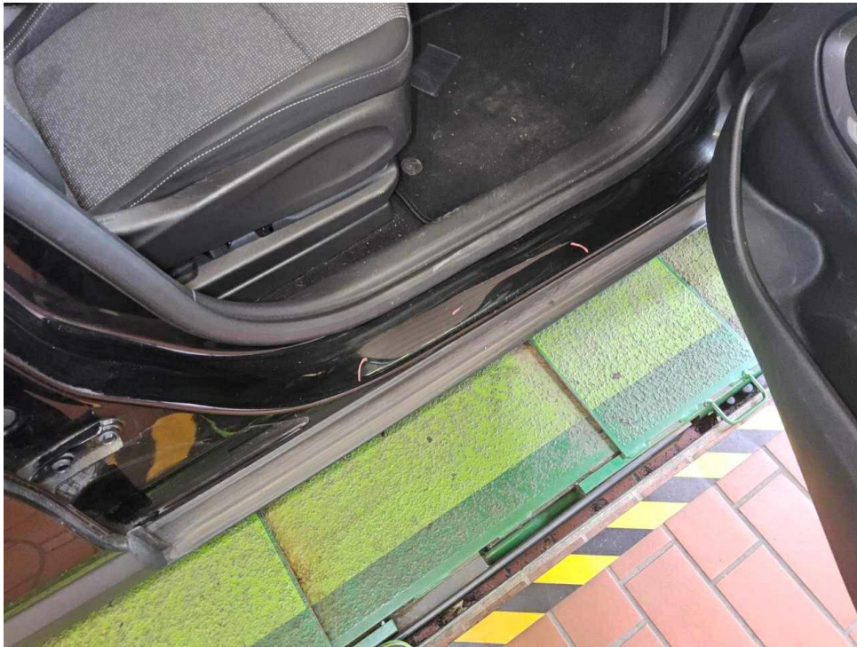
Bild 29 : Tür vorne rechts Einstieg Lackierung, zerkratzt, Gebrauchsspur
