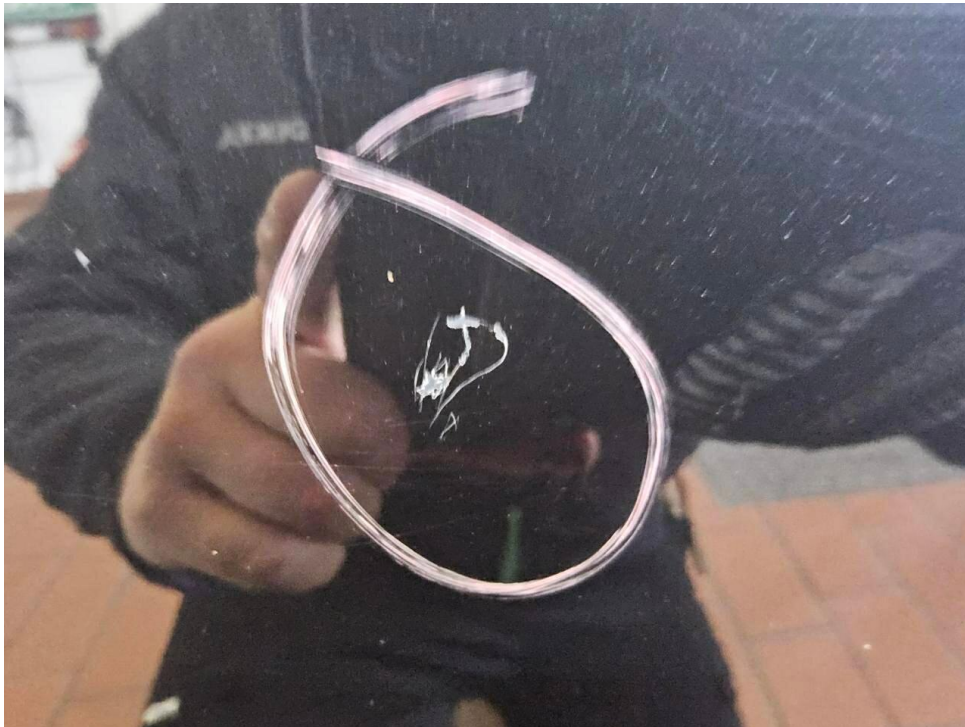
Bild 35 : Tür hinten rechts, eingedellt, instandsetzen und lackieren mit Lackaufbau
