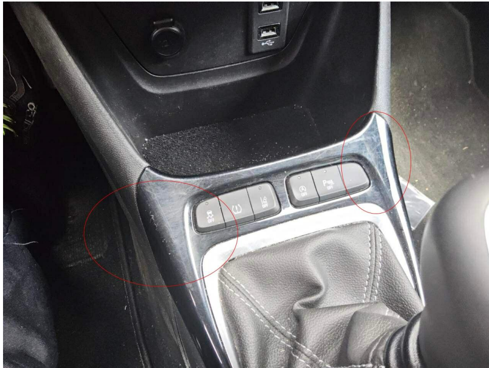
Bild 13 : Mittelkonsole unten, zerkratzt, Gebrauchsspur
