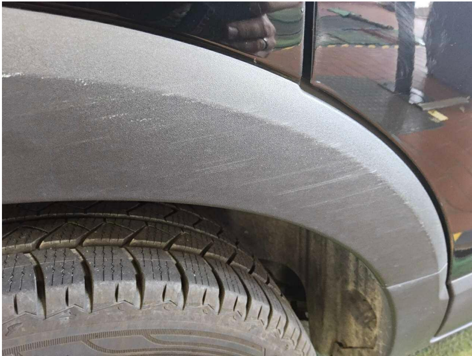
Bild 37 : Kotflügel hinten rechts Zierleiste, zerkratzt
