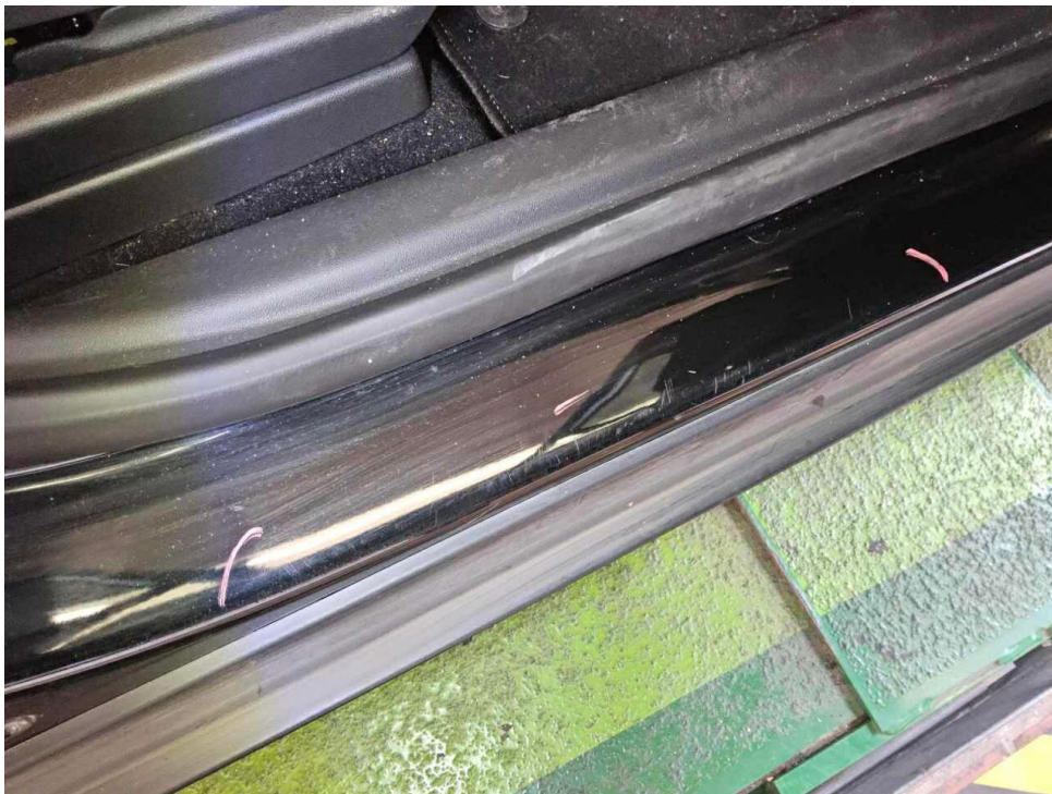
Bild 30 : Tür vorne rechts Einstieg Lackierung, zerkratzt, Gebrauchsspur
