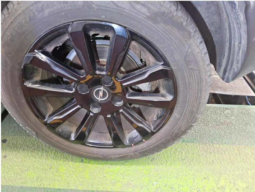
Bild 49 : Felge hinten links, verschrammt, lackieren mit Lackaufbau
