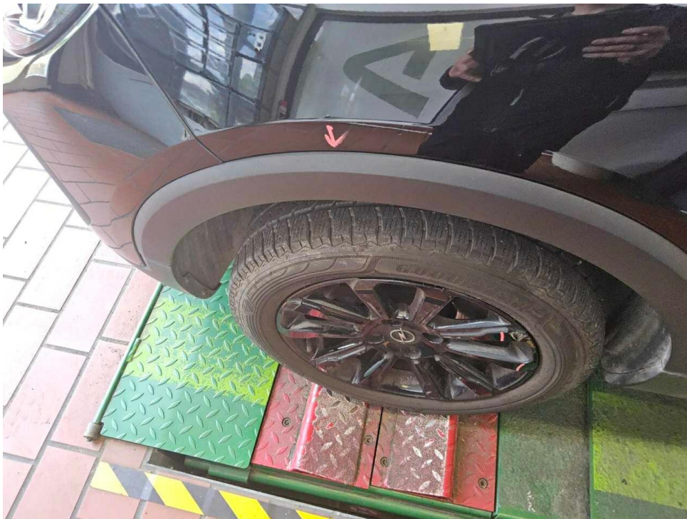
Bild 72 : Kotflügel vorne links Zierleiste, zerkratzt, Gebrauchsspur
