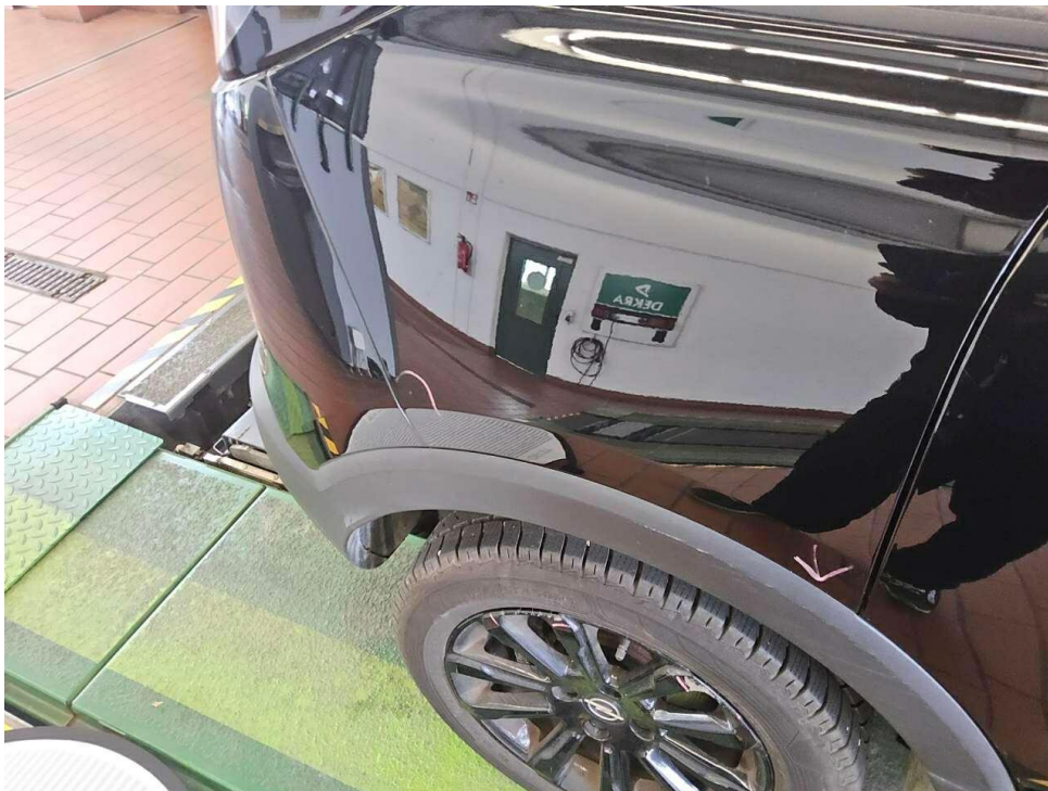
Bild 38 : Seitenteil hinten rechts, eingedellt, instandsetzen und lackieren mit Lackaufbau
