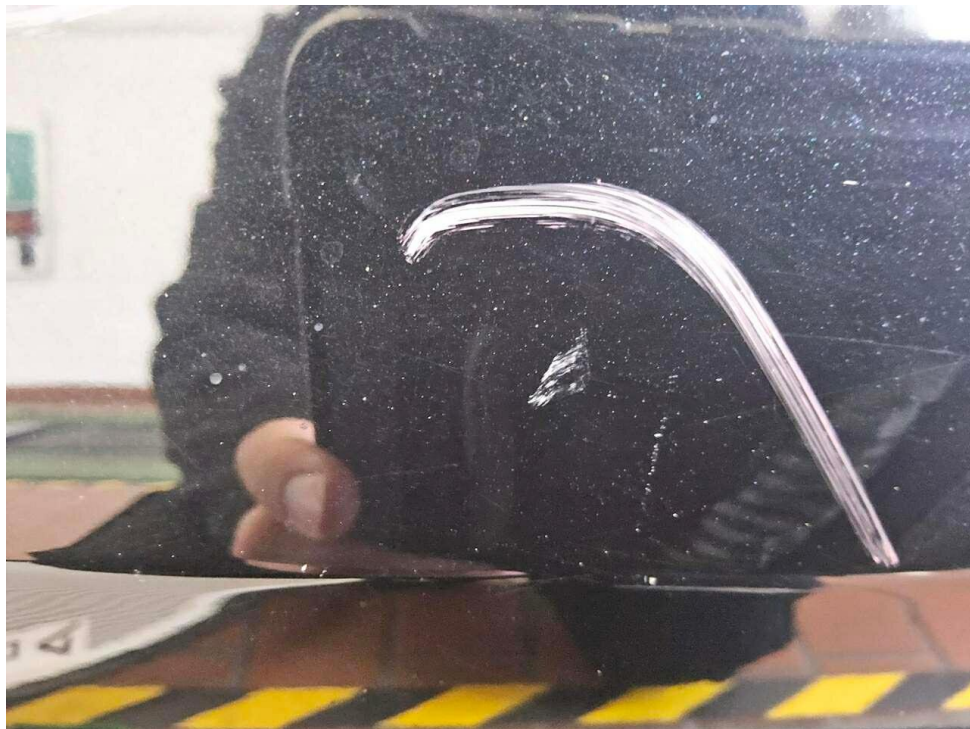
Bild 32 : Tür hinten rechts, eingedellt, instandsetzen und lackieren mit Lackaufbau
