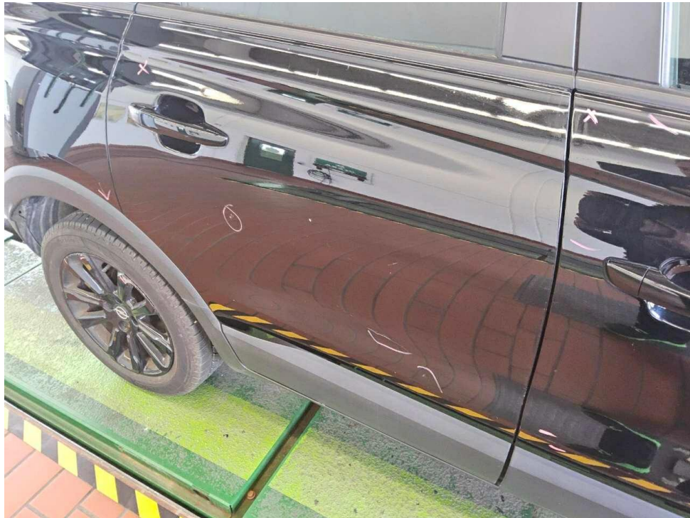
Bild 31 : Tür hinten rechts, eingedellt, instandsetzen und lackieren mit Lackaufbau
