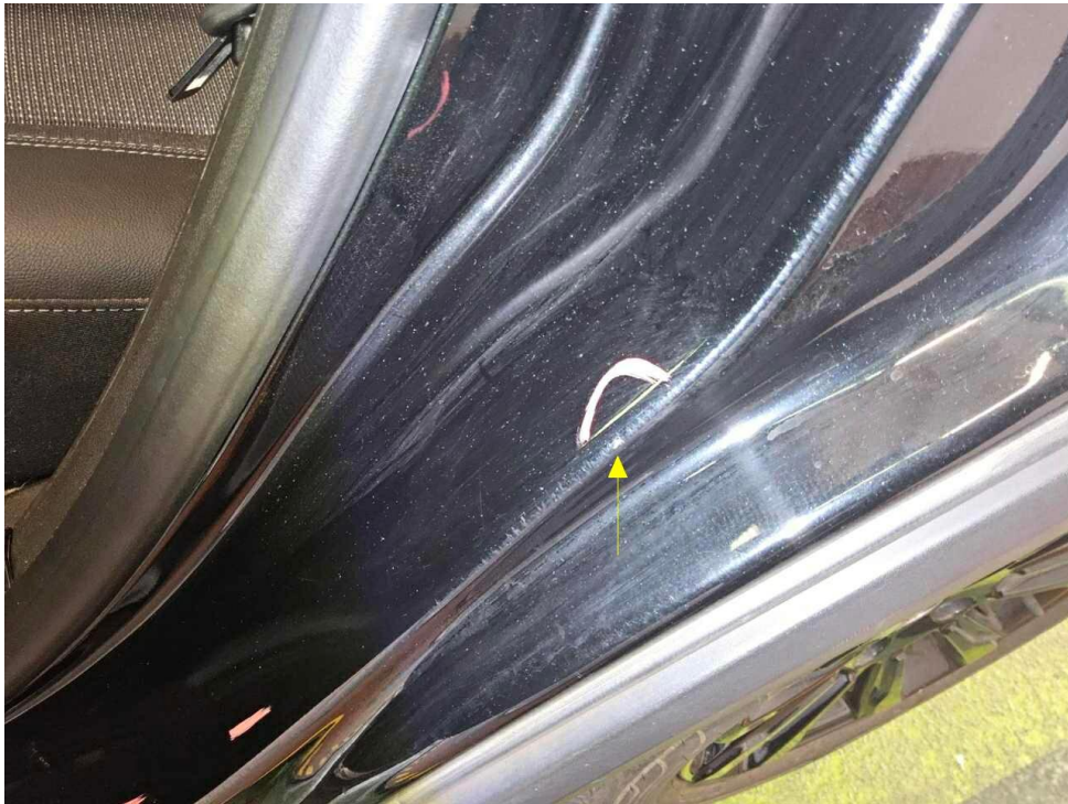
Bild 57 : Tür hinten links Einstieg Lackierung, zerkratzt, Gebrauchsspur
