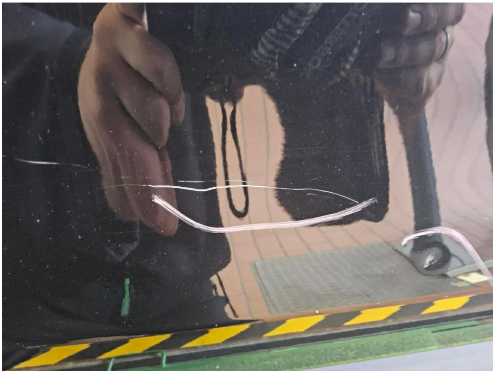
Bild 34 : Tür hinten rechts, eingedellt, instandsetzen und lackieren mit Lackaufbau
