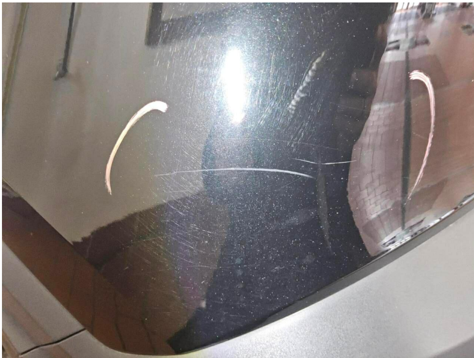
Bild 48 : Stoßfänger hinten Lackierung, zerkratzt, polieren
