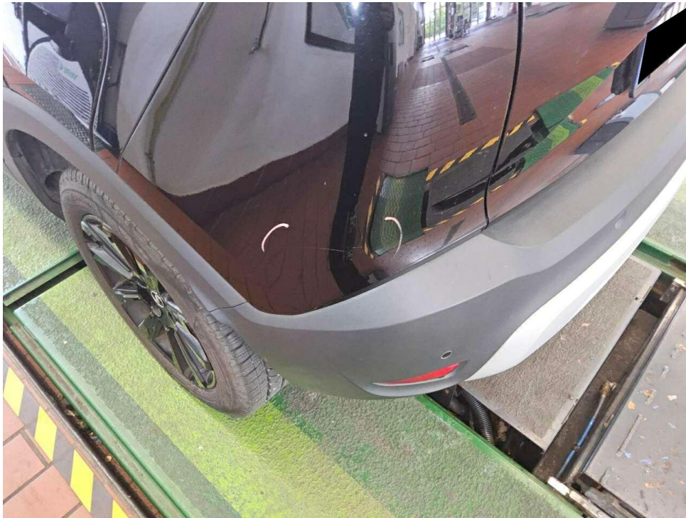
Bild 47 : Stoßfänger hinten Lackierung, zerkratzt, polieren
