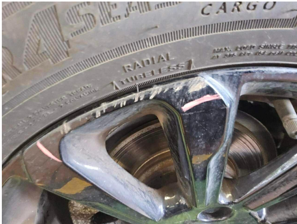
Bild 41 : Felge hinten rechts, zerkratzt, lackieren mit Lackaufbau
