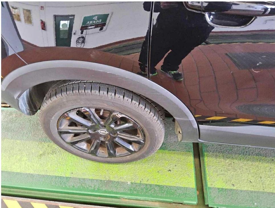
Bild 36 : Kotflügel hinten rechts Zierleiste, zerkratzt
