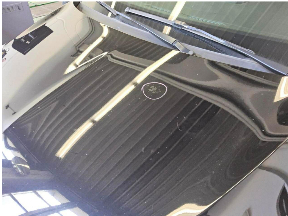
Bild 18 : Motorhaube Lackierung, Umweltschaden, polieren
