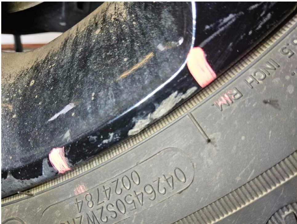
Bild 50 : Felge hinten links, verschrammt, lackieren mit Lackaufbau
