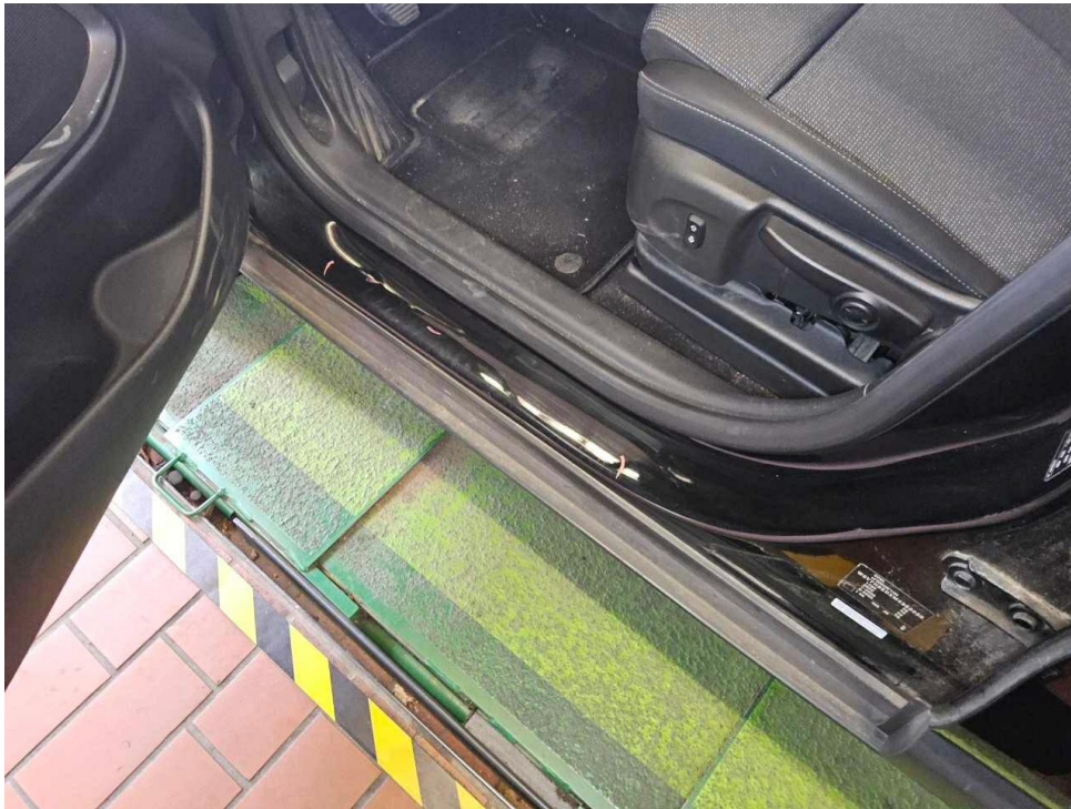
Bild 61 : Tür vorne links Einstieg Lackierung, zerkratzt, Gebrauchsspur
