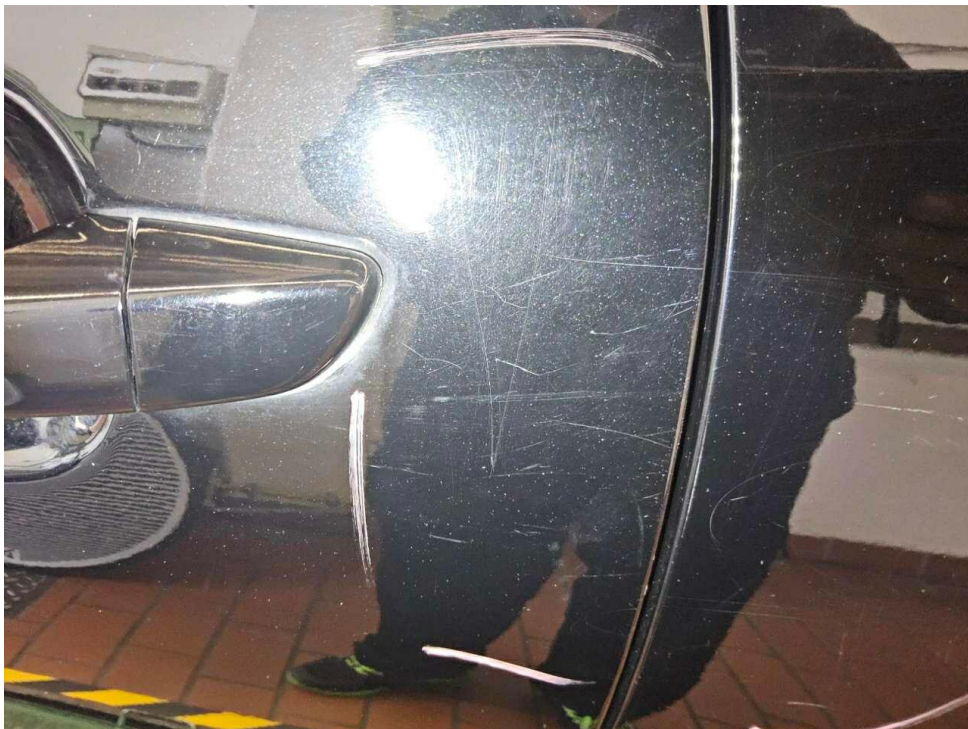
Bild 58 : Tür hinten links, eingedellt, instandsetzen und lackieren mit Lackaufbau
