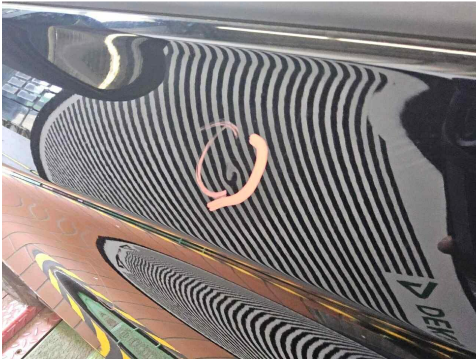
Bild 69 : Tür vorne links, eingedellt, instandsetzen und lackieren mit Lackaufbau
