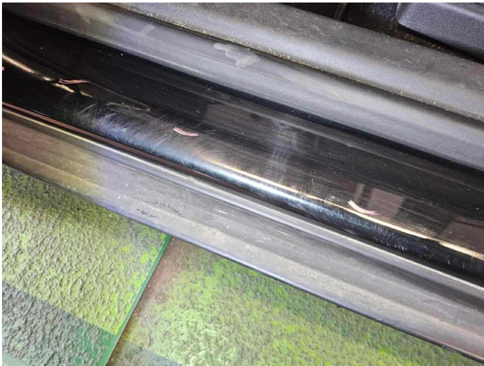
Bild 62 : Tür vorne links Einstieg Lackierung, zerkratzt, Gebrauchsspur
