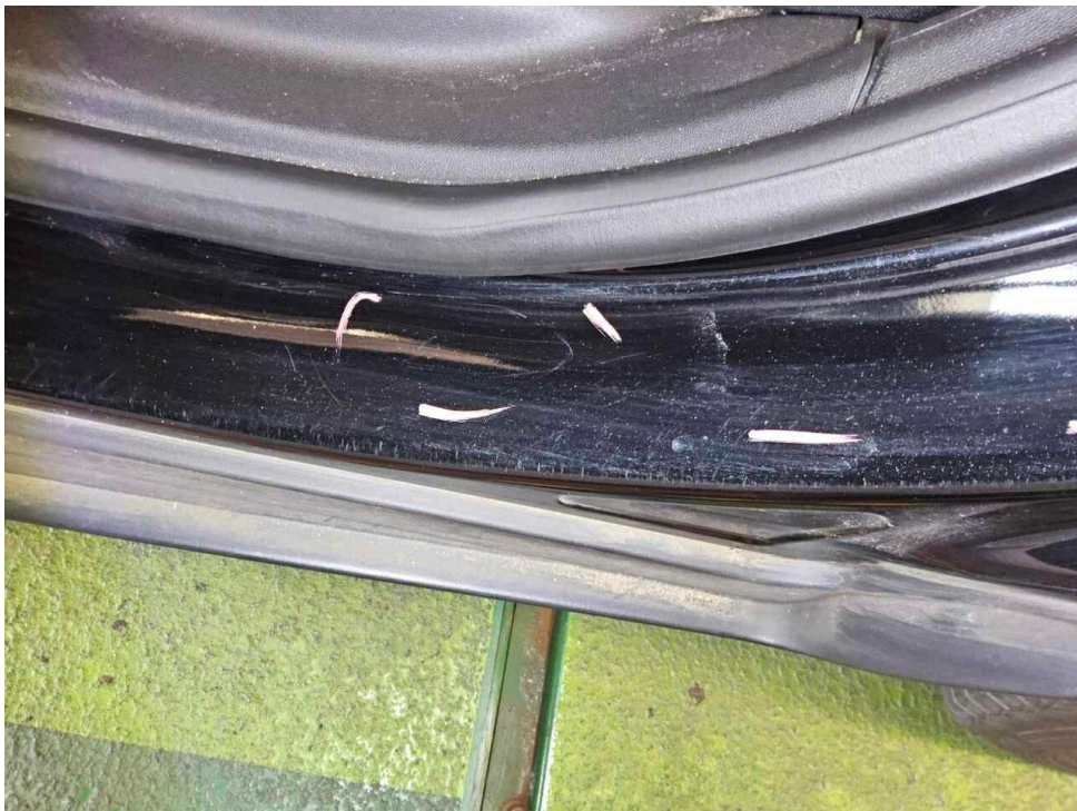
Bild 56 : Tür hinten links Einstieg Lackierung, zerkratzt, Gebrauchsspur
