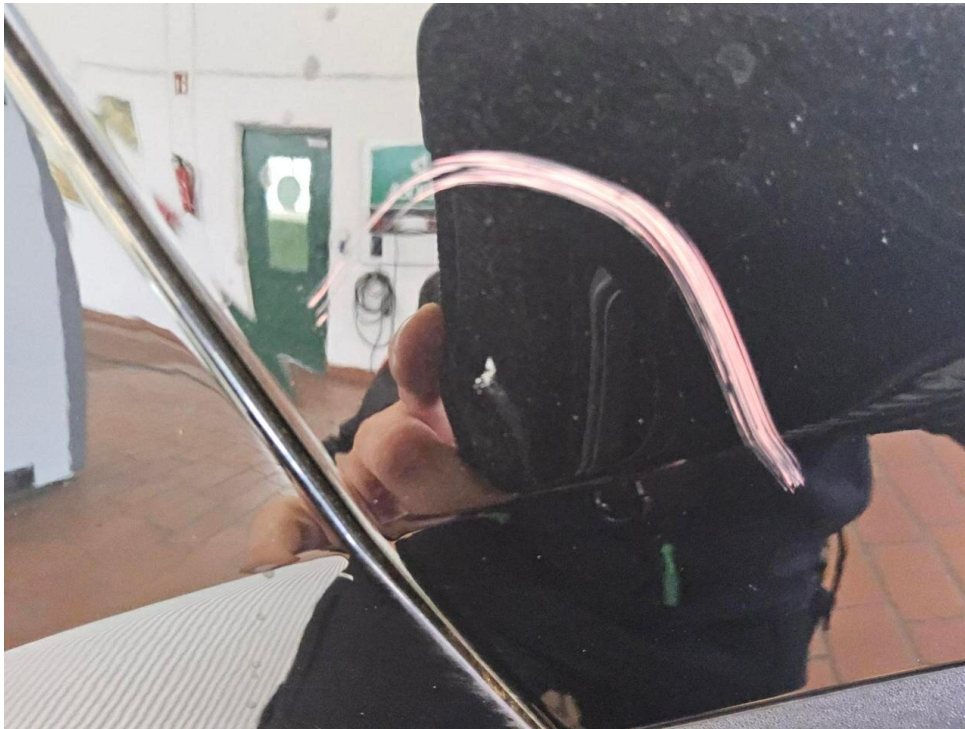
Bild 39 : Seitenteil hinten rechts, eingedellt, instandsetzen und lackieren mit Lackaufbau
