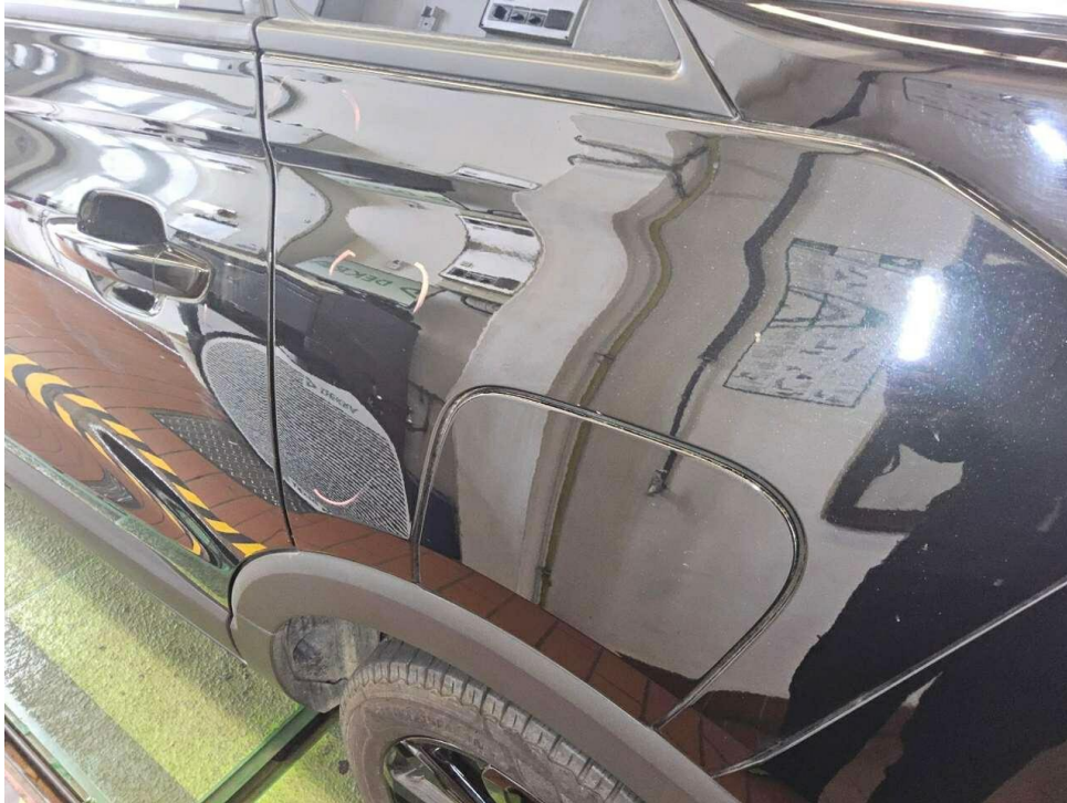
Bild 51 : Seitenteil hinten links Lackierung, zerkratzt, lackieren mit Lackaufbau
