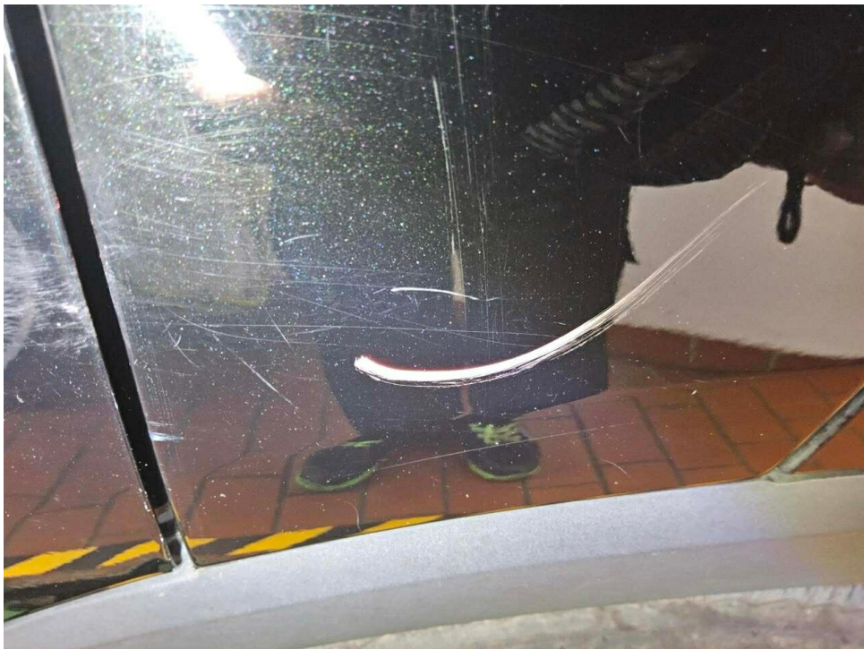
Bild 52 : Seitenteil hinten links Lackierung, zerkratzt, lackieren mit Lackaufbau
