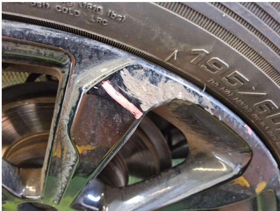
Bild 42 : Felge hinten rechts, zerkratzt, lackieren mit Lackaufbau
