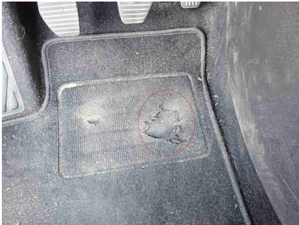
Bild 14 : Fußmatte vorne links, eingerissen
