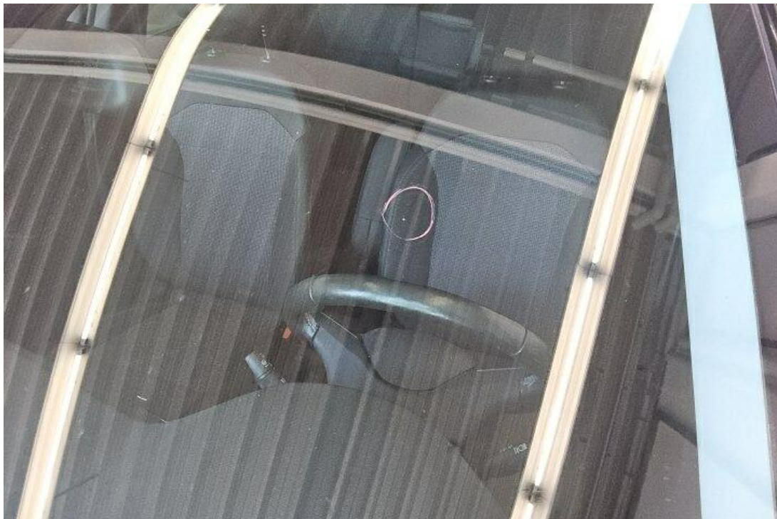
Bild 16 : Frontscheibe, Steinschlag, Gebrauchsspur
