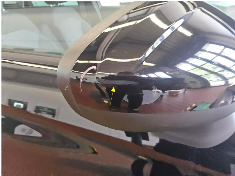
Bild 23 : Außenspiegel rechts Lackierung, zerkratzt, polieren
