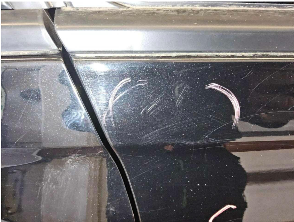
Bild 54 : Seitenteil hinten links Lackierung, zerkratzt, lackieren mit Lackaufbau
