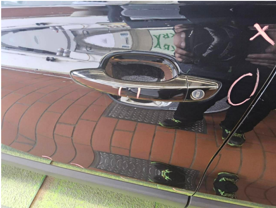
Bild 63 : Tür vorne links Türgriff, zerkratzt, lackieren mit Lackaufbau
