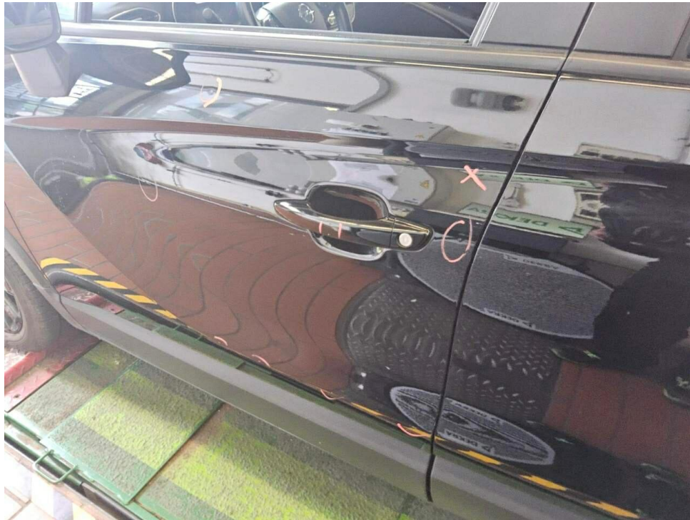
Bild 65 : Tür vorne links, eingedellt, instandsetzen und lackieren mit Lackaufbau
