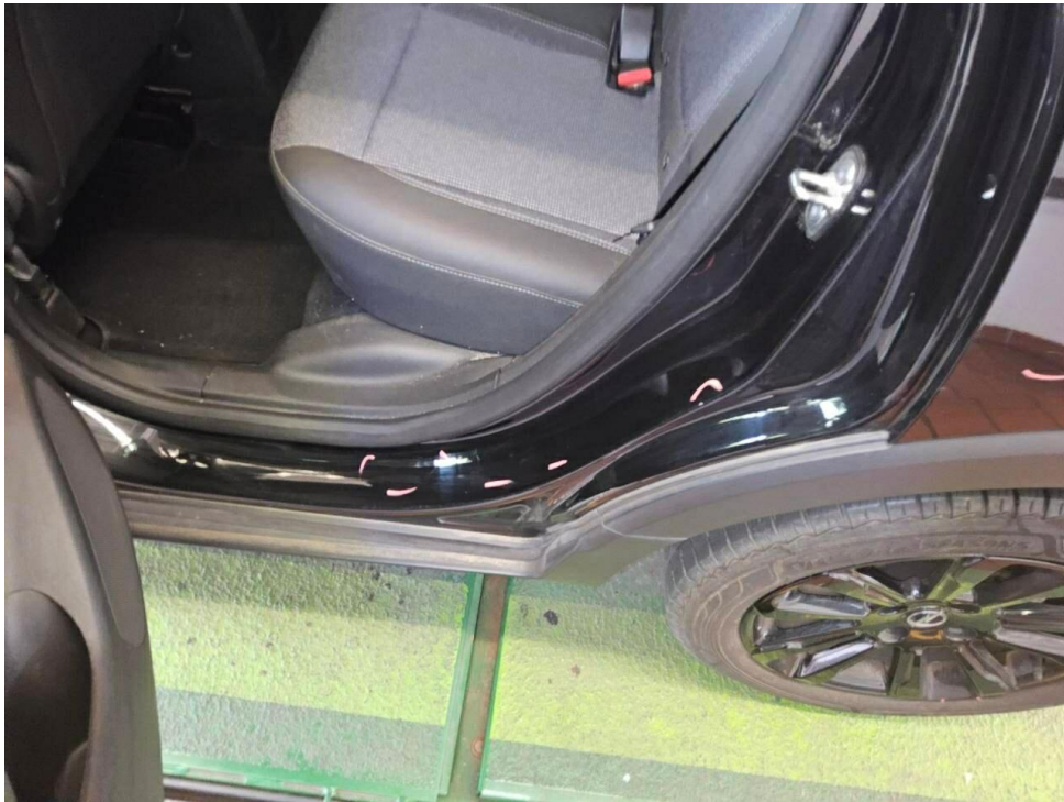
Bild 55 : Tür hinten links Einstieg Lackierung, zerkratzt, Gebrauchsspur
