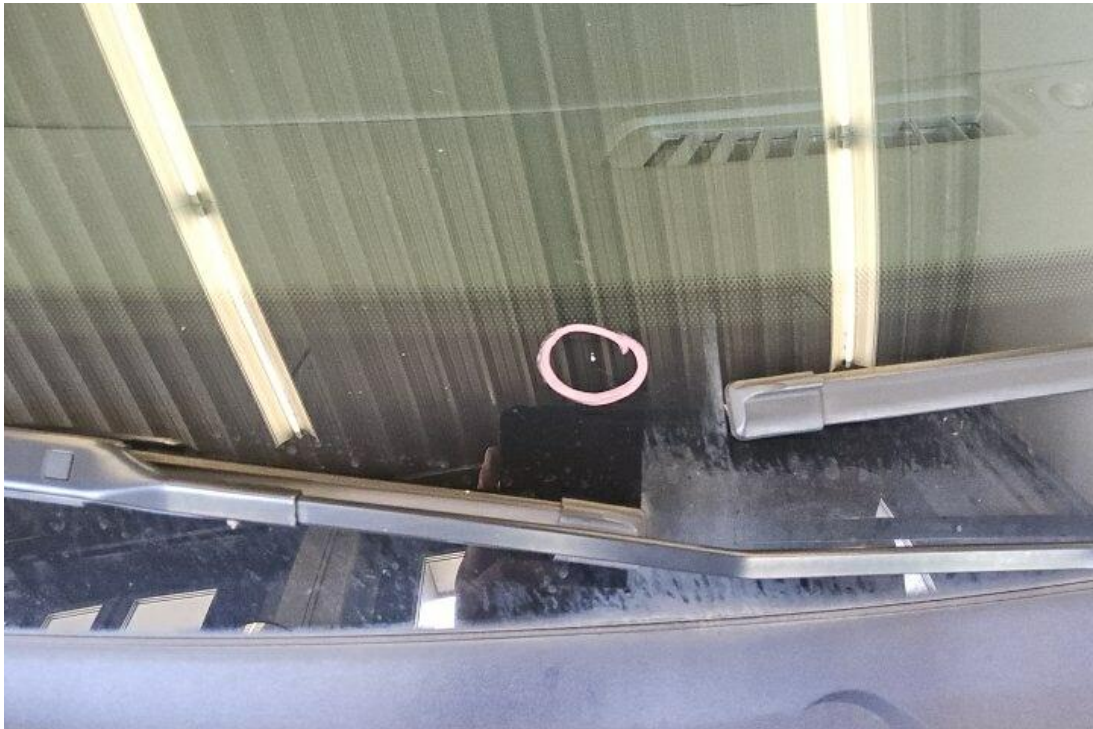
Bild 17 : Frontscheibe, Steinschlag, Gebrauchsspur
