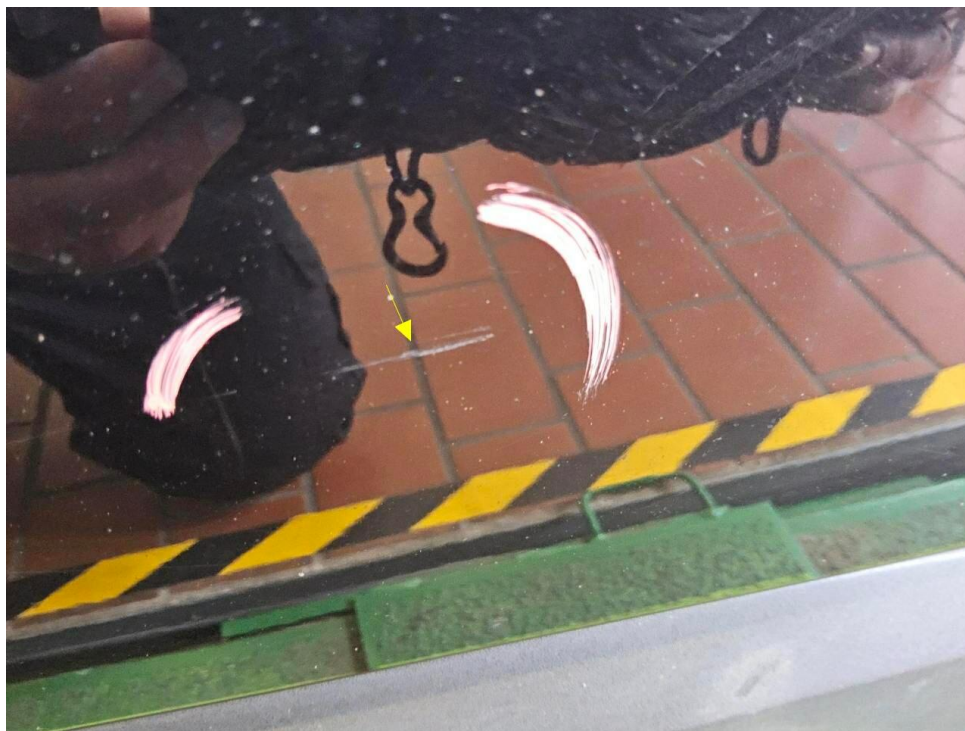
Bild 26 : Tür vorne rechts Lackierung, zerkratzt, lackieren mit Lackaufbau
