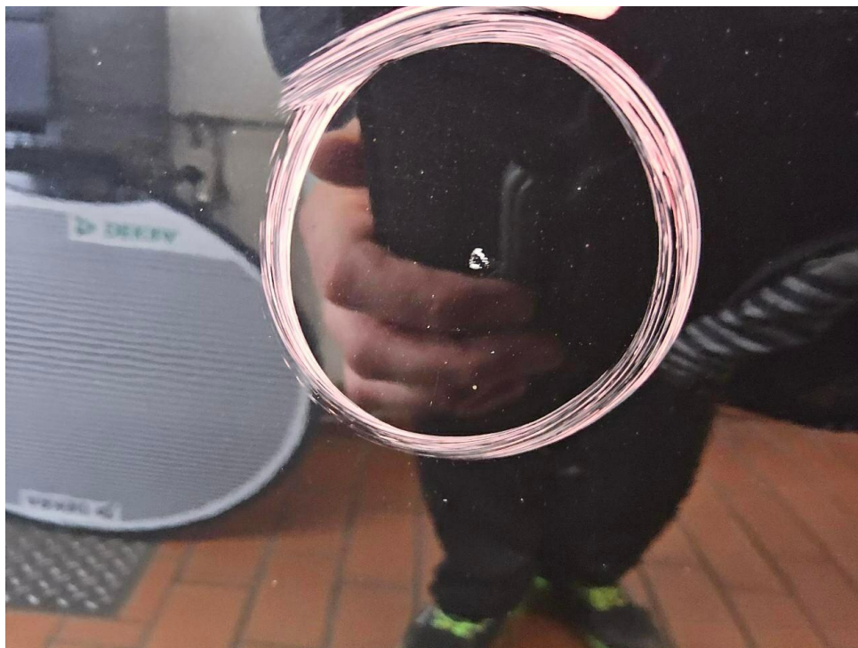
Bild 59 : Tür hinten links, eingedellt, instandsetzen und lackieren mit Lackaufbau
