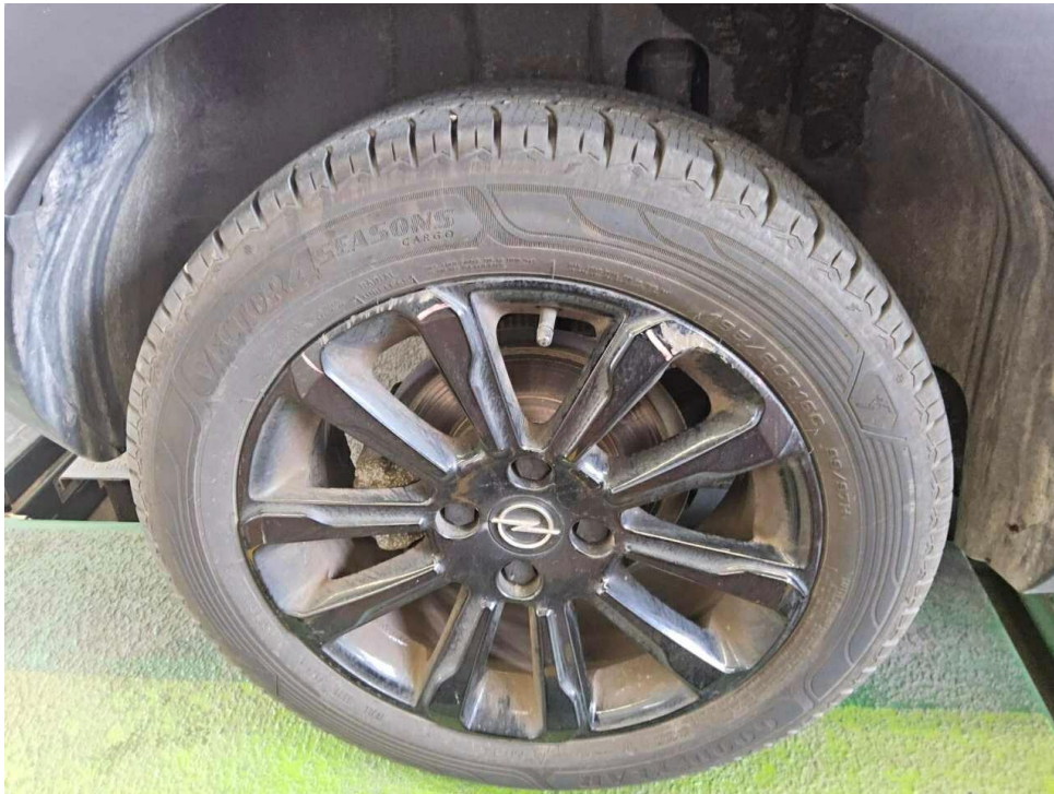
Bild 43 : Felge hinten rechts, zerkratzt, lackieren mit Lackaufbau
