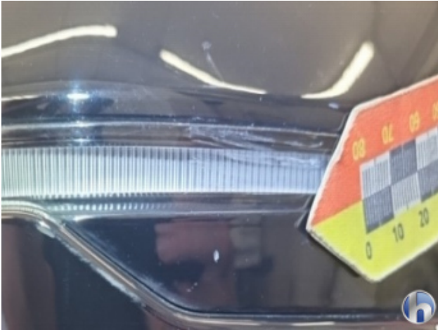
7. Außenspiegel Beheizt Blinker - Rechts Beschädigt - Erneuern
