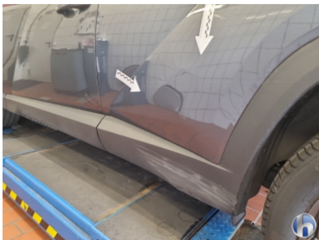
2. Tür Hinten - Links Beschädigt - Siehe Kalkulation
