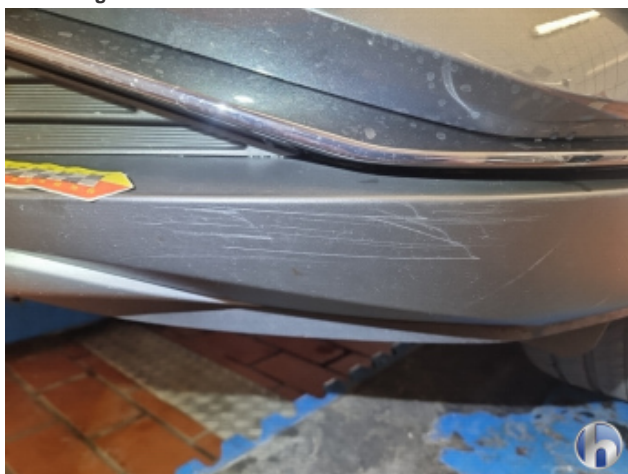
3. Frontspoiler Kratzer - Smart Repair
