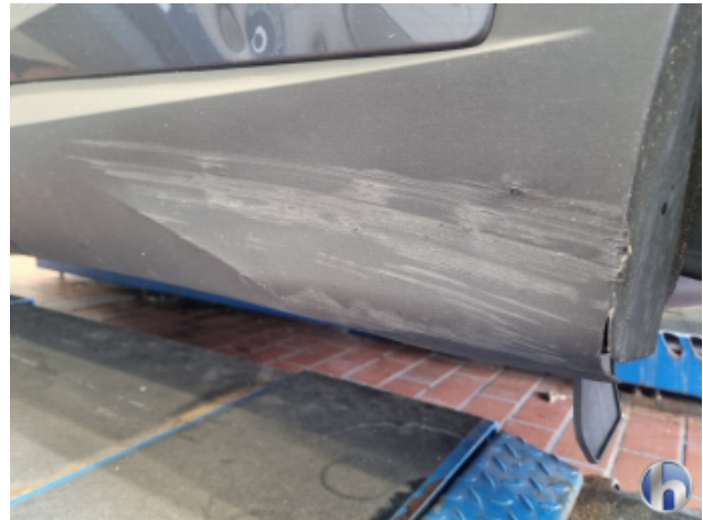
2. Tür Hinten - Links Beschädigt - Siehe Kalkulation
