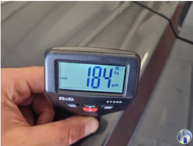
1. Seitenwand - Hinten - Rechts Nachlackiert - Ohne Reparatur
