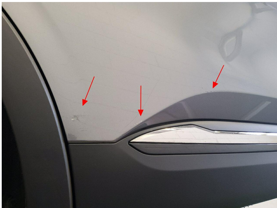
Bild 18 : Tür hinten rechts Lackierung, zerkratzt, smart repair
