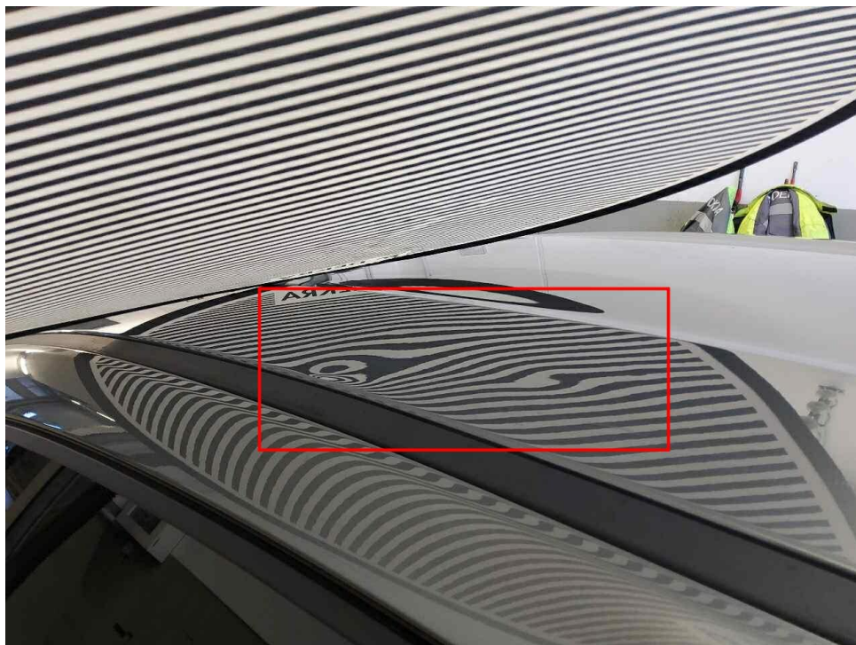
Bild 14 : Dach, mehrfach eingedellt, instandsetzen und lackieren mit Lackaufbau
