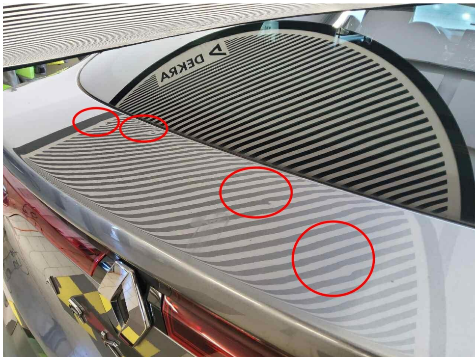
Bild 16 : Heckdeckel, mehrfach eingedellt, drücken
