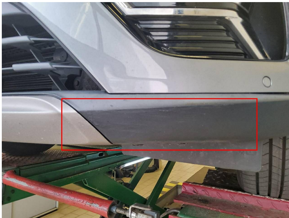
Bild 17 : Spoiler vorne links verschrammt
