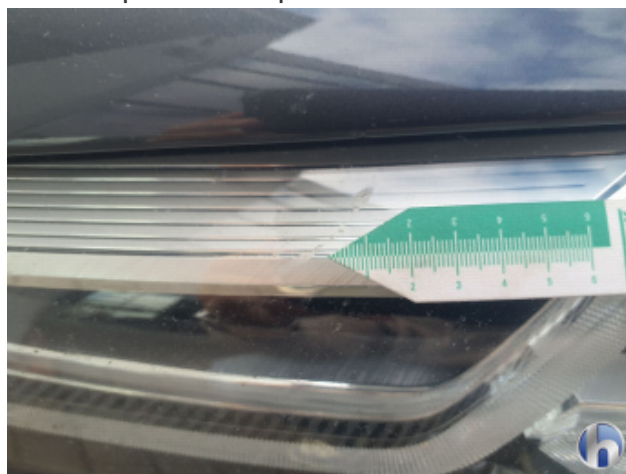
11. Scheinwerfer Halogen - Links Beschädigt - Erneuern
