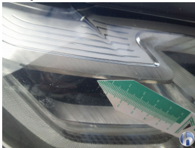
12. Scheinwerfer Halogen - Rechts Beschädigt - Erneuern
