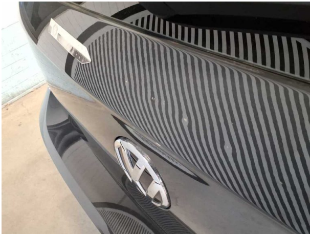
Beschädigung #8: Heckklappe/-tür: Heckklappe - Kratzer - instandsetzen und lackieren
