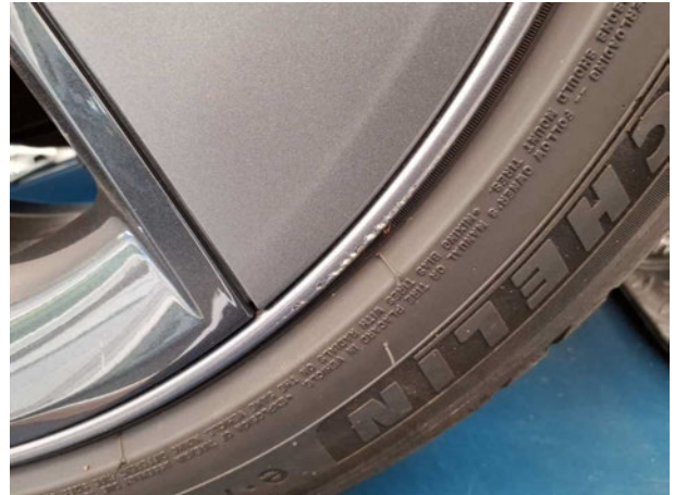
Beschädigung #3: Rad/Reifen: Leichtmetallfelge vorn rechts - Kratzer - Wertminderung
