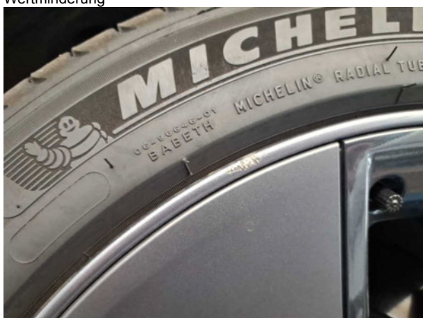
Beschädigung #2: Rad/Reifen: Leichtmetallfelge vorn links - Kratzer - Wertminderung
