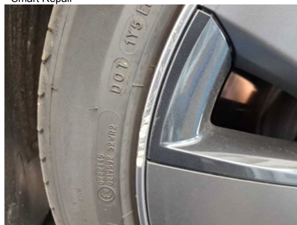
Beschädigung #2: Rad/Reifen: Leichtmetallfelge vorn links - Kratzer - Wertminderung
