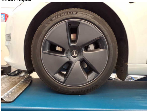
Beschädigung #2: Rad/Reifen: Leichtmetallfelge vorn links - Kratzer - Wertminderung
