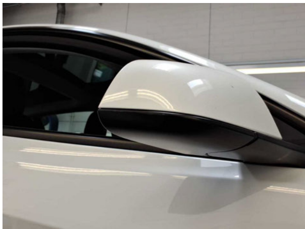
Beschädigung #1: Außenspiegel rechts: Spiegelgehäuse - Kratzer - Smart Repair
