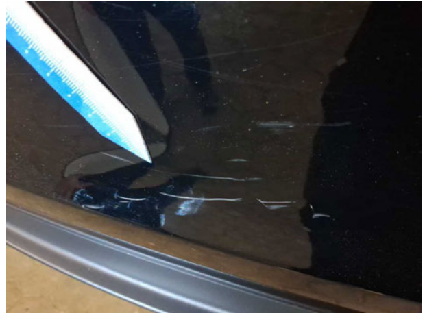
Beschädigung #4: Stossfänger hinten: Stossfänger hinten Mitte - verkratzt / verschürft - Smart Repair
