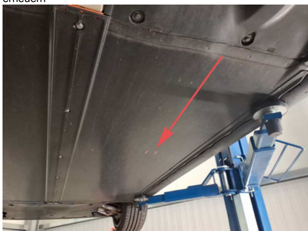
Beschädigung #10: Karosserie: Unterboden (Fahrzeug vermutlich aufgestzt. HV-Batterie prüfen.) - verkratzt / verschürft - Diagnose
