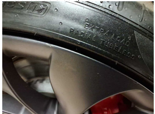
Beschädigung #6: Rad/Reifen: Leichtmetallfelge hinten links - verkratzt / verschürft - Wertminderung
