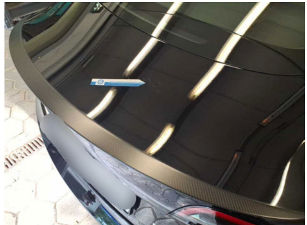
Beschädigung #2: Heckklappe/-tür: Heckklappe - Kratzer - auslegen / polieren
