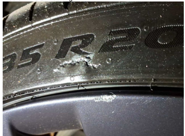
Beschädigung #8: Rad/Reifen: Leichtmetallfelge vorn links - Kratzer - Wertminderung
