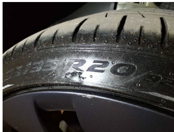
Beschädigung #9: Rad/Reifen: Reifen vorn links - beschädigt - erneuern
