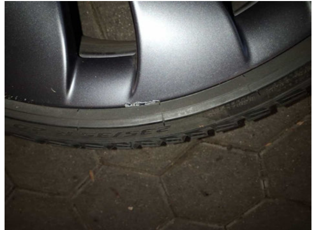
Beschädigung #12: 2.Radsatz: 2 Leichtmetallfelgen - verkratzt / verschürft - Wertminderung
