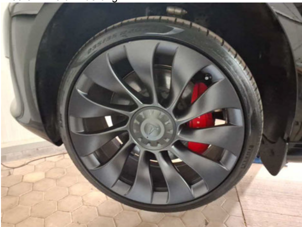
Beschädigung #8: Rad/Reifen: Leichtmetallfelge vorn links - Kratzer - Wertminderung
