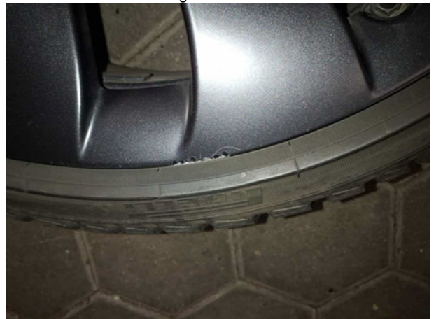
Beschädigung #12: 2.Radsatz: 2 Leichtmetallfelgen - verkratzt / verschürft - Wertminderung
