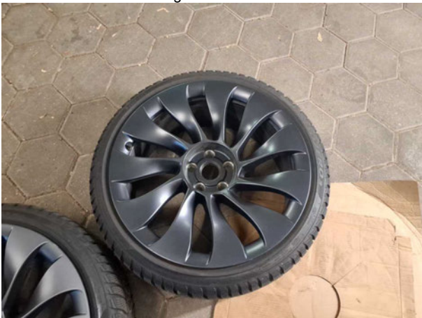
Beschädigung #12: 2.Radsatz: 2 Leichtmetallfelgen - verkratzt / verschürft - Wertminderung
