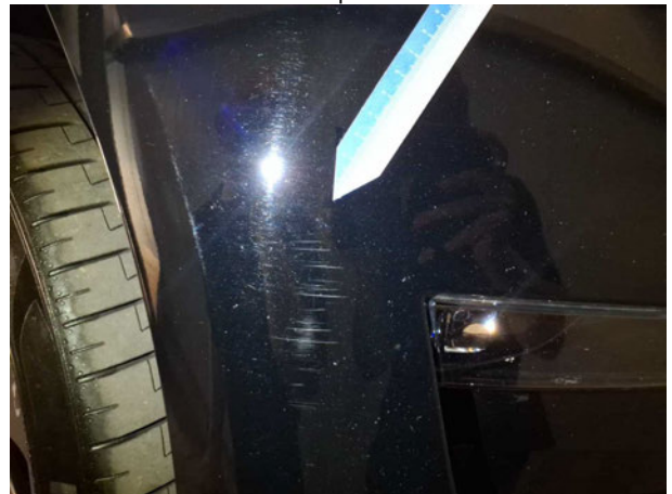
Beschädigung #5: Stossfänger vorn: Stossfänger vorn rechts - verkratzt / verschürft - Smart Repair
