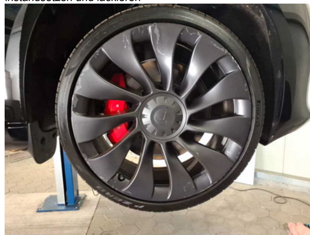
Beschädigung #15: Rad/Reifen: Leichtmetallfelge vorn rechts - verkratzt / verschürft - erneuern
