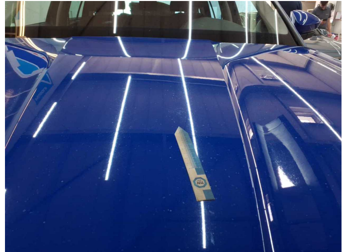
Damage 3: Bonnet: Bonnet (Verätzungen) - Paint defect - Paint
