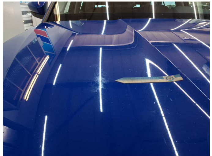
Damage 3: Bonnet: Bonnet (Verätzungen) - Paint defect - Paint
