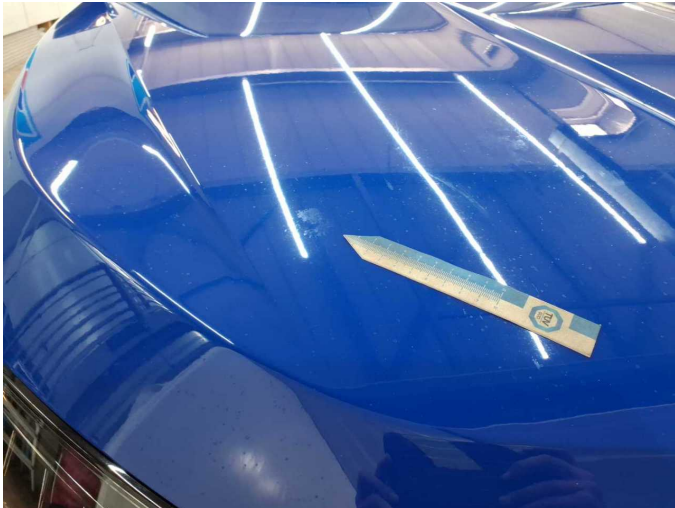
Damage 3: Bonnet: Bonnet (Verätzungen) - Paint defect - Paint
