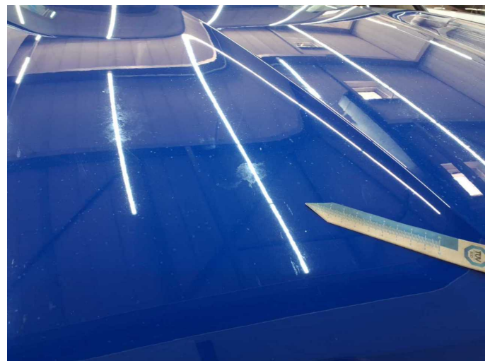
Damage 3: Bonnet: Bonnet (Verätzungen) - Paint defect - Paint
