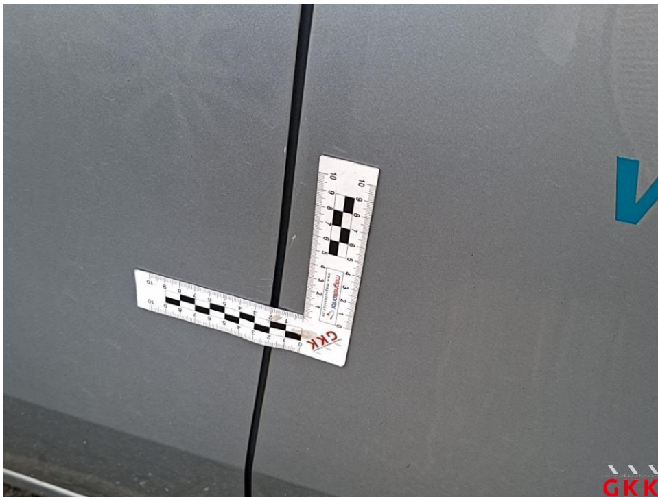
Bild 26. Schiebetür links, verkratzt, Smartrepair
