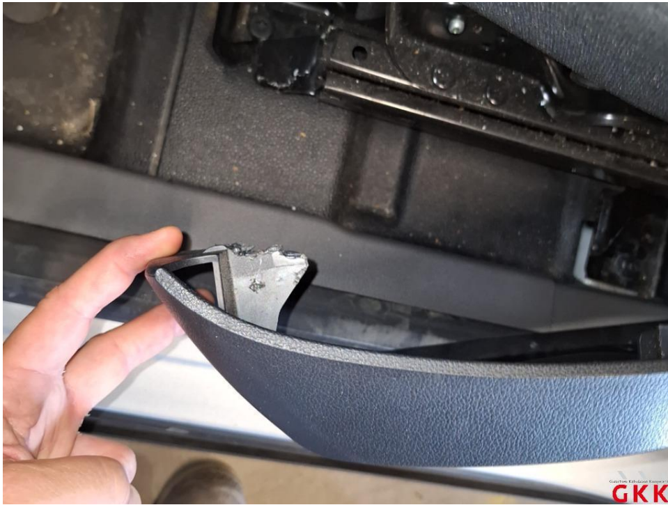
Bild 23 Sitz vorne links, Verkleidung, beschädigt, ersetzen
