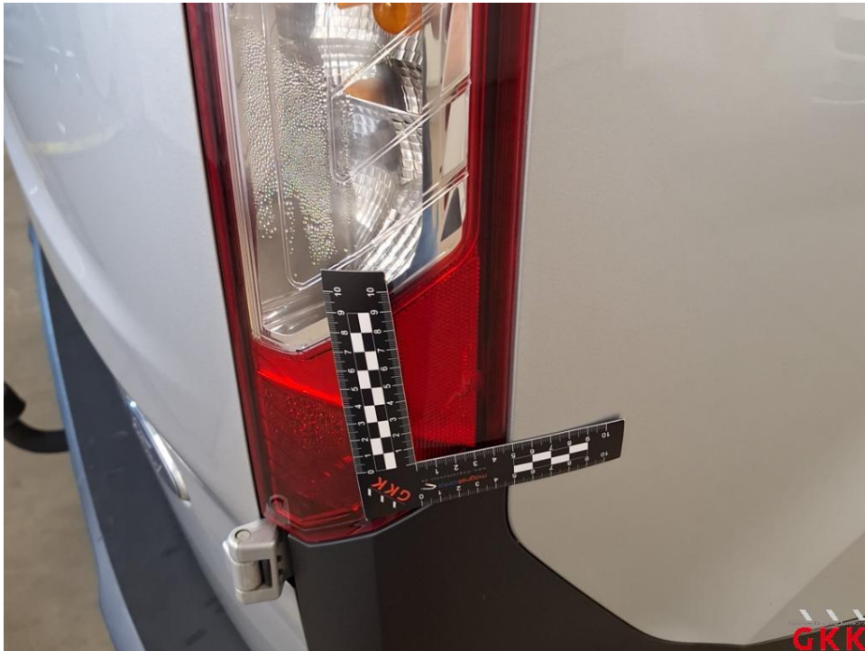
Bild 17 Rückleuchte rechts, Glas, gerissen, ersetzen
