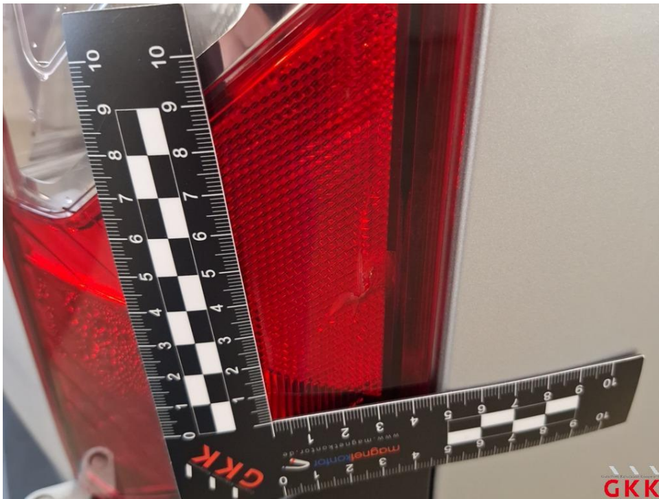
Bild 18 Rückleuchte rechts, Glas, gerissen, ersetzen
