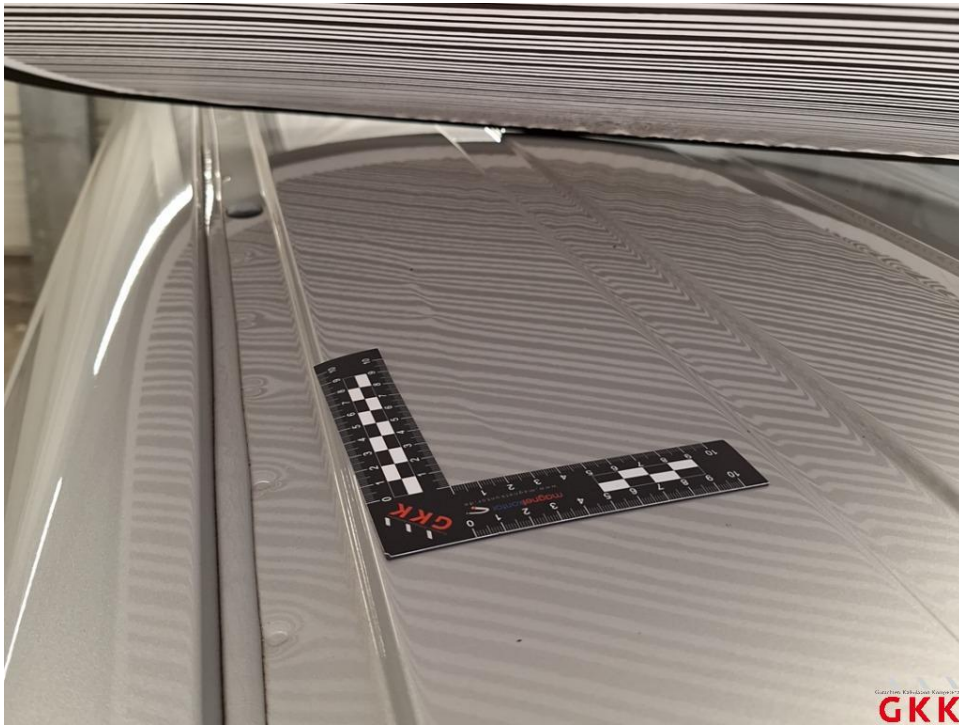
Bild 16 Dach, beschädigt, instand setzen - lackieren
