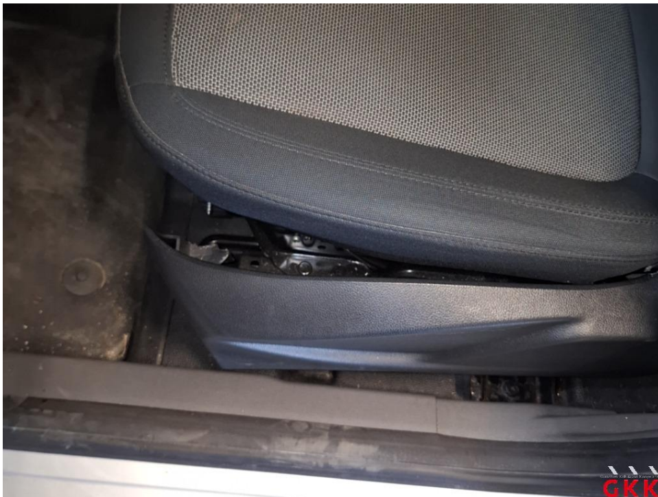
Bild 22 Sitz vorne links, Verkleidung, beschädigt, ersetzen
