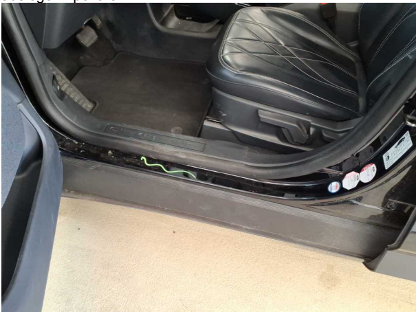
Beschädigung #5: Tür vorn links: Türdichtung - beschädigt - erneuern
