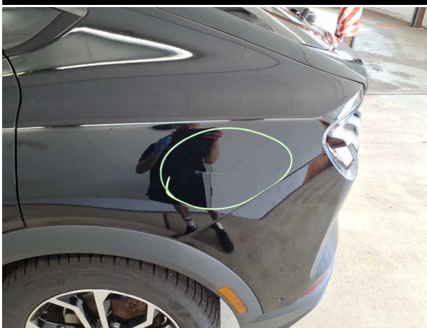
Beschädigung #9: Seitenwand links: Seitenwand - Delle / Lackschaden - instandsetzen und lackieren
