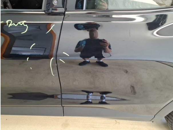
Beschädigung #3: Tür hinten links: Tür - Kratzer - auslegen / polieren
