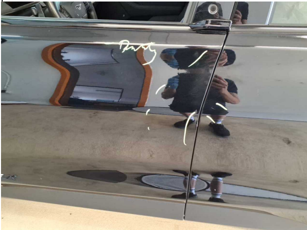
Beschädigung #4: Tür vorn links: Tür - verkratzt / verschürft - auslegen / polieren
