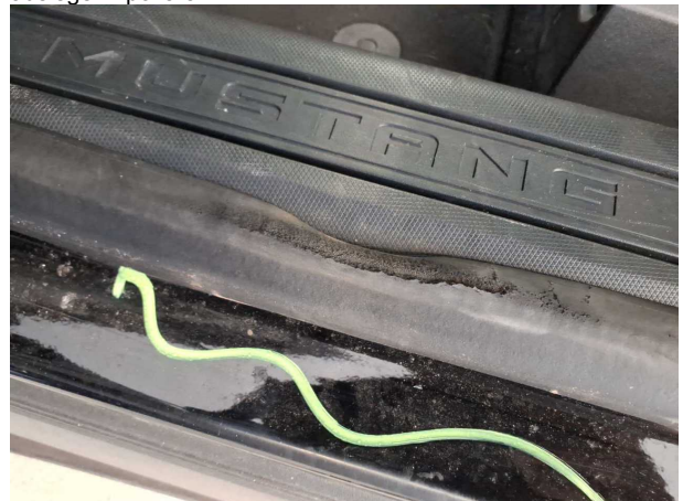
Beschädigung #5: Tür vorn links: Türdichtung - beschädigt - erneuern
