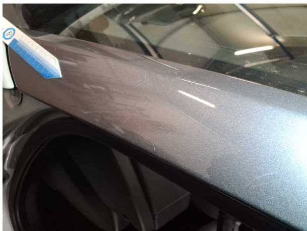
Beschädigung #2: Fahrzeugdach: Dachholm links - verkrazt / verschürft - Smart Repair
