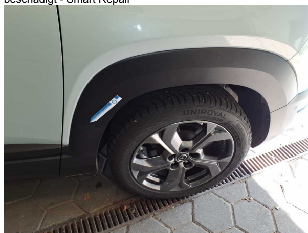
Beschädigung #11: Seitenwand links: Radhausverbreiterung - verkratzt / verschürft - erneuern
