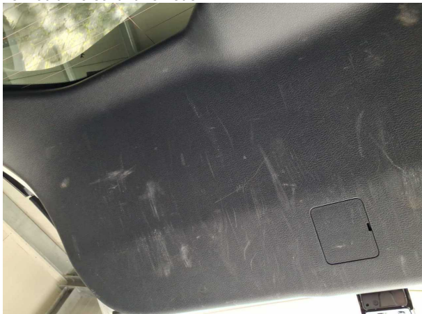
Beschädigung #12: Verkleidungen/Abdeckungen: Heckdeckel, Innenverkleidung - verkratzt / verschürft - erneuern
