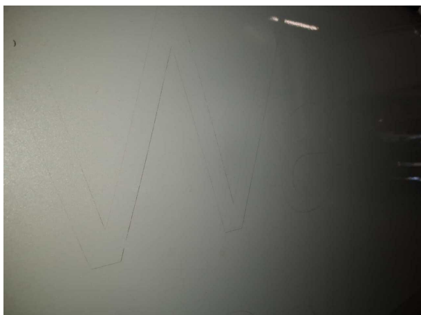
Beschädigung #5: Karosserie: Karosserie (Klebereste) - beklebt/ beschriftet - entkleben/neutralisieren
