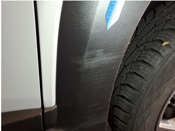
Beschädigung #11: Seitenwand links: Radhausverbreiterung - verkratzt / verschürft - erneuern
