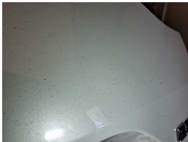
Beschädigung #5: Karosserie: Karosserie (Klebereste) - beklebt/ beschriftet - entkleben/neutralisieren
