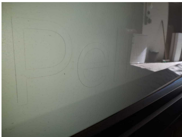
Beschädigung #5: Karosserie: Karosserie (Klebereste) - beklebt/ beschriftet - entkleben/neutralisieren
