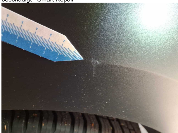
Beschädigung #11: Seitenwand links: Radhausverbreiterung - verkratzt / verschürft - erneuern
