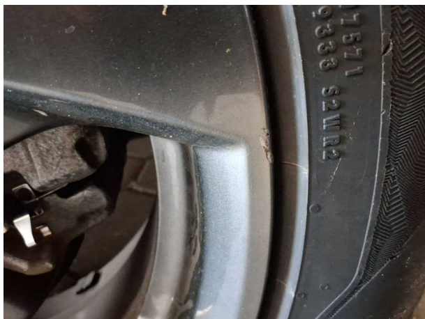
Beschädigung #9: Rad/Reifen: Leichtmetallfelge vorn rechts - verkratzt / verschürft - Smart Repair
