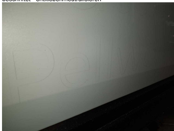
Beschädigung #5: Karosserie: Karosserie (Klebereste) - beklebt/ beschriftet - entkleben/neutralisieren
