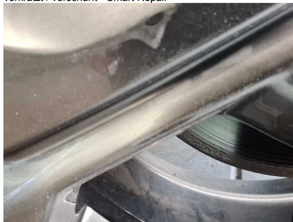
Beschädigung #8: Rad/Reifen: Leichtmetallfelge hinten links - verkratzt / verschürft - Smart Repair
