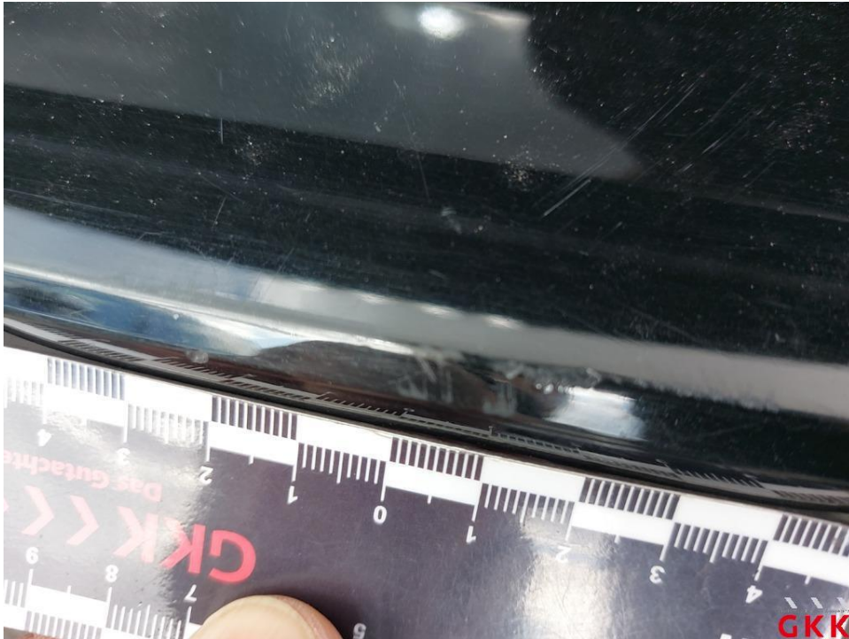
Bild 17. Stoßfänger hinten, Verkleidung -lackiert-, verkratzt, Smartrepair
