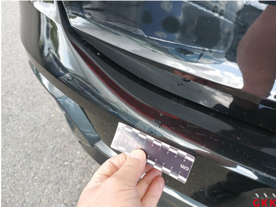
Bild 15. Stoßfänger hinten, Verkleidung -lackiert-, verkratzt, Smartrepair
