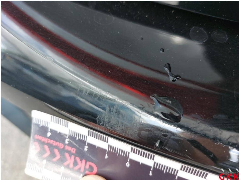
Bild 16. Stoßfänger hinten, Verkleidung -lackiert-, verkratzt, Smartrepair
