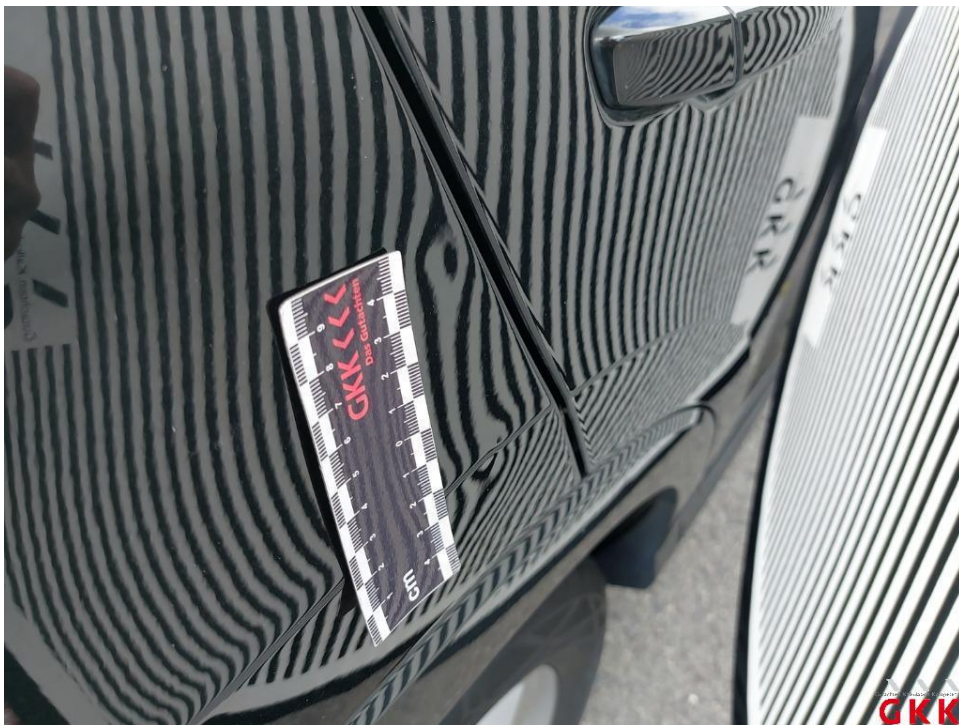
Bild 14. Seitenwand rechts, beschädigt, instand setzen - lackieren
