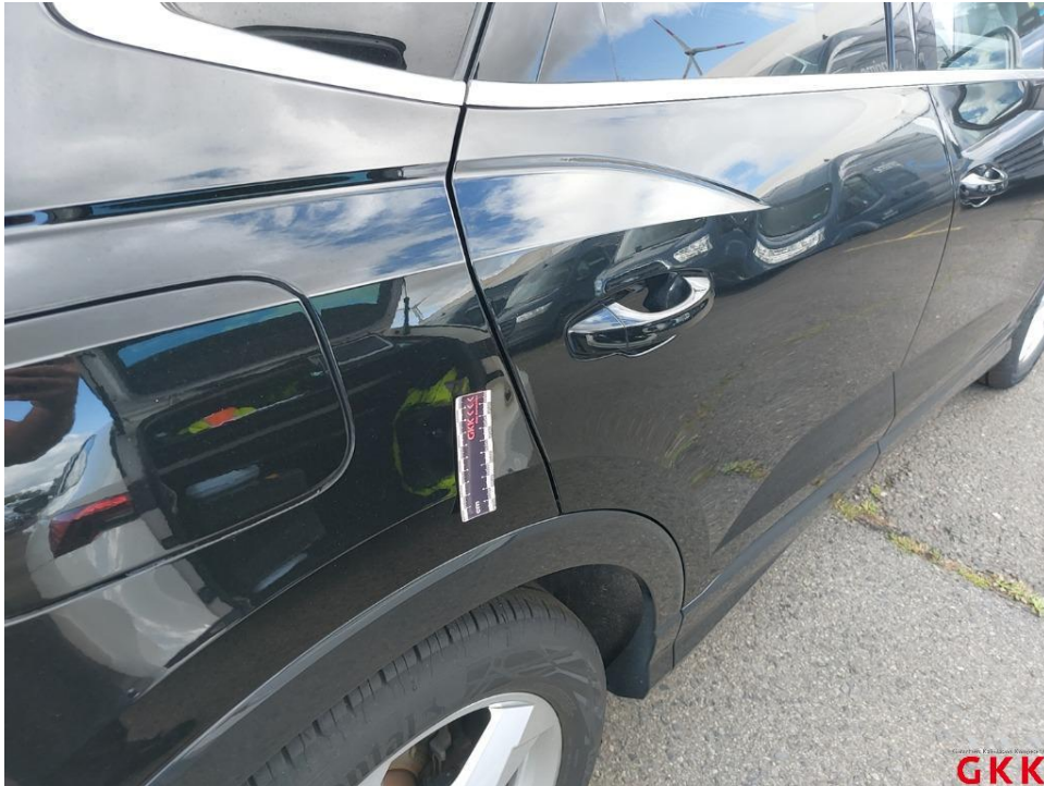
Bild 13. Seitenwand rechts, beschädigt, instand setzen - lackieren
