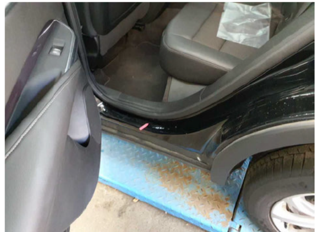
Beschädigung #3: Seitenwand links: Einstieg - Kratzer - Smart Repair
