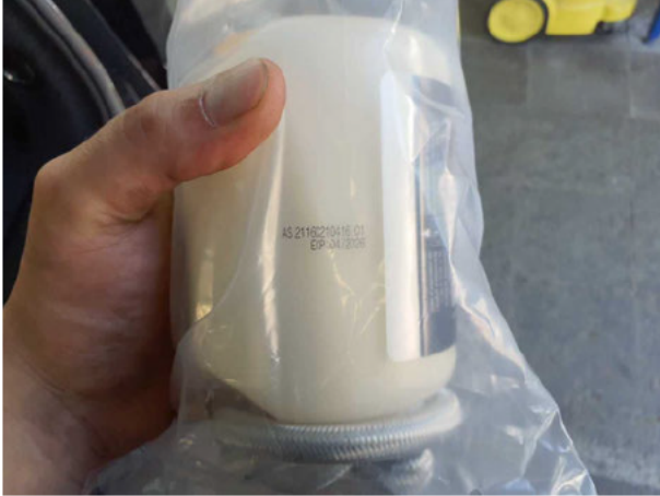
Beschädigung #1: Ausrüstung: Tirefit Füllmittel - abgelaufen - erneuern
