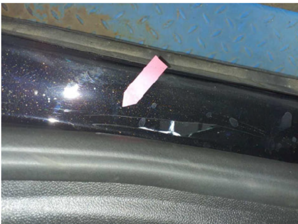
Beschädigung #3: Seitenwand links: Einstieg - Kratzer - Smart Repair
