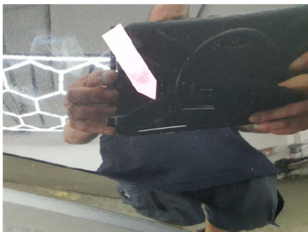
Beschädigung #4: Kotflügel rechts: Kotflügel rechts - Kratzer - lackieren
