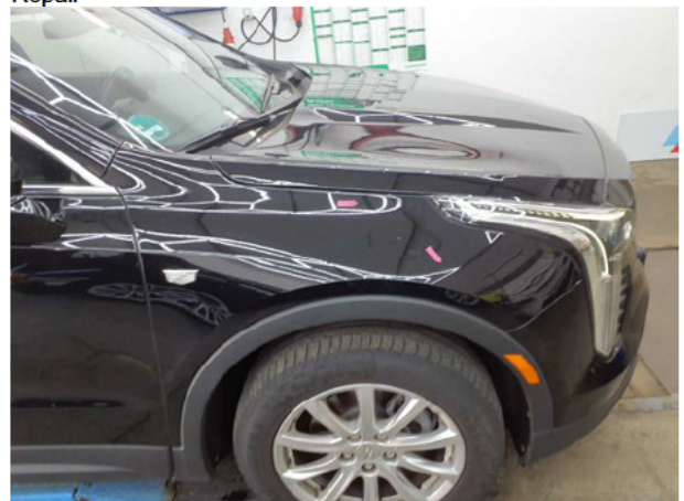
Beschädigung #4: Kotflügel rechts: Kotflügel rechts - Kratzer - lackieren
