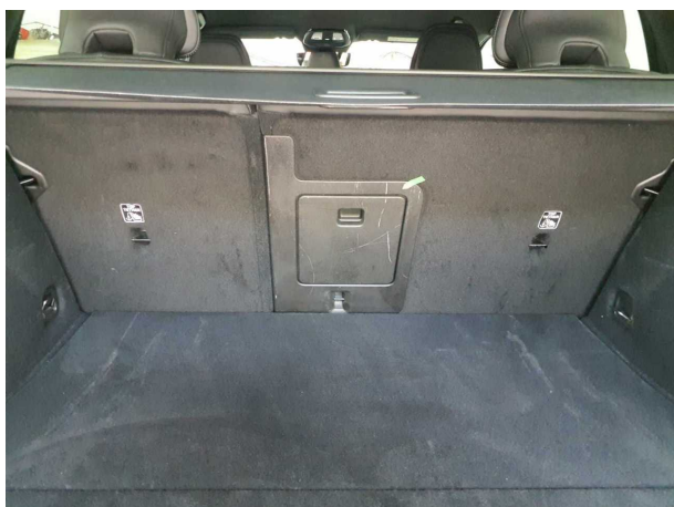
Beschädigung #3: Sitz hinten: Rücksitz (Ladeklappe) - Kratzer - erneuern
