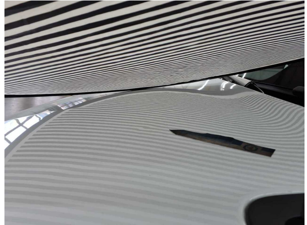
Beschädigung #9: Motorhaube: Motorhaube - Delle(n) - Smart Repair
