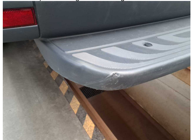
Beschädigung #14: Stossfänger hinten: Verkl. Stossfänger Auftritt mit Parktronic - verformt - erneuern
