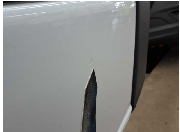
Beschädigung #13: Seitenwand links: Seitenwand (Bepankung unten hinten) - nicht fachgerecht instandgesetzt - instandsetzen/lackieren/
