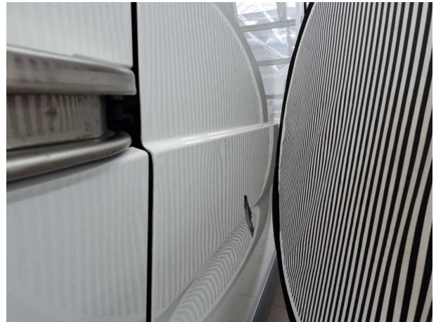
Beschädigung #5: Schiebetür rechts: Schiebetür - Delle(n) - Sm... Repair
