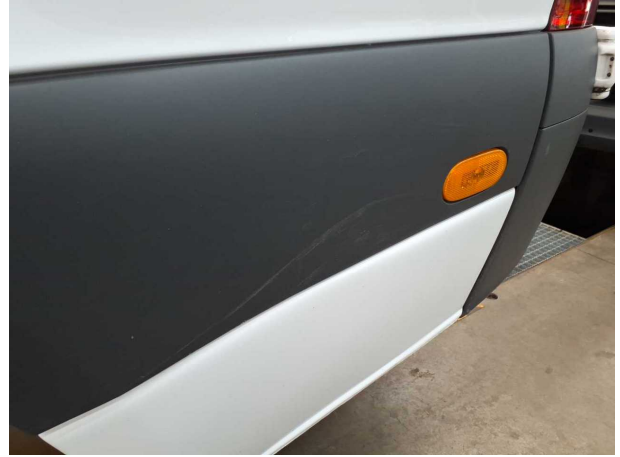
Beschädigung #2: Seitenwand links: Schutzleiste (Hinten) - verkratzt / verschürft - erneuern
