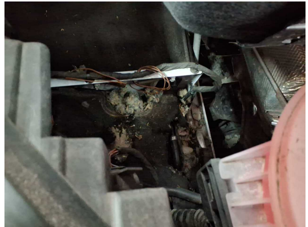
Beschädigung #4: Kotflügel rechts: Innenkotflügel - Marderschaden - erneuern
