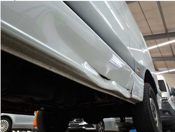
Beschädigung #18: Seitenwand links: Seitenwand (Beplankung unten vorne) - gebrochen / gerissen - erneuern
