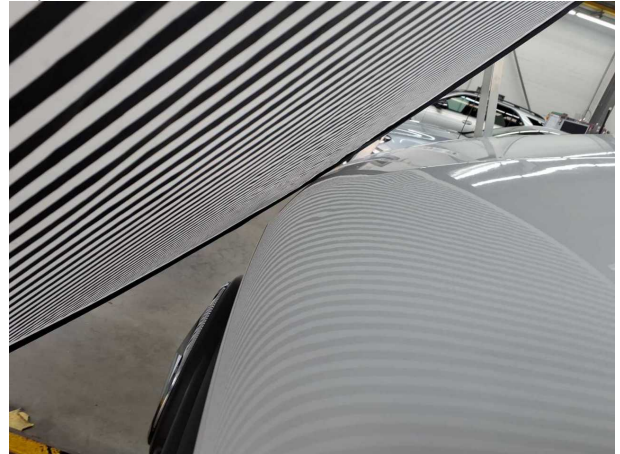
Beschädigung #9: Motorhaube: Motorhaube - Delle(n) - Smart Repair
