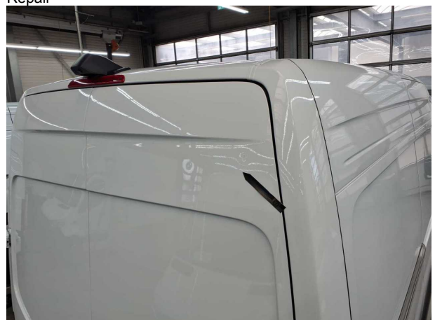
Beschädigung #10: Heckklappe/-tür: Hecktür rechts - Delle(n) - Smart Repair
