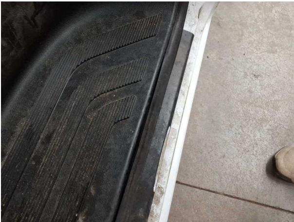
Beschädigung #3: Karosserie: Türdichtung vorn links - gebrochen / gerissen - erneuern
