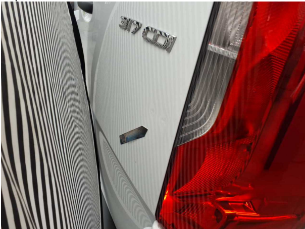
Beschädigung #10: Heckklappe/-tür: Hecktür rechts - Delle(n) - Smart Repair
