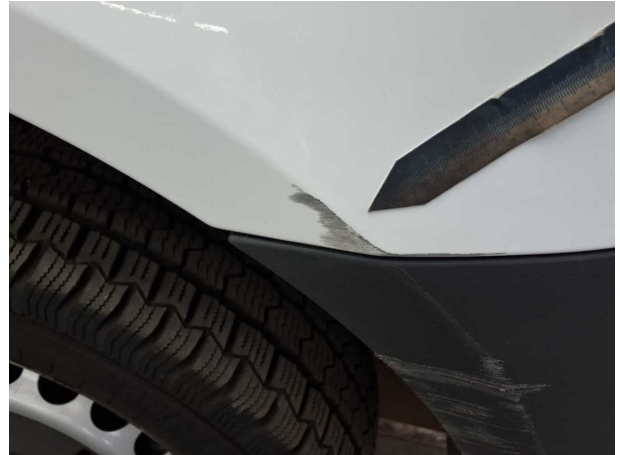
Beschädigung #12: Kotflügel rechts: Kotflügel rechts - verkratzt / verschürft - lackieren
