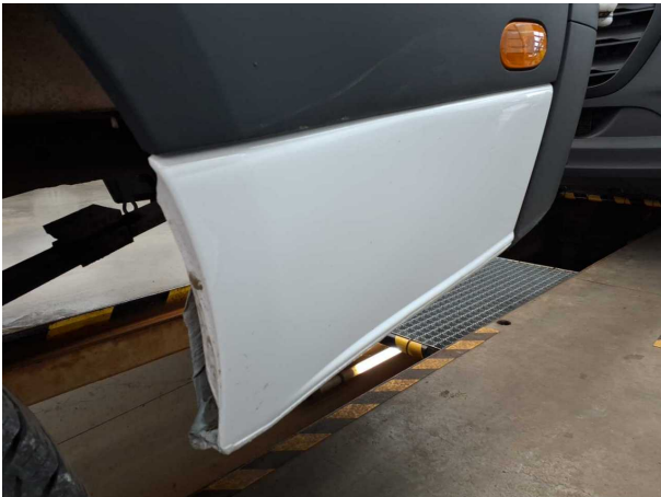
Beschädigung #13: Seitenwand links: Seitenwand (Bepankung unten hinten) - nicht fachgerecht instandgesetzt - instandsetzen/lackieren (S1)
