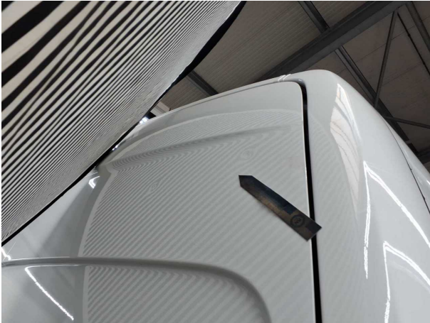
Beschädigung #10: Heckklappe/-tür: Hecktür rechts - Delle(n) - Smart Repair
