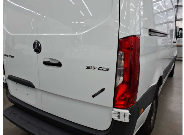
Beschädigung #10: Heckklappe/-tür: Hecktür rechts - Delle(n) - Smart Repair
