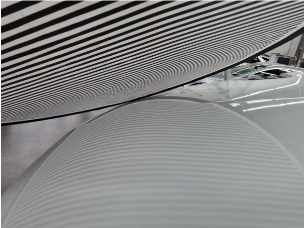
Beschädigung #9: Motorhaube: Motorhaube - Delle(n) - Smart Repair
