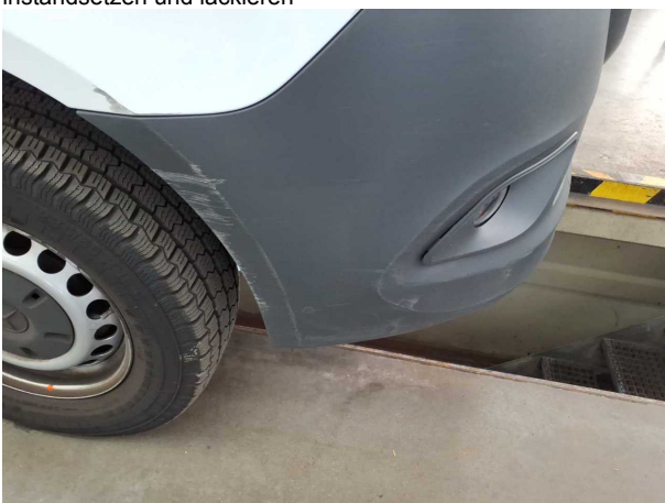
Beschädigung #16: Stossfänger vorn: Stossfänger mit Parktronic - verkratzt / verschürft - erneuern
