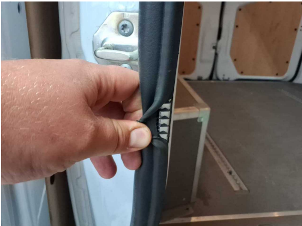
Beschädigung #7: Schiebetür rechts: Türdichtung - gebrochen / gerissen - erneuern
