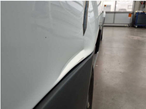
Beschädigung #15: Seitenwand rechts: Seitenwand - verformt - instandsetzen und lackieren
