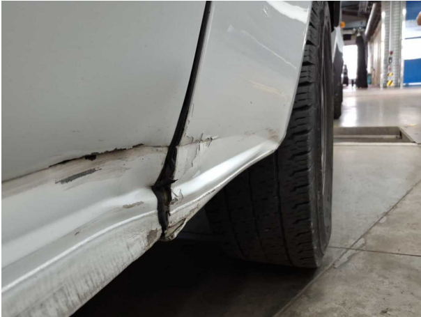
Beschädigung #17: Seitenwand links: Seitenwand (Beplankung unten mitte) - verformt - erneuern
