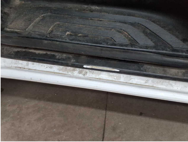
Beschädigung #1: Schweller links: Einstieg - verkratzt / verschürft - lackieren
