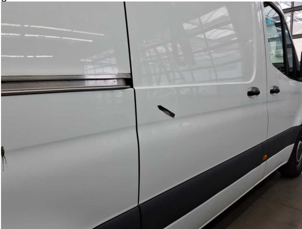
Beschädigung #5: Schiebetür rechts: Schiebetür - Delle(n) - Smart Repair
