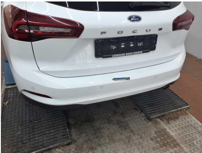
Damage 2: Rear bumper: Rear bumper (Verladebereich) - Scratch(es) - Smart repair
