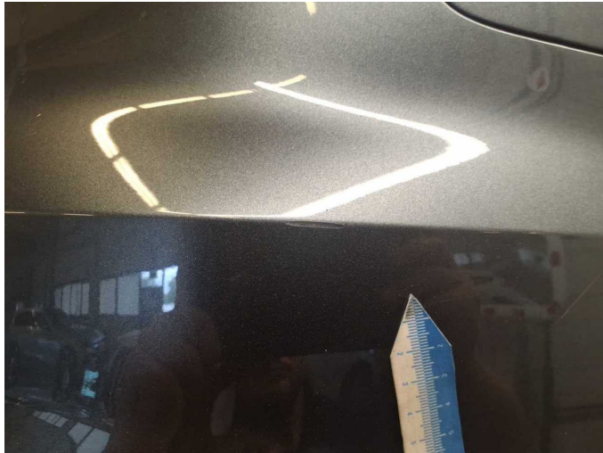
Damage 12: Rear bumper: Rear bumper (Fhzig. mit Sideassist) - Scratched - Replace
