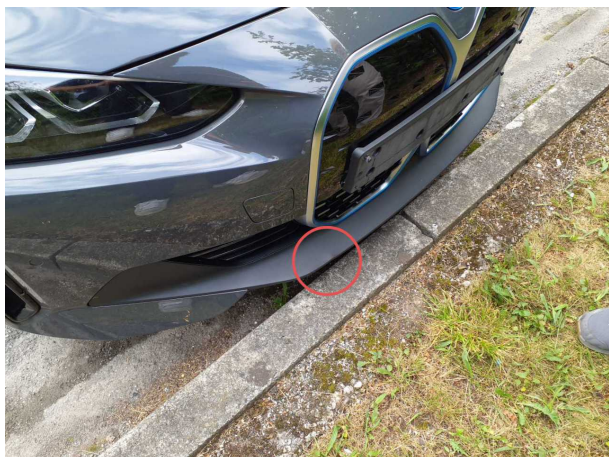
Beschädigung #5: Stossfänger vorn: Spoiler - verformt - erneuern
