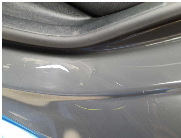
Beschädigung #4: Seitenwand links: Einstieg - Delle(n) - Smart Repair
