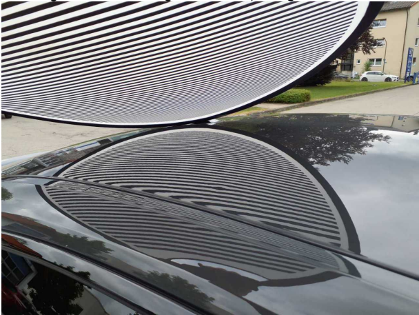
Beschädigung #6: Karosserie: Karosserie (Nicht fachgerecht Instandgesetzt. Rechnung vorhanden.) - Hagelschaden - sanft
