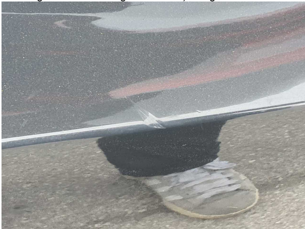
Beschädigung #7: Stossfänger hinten: Stossfänger hinten (Ladekante) - verkratzt / verschürft - instandsetzen und lackieren
