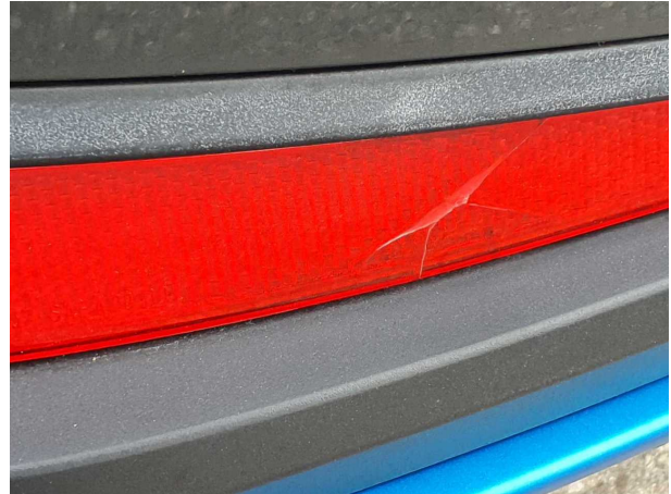
Beschädigung #1: Stossfänger hinten: Stossfänger hinten (Reflektor links) - gebrochen / gerissen - erneuern
