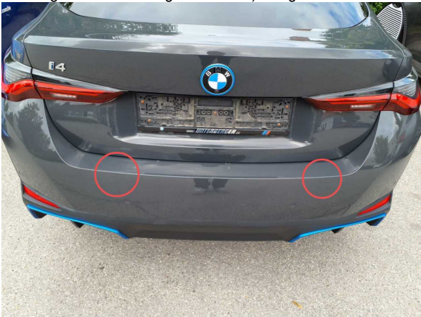
Beschädigung #7: Stossfänger hinten: Stossfänger hinten (Ladekant... - verkratzt / verschürft - instandsetzen und lackieren
