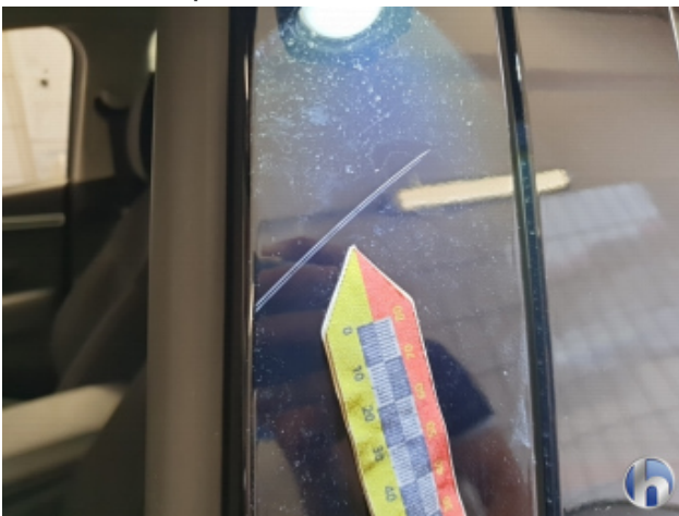
8. B-Säule Mitte - Links Beschädigt - Erneuern
