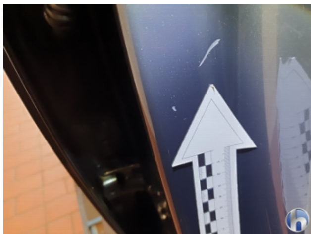
3. Türeinstieg Vorne - Rechts Kratzer - Smart Repair
