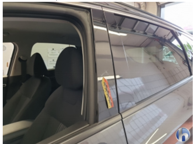
8. B-Säule Mitte - Links Beschädigt - Erneuern
