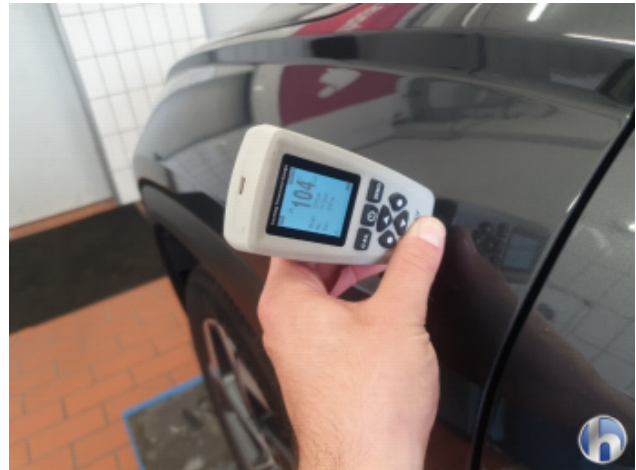
1. Kotflügel Vorne - Links Nachlackiert - Ohne Reparatur
