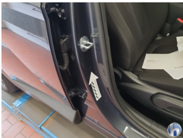
3. Türeinstieg Vorne - Rechts Kratzer - Smart Repair
