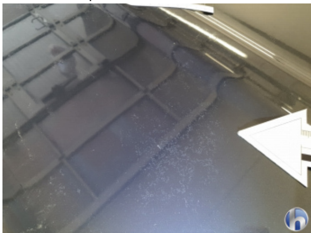
4. Dach Lackabplatzer - Lackieren
