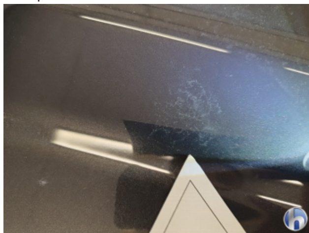
4. Dach Lackabplatzer - Lackieren
