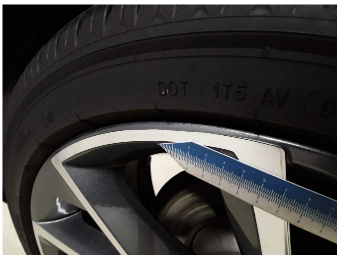
Damage 7: Wheel / tyres: Alloy rim - rear right side (Wurde bearbeitet) - Unprofessionally repaired - Replace
