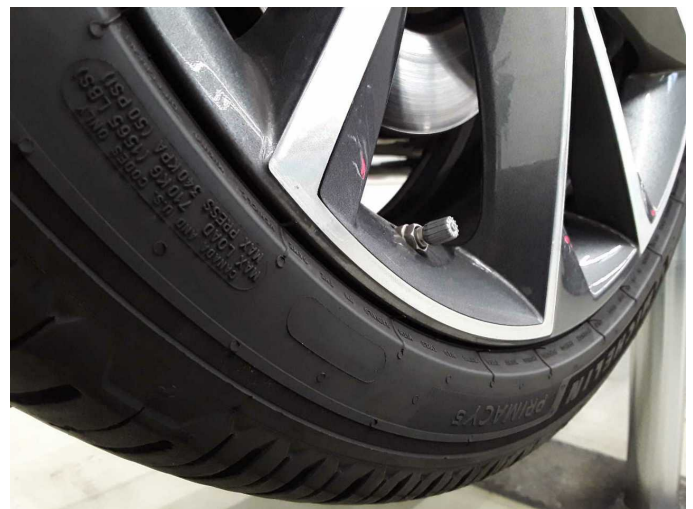
Damage 8: Wheel / tyres: Alloy rim - front left side (Wurde bearbeitet) - Unprofessionally repaired - Replace
