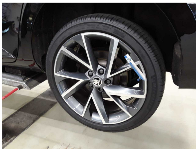
Damage 6: Wheel / tyres: Alloy rim - rear left side (Wurde bearbeitet) - Unprofessionally repaired - Replace
