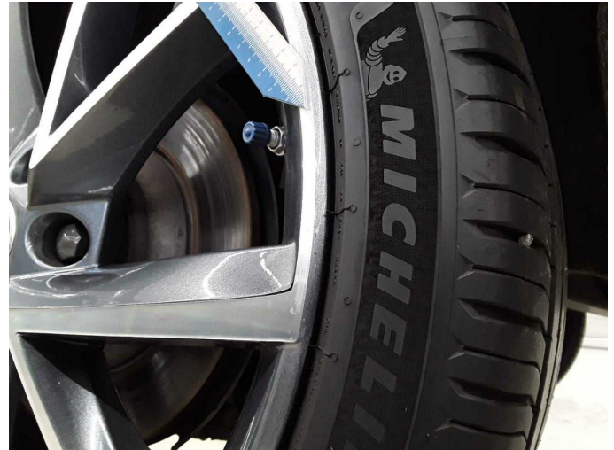
Damage 6: Wheel / tyres: Alloy rim - rear left side (Wurde bearbeitet) - Unprofessionally repaired - Replace
