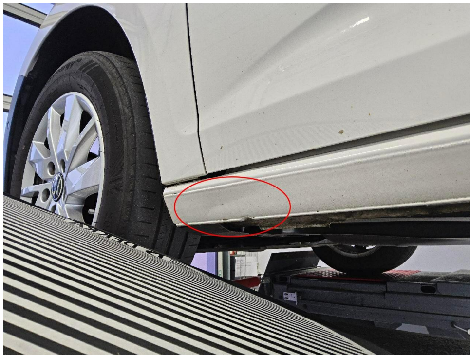
Bild 11 : Schweller vorne links eingedellt
