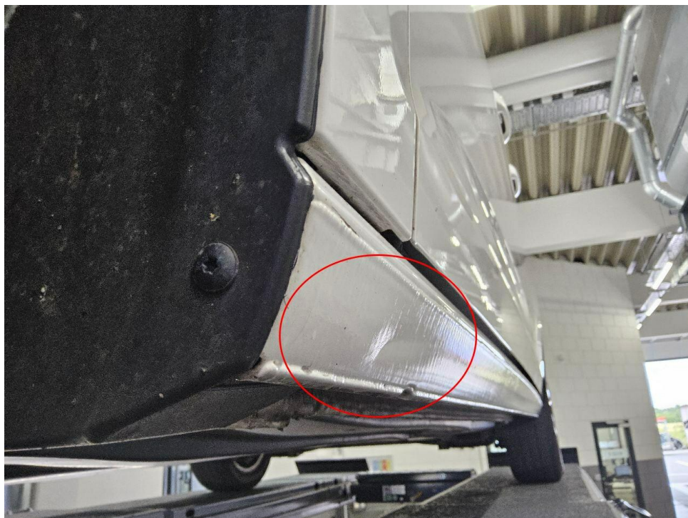
Bild 12 : Schweller vorne links eingedellt
