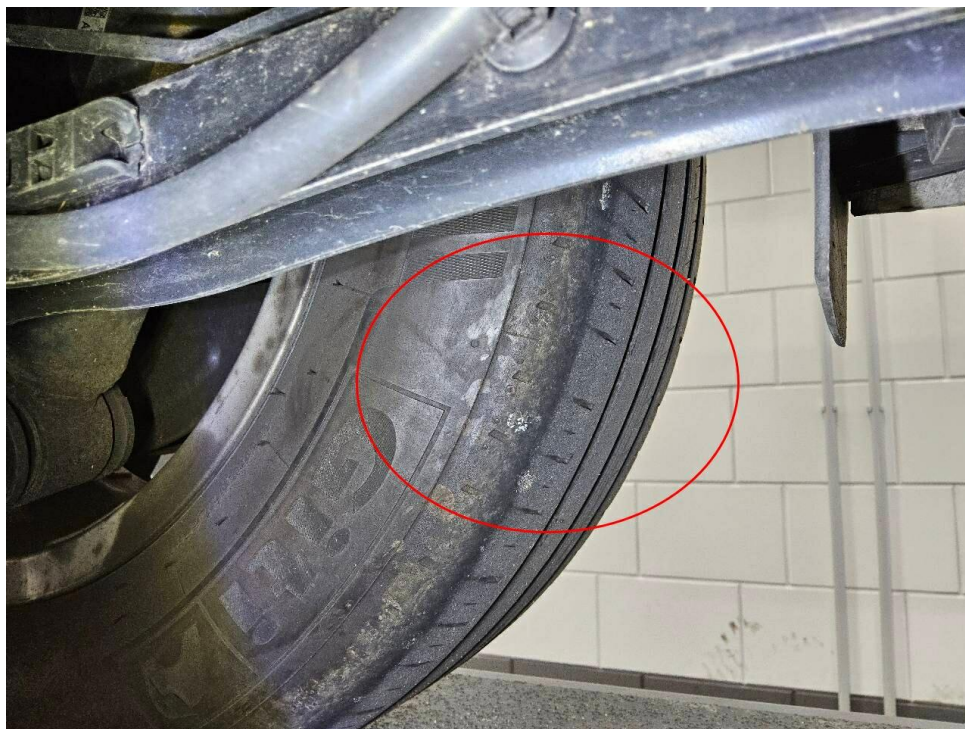
Bild 9 : Reifen Hinterachse innen abgefahren
