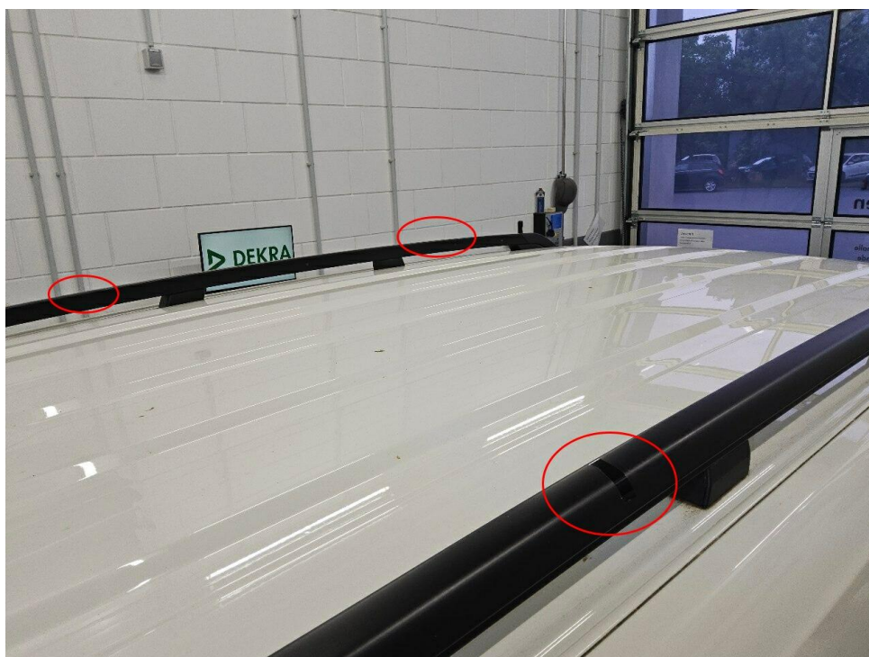
Bild 8 : Dachrehling rechts und links Klebereste entfernen
