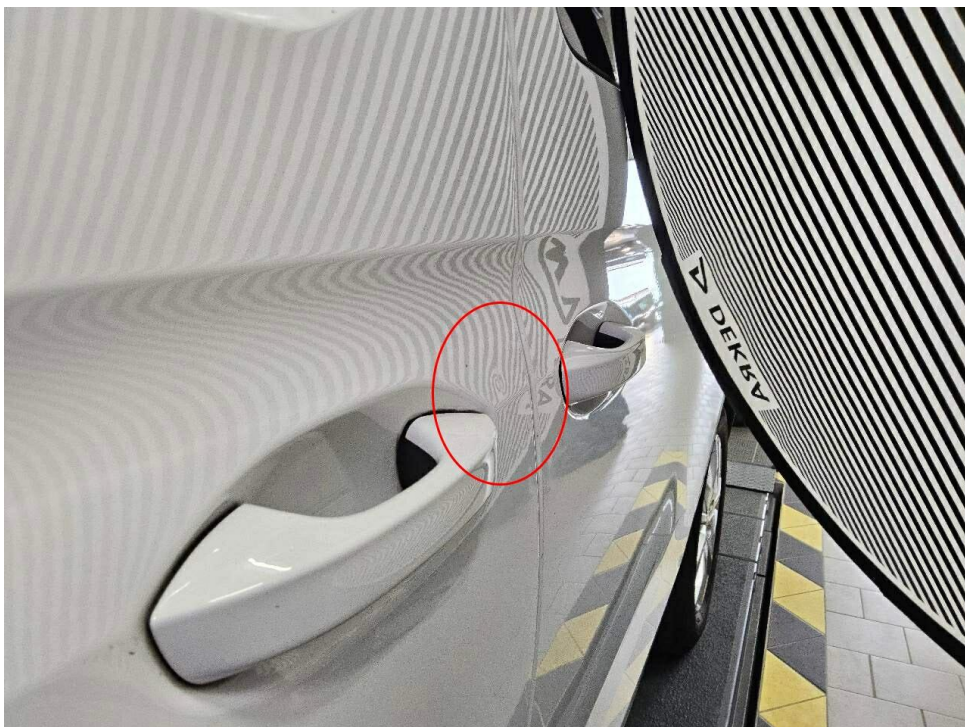
Bild 14 : Türe vorne links eingedellt
