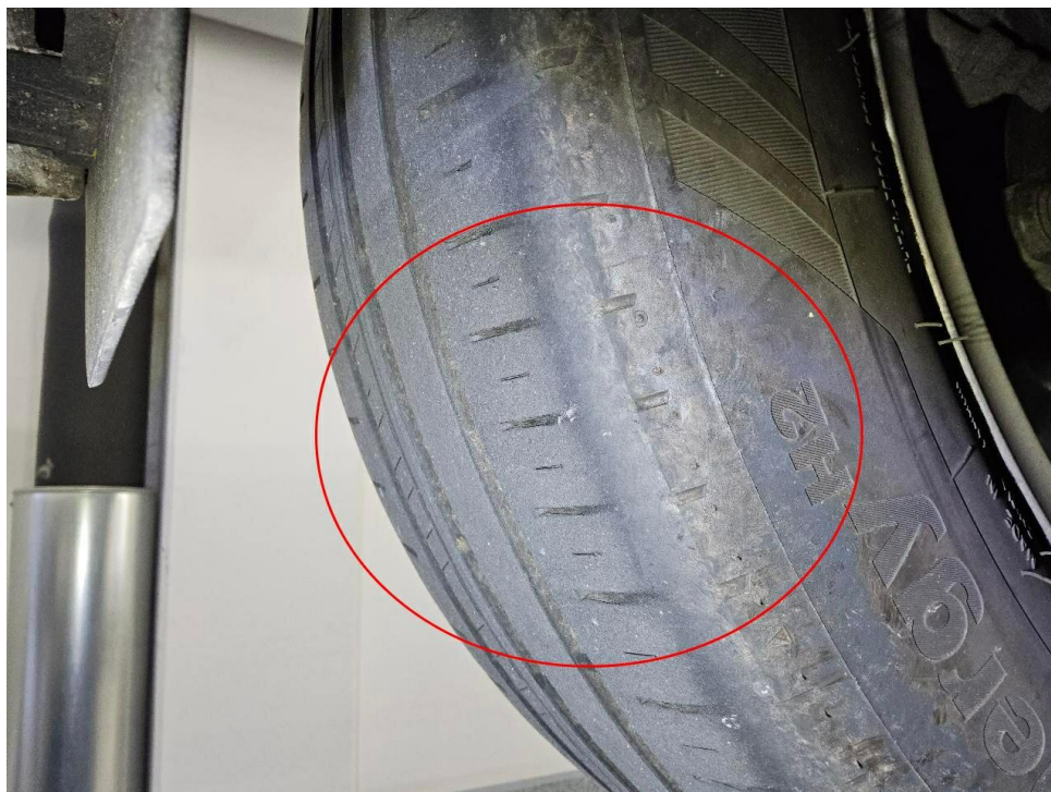
Bild 10 : Reifen Hinterachse innen abgefahren
